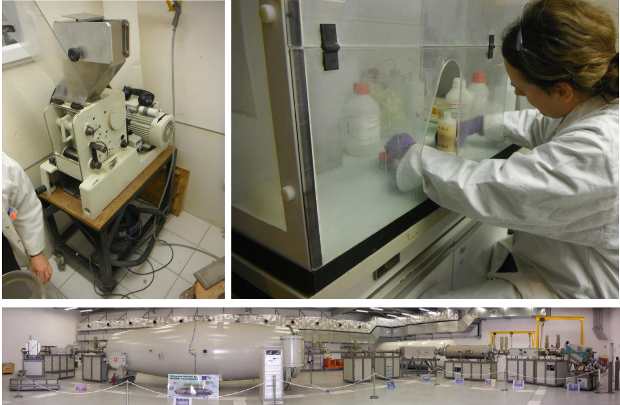
Şekil 3.3. Hızlandırılmış Kütle Spektrometresi (AMS, Accelerator Mass Spectrometry) analiz laboratuvarları. CEREGE (Centre Européen de Recherche et d'Enseignement des Géosciences de l'Environnement) bünyesinde bulunan ASTER (Accélérateur pour les Sciences de la Terre, Environnement et Risques) olanağı, Aix-En Provence, Fransa.
