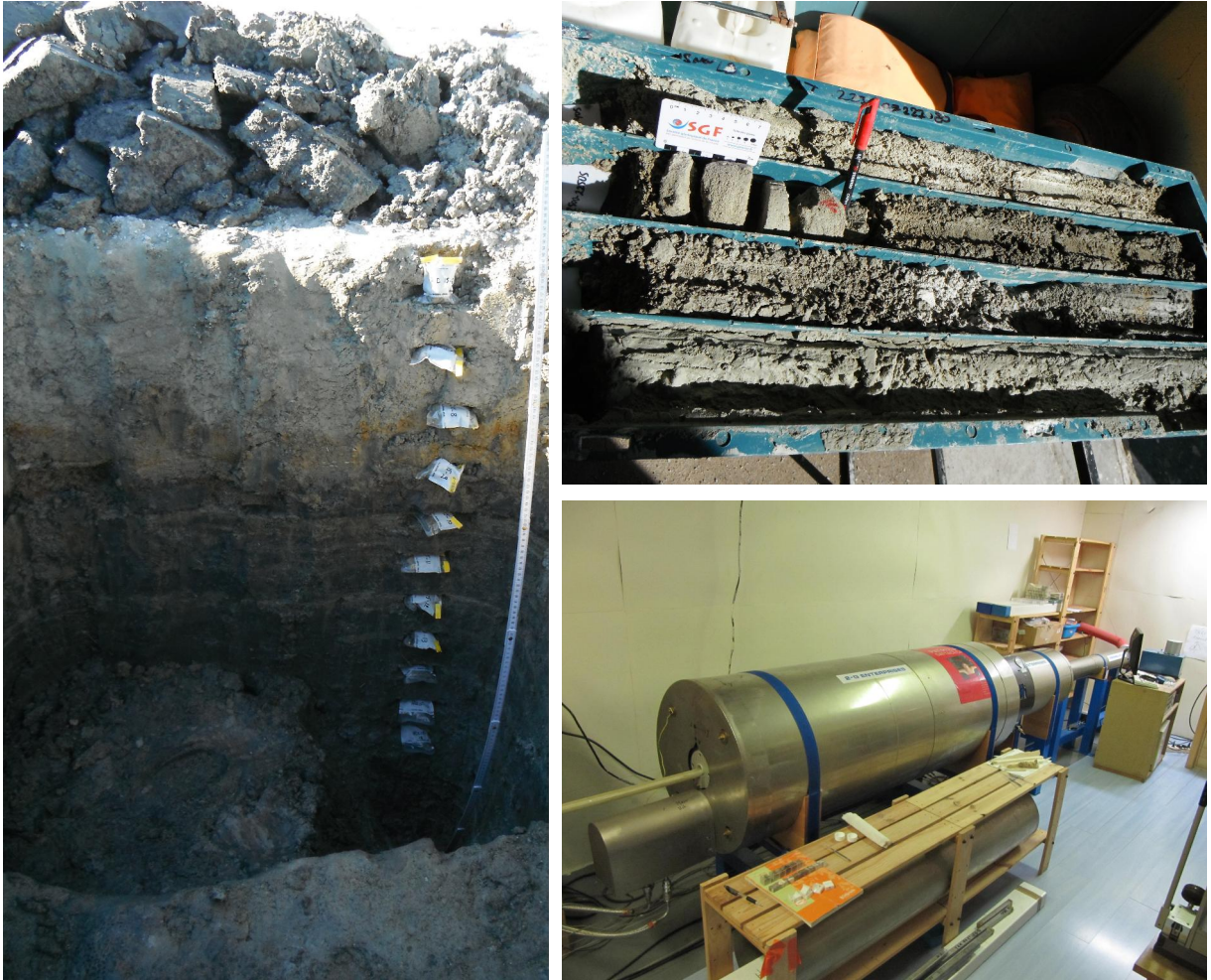
Şekil 3.1. Paleomanyetik örnekleme ve ölçüm aşamaları; 1) Güncel ve güncel yakın radyasyon düzeyi ile kalibrasyon amacı ile kuru mevsimde kazı çukurlarından örnekleme, 2) Doğrudan çalışma konusu edilen 601 m'lik sondaj karotundan yapılan örneklemeyle ilgili bir görüntü, 3) Paleomanyetik yönelimin yerinde ölçümü için karot boyuca alınan ve laboratuvarda küp ve silindirik şekilde biçimlendirilmiş örneklerin CEREGE ( Centre Européen de Recherche et d'Enseignement des Géosciences de l'Environnement ) Europôle de l'Arbois laboratuvarlarında bulunan paleomanyetik ölçüm cihazı ve düzeniğin görünümü.
