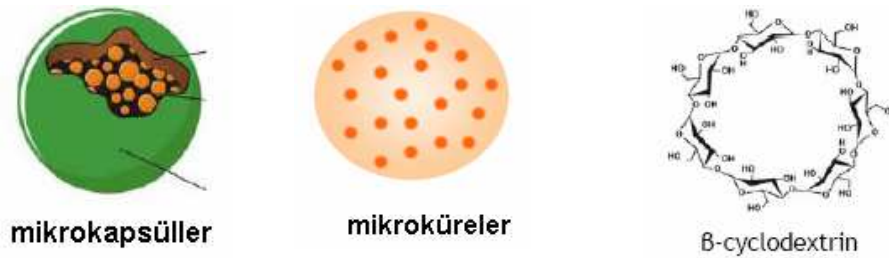
Şekil 4 Kontrollü aktarma sistemleri
