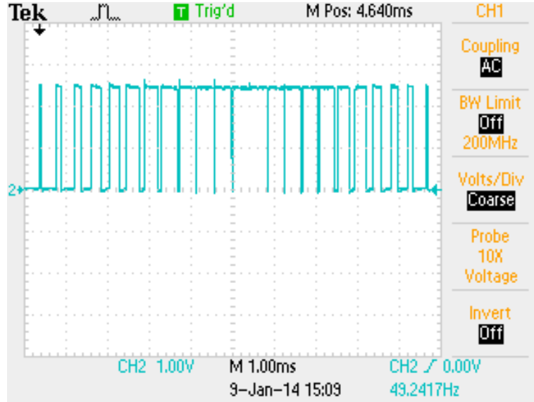
Şekil 4.1: Rezistif yükte üst kollara ait donanımsal SPWM sinyali
