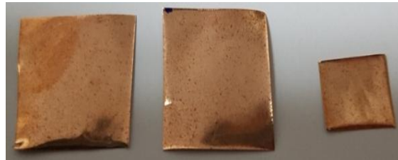
Şekil 30. CVD yöntemiyle grafen kaplanmış farklı boyutlardaki Cu folyolar.
