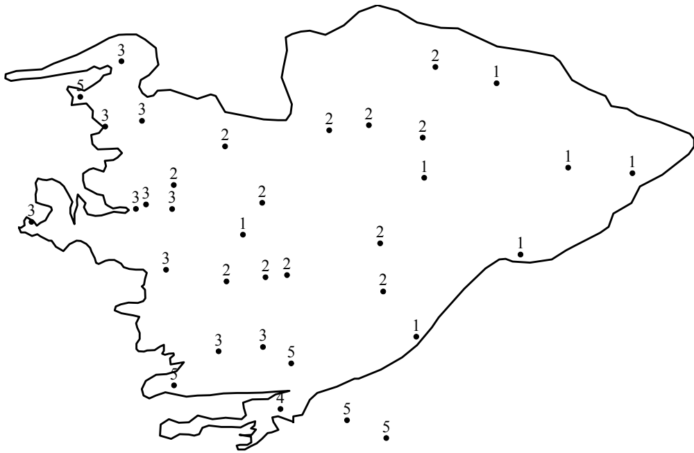
Şekil B.50. Bulanık c-Ortalamalar yöntemi ile t=240 dak., c=5 için kümeleme analizi sonuçları
