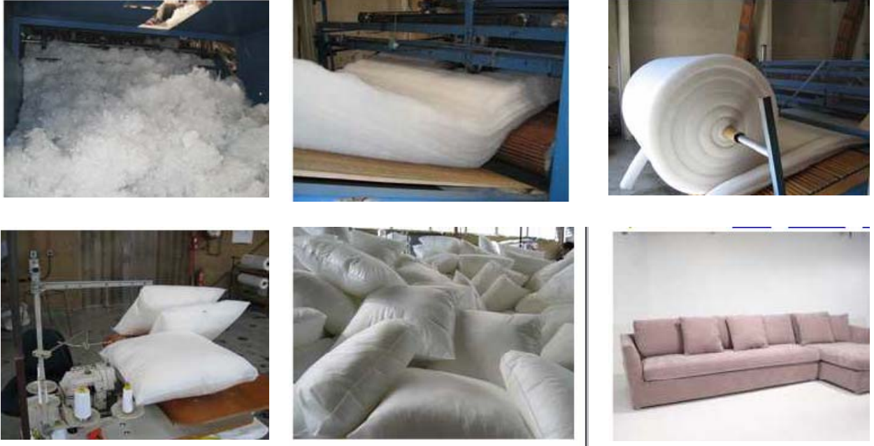
Şekil 59. Beyaz renkli açılmış elyafın ambalaj malzemesi ve dolgu malzemesi olarak kullanımı
