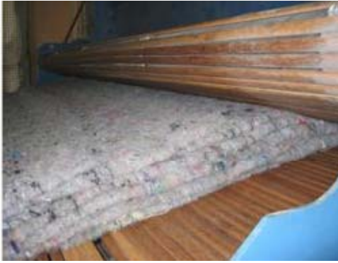
Şekil 57. Açılan elyafın keçe yüzey olarak üretimi
