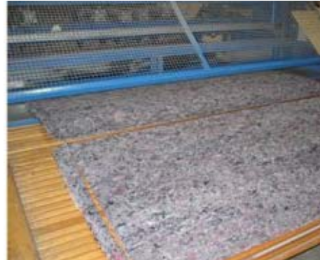
Şekil 57. Açılan elyafın keçe yüzey olarak üretimi
