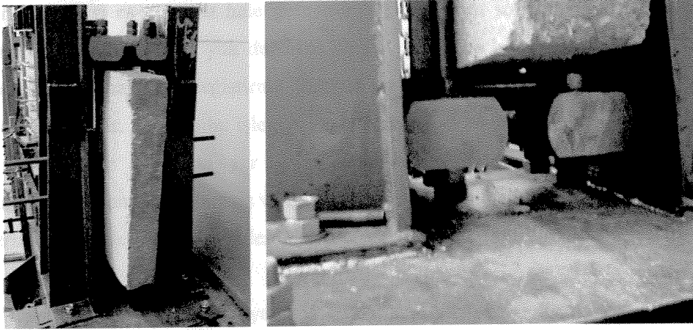
Şekil 3.9: Mesnetlerde itme ve çekmeye karşı hareketin önlenmesi
