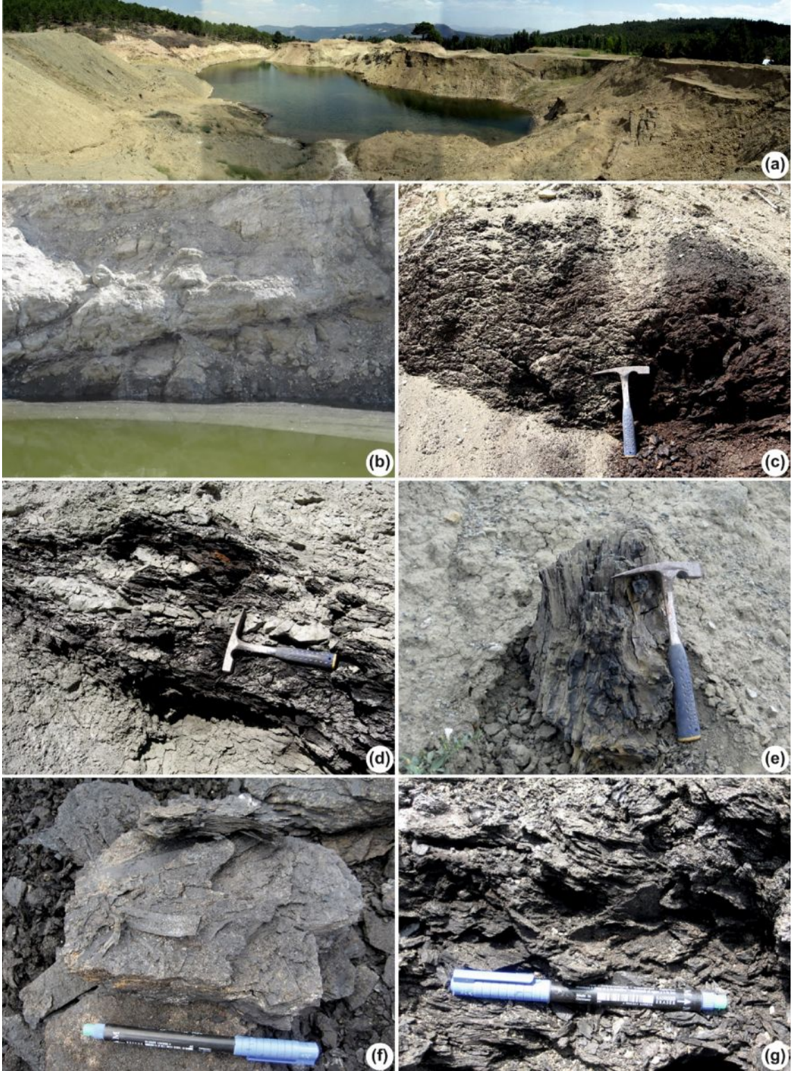
Şekil 4.14. a ve b) Kocapınar-Ocak lokalitesinde açık işletme yöntemiyle üretim yapılan kömür ocağı (GPS Koordinatı: 35 S 0705971 ; 4172166) (a ve b için bakış yönleri güneydoğu'ya) c, d ve g) koyu kahve-siyah renkli, laminalı yapıya sahip kömür oluşumları (c için bakış yönü kuzeydoğu'ya) e ve f) odunsu bileşenlerin görüldüğü kömür örnekleri.
