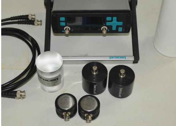
Şekil 2. Bu çalışmada kullanılan Proceq Pundit Lab+ ultrasonik dalga hız ölçüm cihazı ve P (54 kHz) ve S (250 kHz) dalga transdüserleri. (Proceq Pundit Lab+ ultrasonic test device and its P (54 kHz) and S (250 kHz) wave transducers used in this study)
