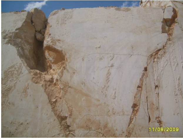
Şekil 20. Ocak içindeki verev açılma çatlaklarından görünüm.
