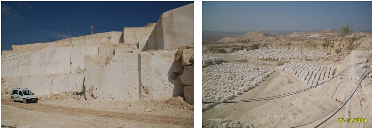
Şekil 96. Ocaktan çıkarılan beyaz renkli taş ve stok sahasının ile ocak batısında traverten biriminin dokanak yaptığı kahverengi killi birimin görünümü.
