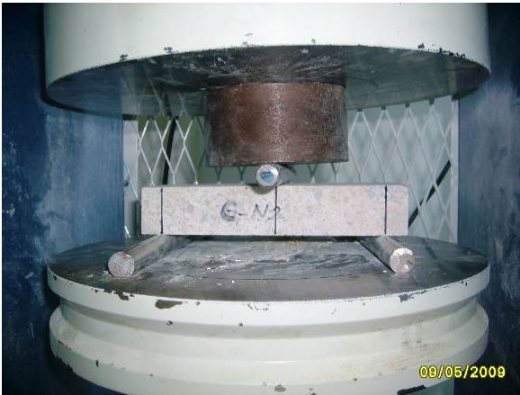
Şekil 7. Plaka şeklinde örnekler üzerinde yapılan bükülme dayanım deneyi.
