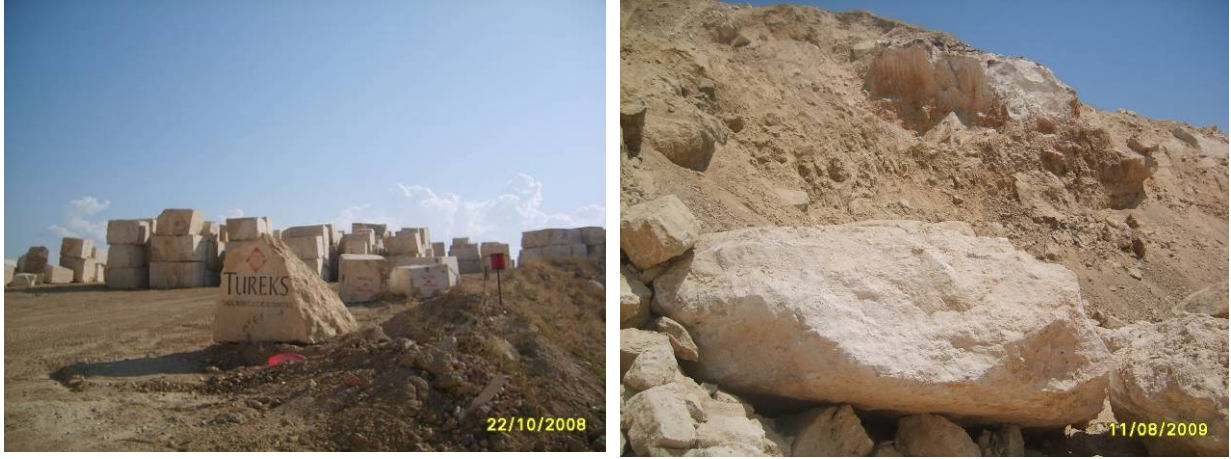
Şekil 81. Ocaktan elde edilmiş blokların stok sahası içindeki görünümü ve tekleme usulü ile alınan bloklar.
