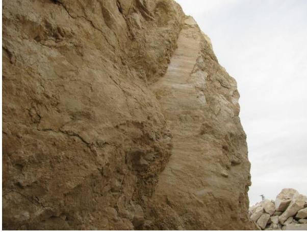
Şekil 59. Ocak içerisinde görülen K80B / 90° konumlu fay yüzeyi üzerindeki kayma izleri (solda) ve ezik zonun genel görünümü (sağda).
