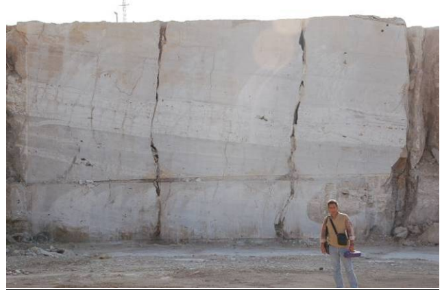
Şekil 83. Ocak taban seviyesinden çıkan yeraltı suyu ile faylanmaya bağlı olarak oluşmuş düşey kırıklarda görülen atım.
