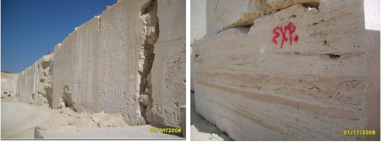
Şekil 105. Killi ve kısmen kumlu bir yapı da sunan taşta düşey açılma çatlaklarının ve yatay su yollu yapının görünümü.
