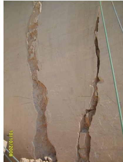
Şekil 16. Sorkun Mermer firmasına ait 1 nolu ocakta yaygın kırık ve çatlaklılık.
