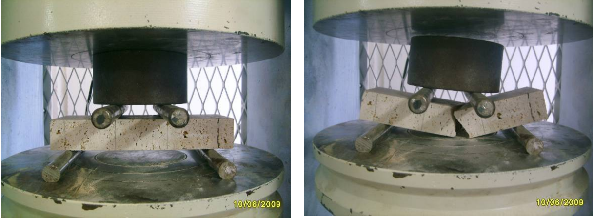
Şekil 8. Plaka şeklinde örnekler üzerinde yapılan sabit moment altında eğilme dayanımı deney düzeneği ve test edilmiş traverten numunesi.
