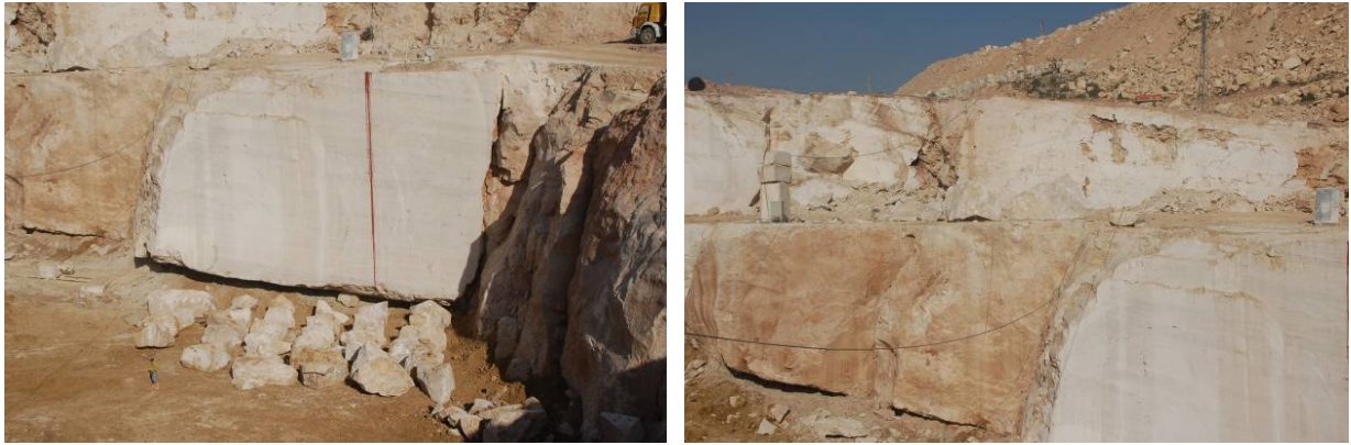
Şekil 69. Sesemar firmasına ait ocakta taban seviyesinde yer alan killi birim ile ocaktaki kırık ve çatlaklılığın görünümü.
