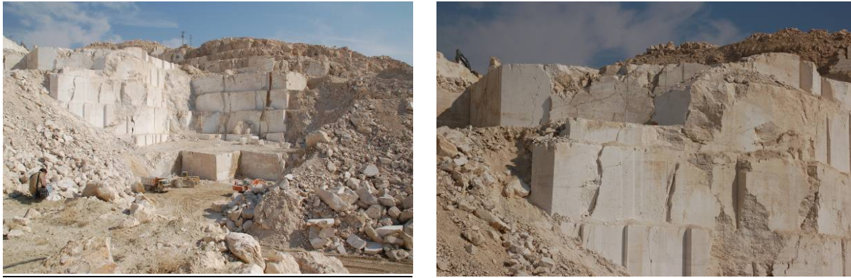
Şekil 94. Yoğun tektonizma nedeni ile aşırı kırıklı bir yapı kazanmış olan ocağın ve kırık sistemlerinin görünümü.
