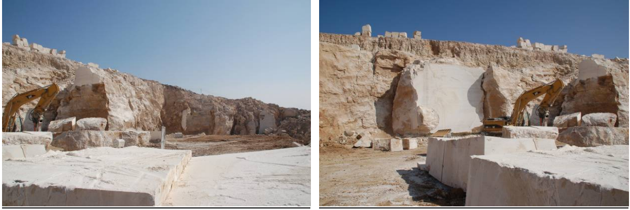
Şekil 77. Ocak içinde pasa malzemesinin ve traverten tabakası altında çıkan killi birimin görünümü.
