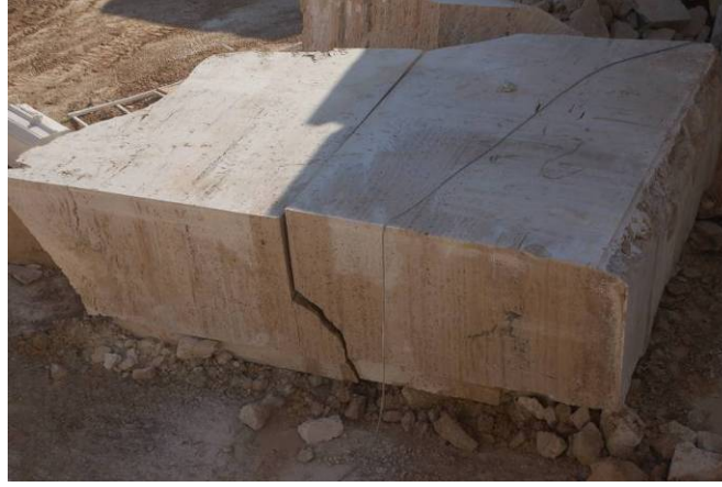
Şekil 34. Devrilen blokta su yollu yapının görünümü.
