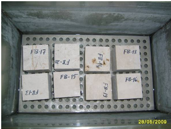
Şekil 4. Kapiler su emme deney havuzu ve su emdirilmiş örneklerin görünümü.
