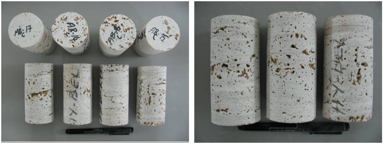
Şekil 51. Elde edilen karot örneklerinde kayacın makro gözenekli yapısı.
