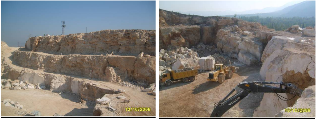
Şekil 14. Işık Mermer firmasına ait ocakta yaygın kırık ve çatlaklılık.
