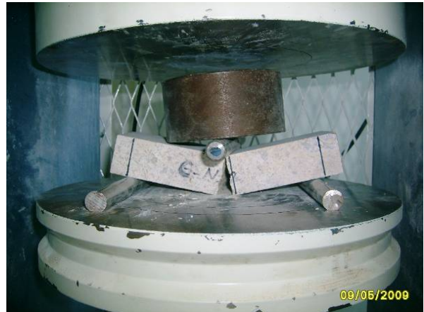
Şekil 7. Plaka şeklinde örnekler üzerinde yapılan bükülme dayanım deneyi.
