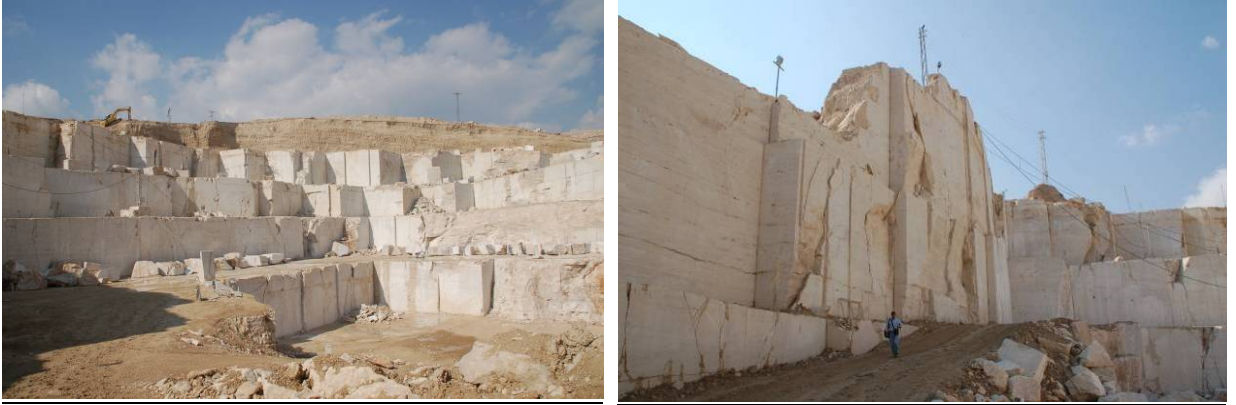
Şekil 41. İsmar Mermer firmasına ait ocakta yaygın kırık ve çatlaklılığın görünümü.
