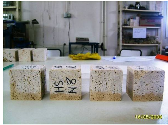
Şekil 4. Kapiler su emme deney havuzu ve su emdirilmiş örneklerin görünümü.
