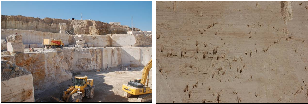
Şekil 119. Alimoğlu Tasarım firmasına ait ocakta işletme basamakları ve taşta görülen kedi pençesi adı verilen düzensiz geometrili gözenekli yapının görünümü.
