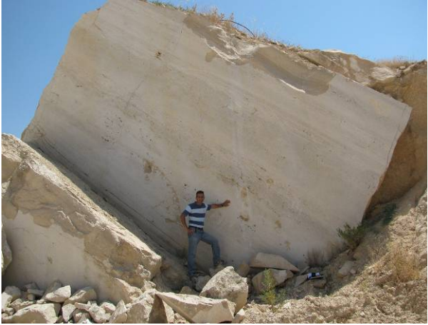
Şekil 113. Ocakta tektonizmaya bağlı olarak eğilmenmiş traverten tabakaları ile kırık ve çatlaklılıktan daha az etkilenmiş kısmen yatay konumlu tabakaların görünümü.
