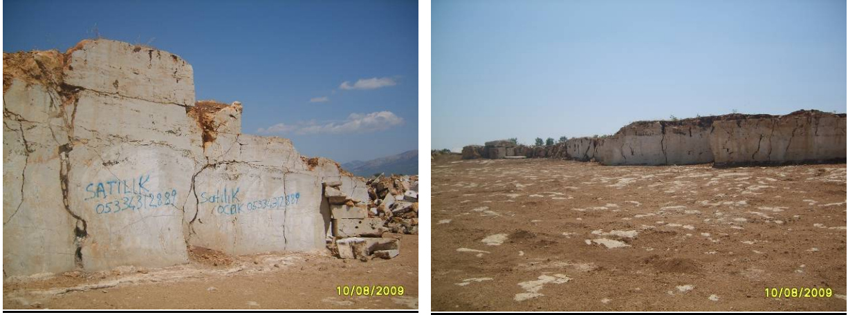
Şekil 133. Tek kademe olarak işletilen ocakta kırık ve çatlaklılık ile ocak genel görünümü.
