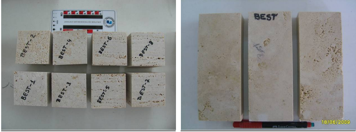
Şekil 97. Deney numunelerinde taşın makro yapısı ve su yollu yapının genel görünümü.
