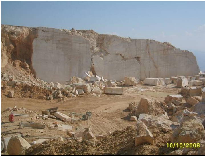
Şekil 16. Sorkun Mermer firmasına ait 1 nolu ocakta yaygın kırık ve çatlaklılık.
