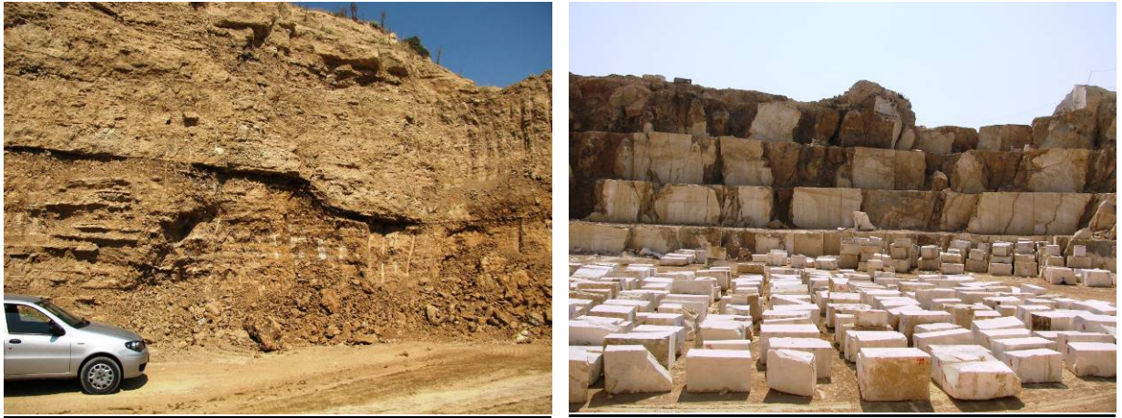
Şekil 131. Ocak batı kesiminde görülen killi birim ve ocak orta kesiminde faylanma etkisiyle meydana gelen yoğun kırık ve çatlaklılık.
