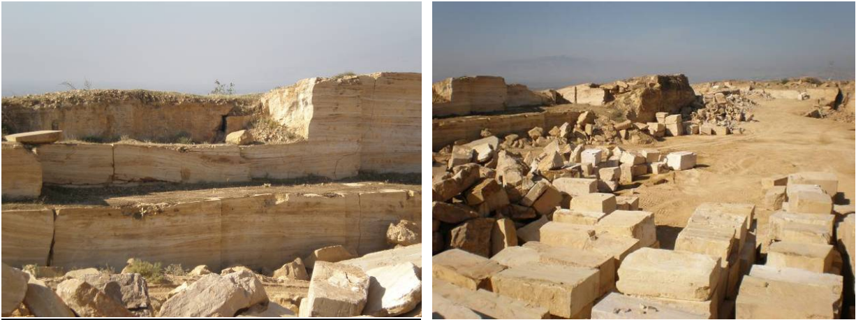
Şekil 126. Ocakta görülen su yollu yapı ve çıkarılmış bloklar.
