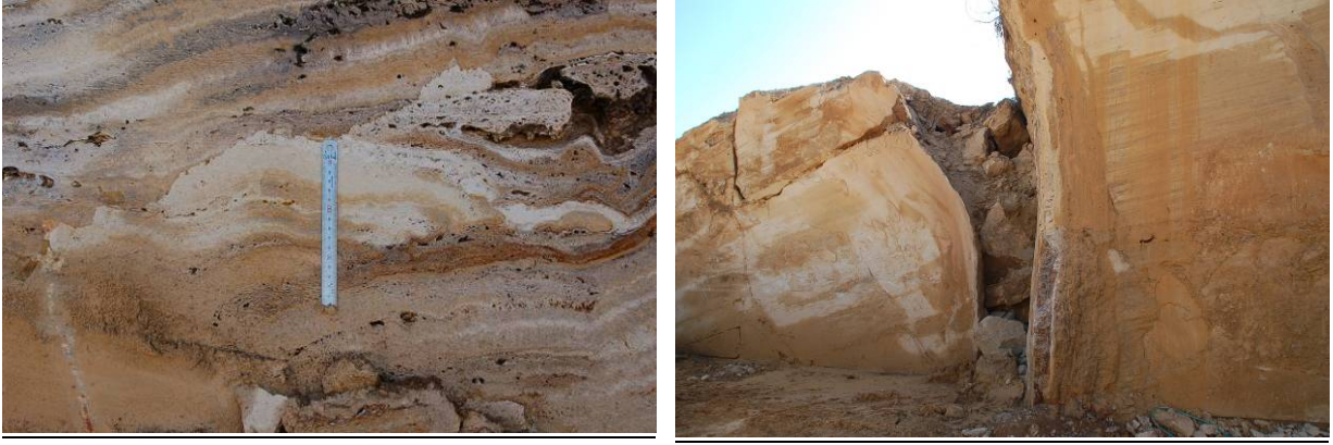
Şekil 122. “Akköy Sarı” ticari adı ile tanınan sarı renkli travertende düzensiz laminalanma ve ocak içindeki açılma çatlaklarının görünümü.
