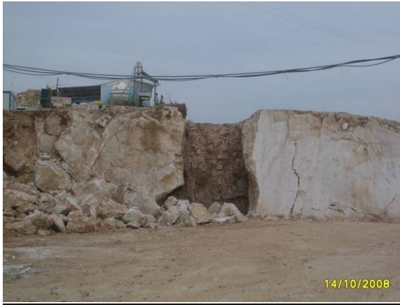
Şekil 38. Ege Traverten firmasına ait ocakta faylanmaya bağlı olarak oluşmuş olan açılma çatlakları.
