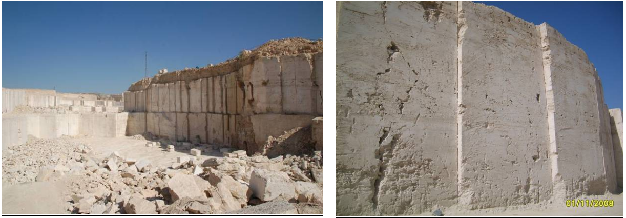
Şekil 103. 2 kademe olarak işletilmiş terk edilmiş ocakta kırık ve çatlaklılık ile boşluklu yapının görünümü.
