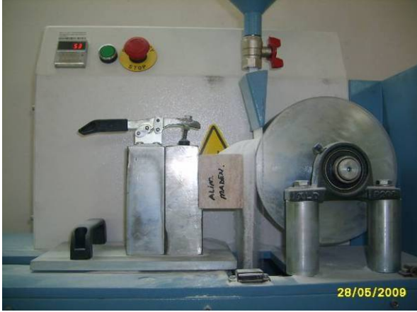
Şekil 6. Dikey aşındırma deney düzeneği ve test edilmiş traverten örnekleri.
