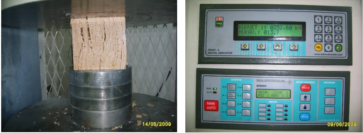
Şekil 9. Basınç dayanımı testlerinden örnek ve dijital yükleme ünitesi.
