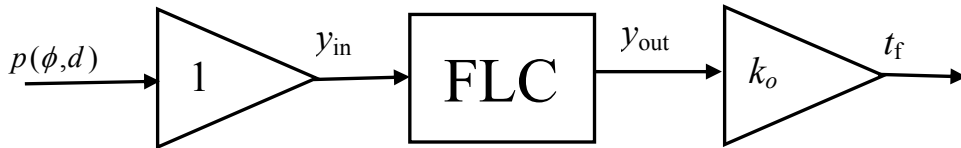
Şekil 5.2. Sistem parametresi t_f 'in elde edilmesi için kullanılan tek giriş-tek çıkışlı bulanık mantık kontrolör
