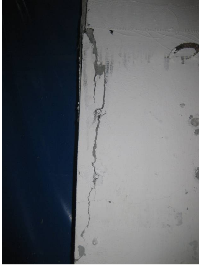
Şekil 7.14 C3 çerçevelerde konik kopmalar
