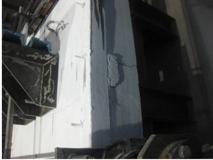
Şekil 7.19 C3DD elemanında perde ve çerçeve konik kopmaları
