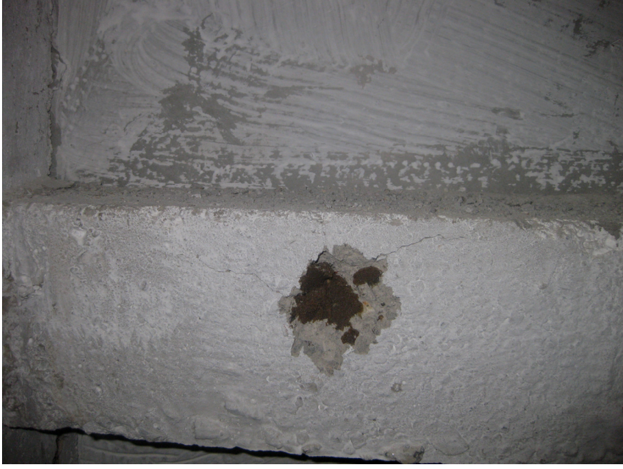
Şekil 7.10 Kirişte konik kopma
