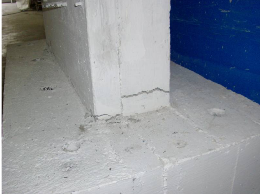
Şekil 7.17 C3DA+ elemanında eğilme kırılması
