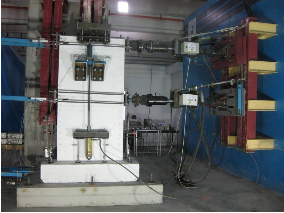
Şekil 6.18 Veren-veren mesnedi ve veren-çerçeve bağlantıları
