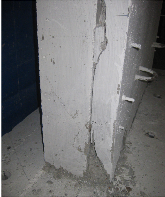
Şekil 7.16 C3BB elemanında tabanda kayma
