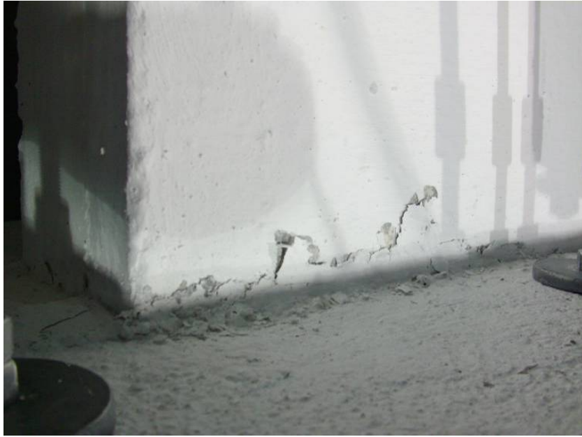
Şekil 7.18 C3DA+ elemanında basınç bölgesinde ezilme başlangıcı
