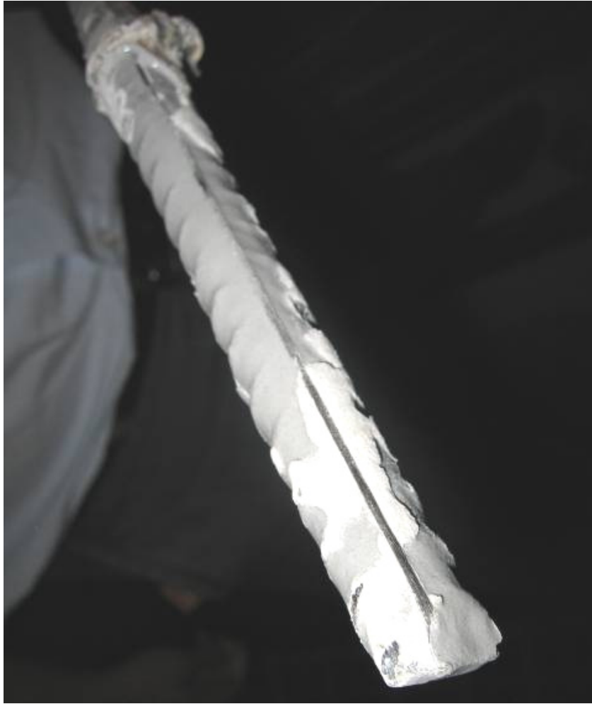
Şekil 3.3 Epoksi doldurulmamış deliğe yapılan ankrajda kenetlenme yüzeyi
