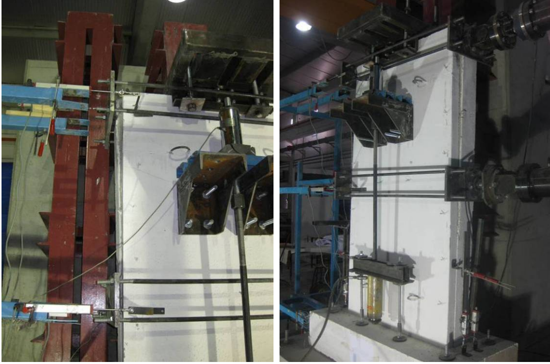
Şekil 7.2 Perdenin çerçeveden ayrılmaya başlaması
