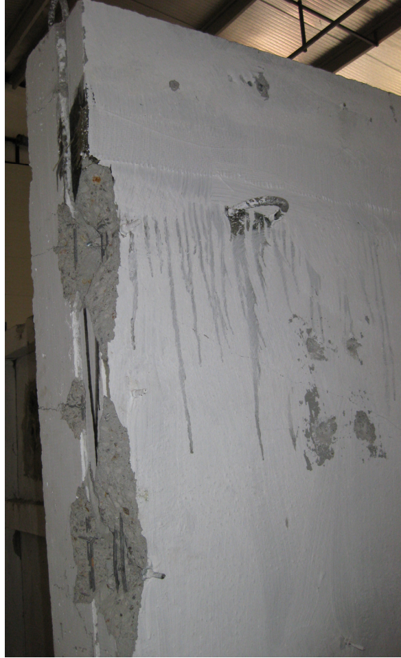
Şekil 7.11 Perdede oluşan konik kopmalar
