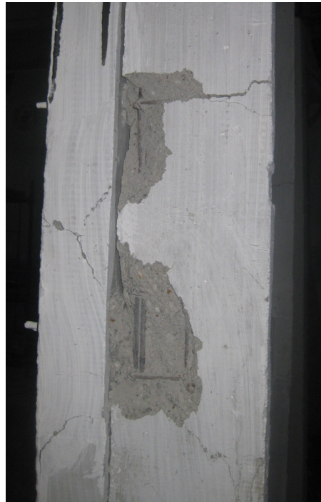
Şekil 7.9 Kolonda konik kopma
