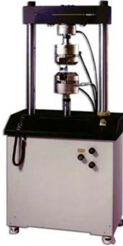
Şekil 3.7 Eksenel yorulma test cihazı
