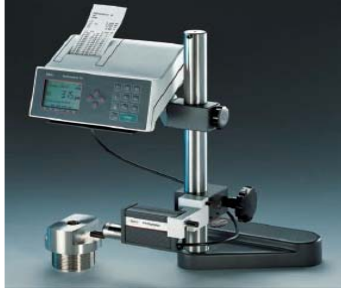
Şekil 3.4 Yüzey pürüzlülüğü ölçüm cihazı
