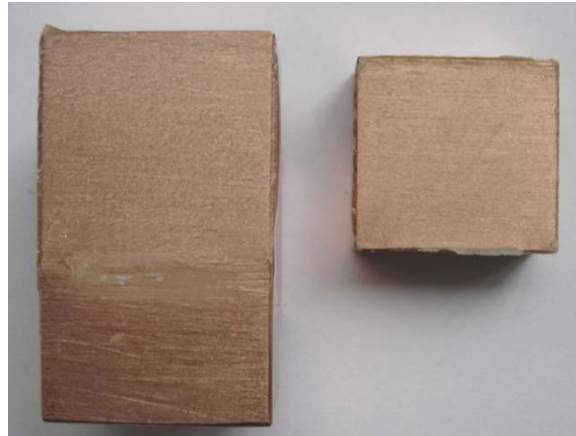
Şekil 2.5 Kohezyon hasarının fotoğraf olarak gösterilmesi
