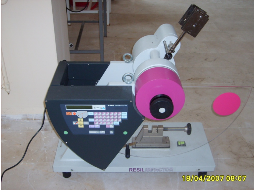
řekil 3.1 Deneylerde kullanılan Izod darbe cihazı
