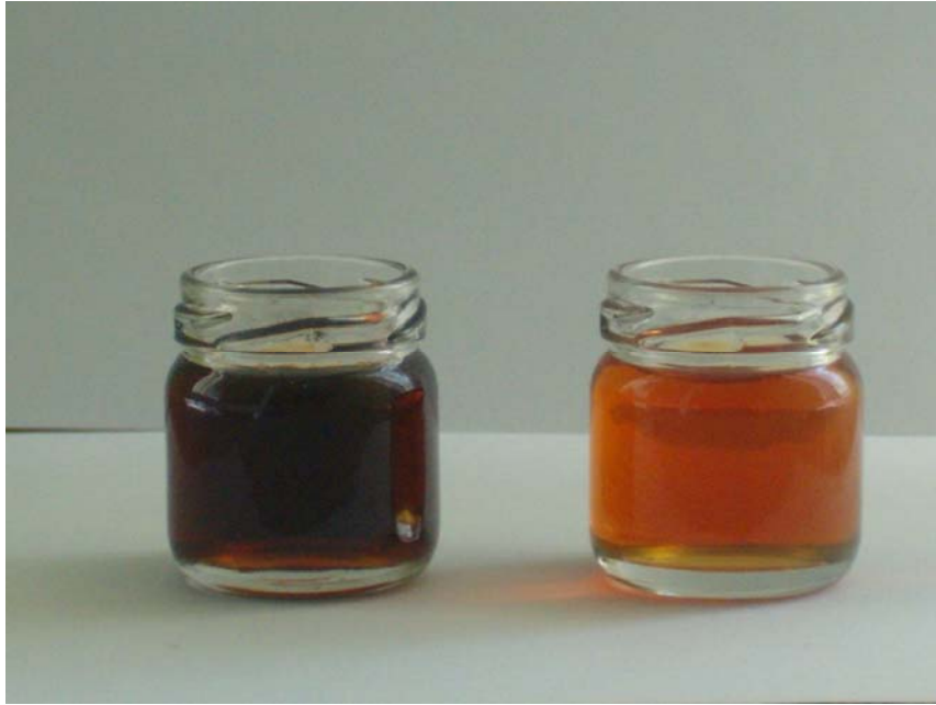
Şekil 4.21. Atık karışım yağı (AKY- solda) ve biyodizeli (AKYME- sağda)
