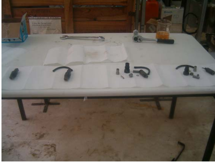
Şekil 5.35. Ön yanma odalı dizel motorun enjektörlerinin kontrol edilme çalışması
