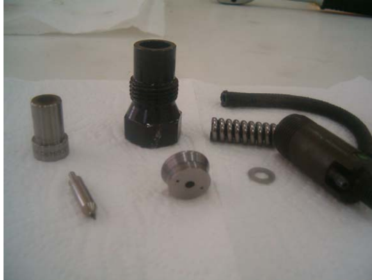
Şekil 5.36. Ön yanma odalı dizel motorun tek noktalı bir enjektörün kontrol edilmek üzere sökülmüş hali
