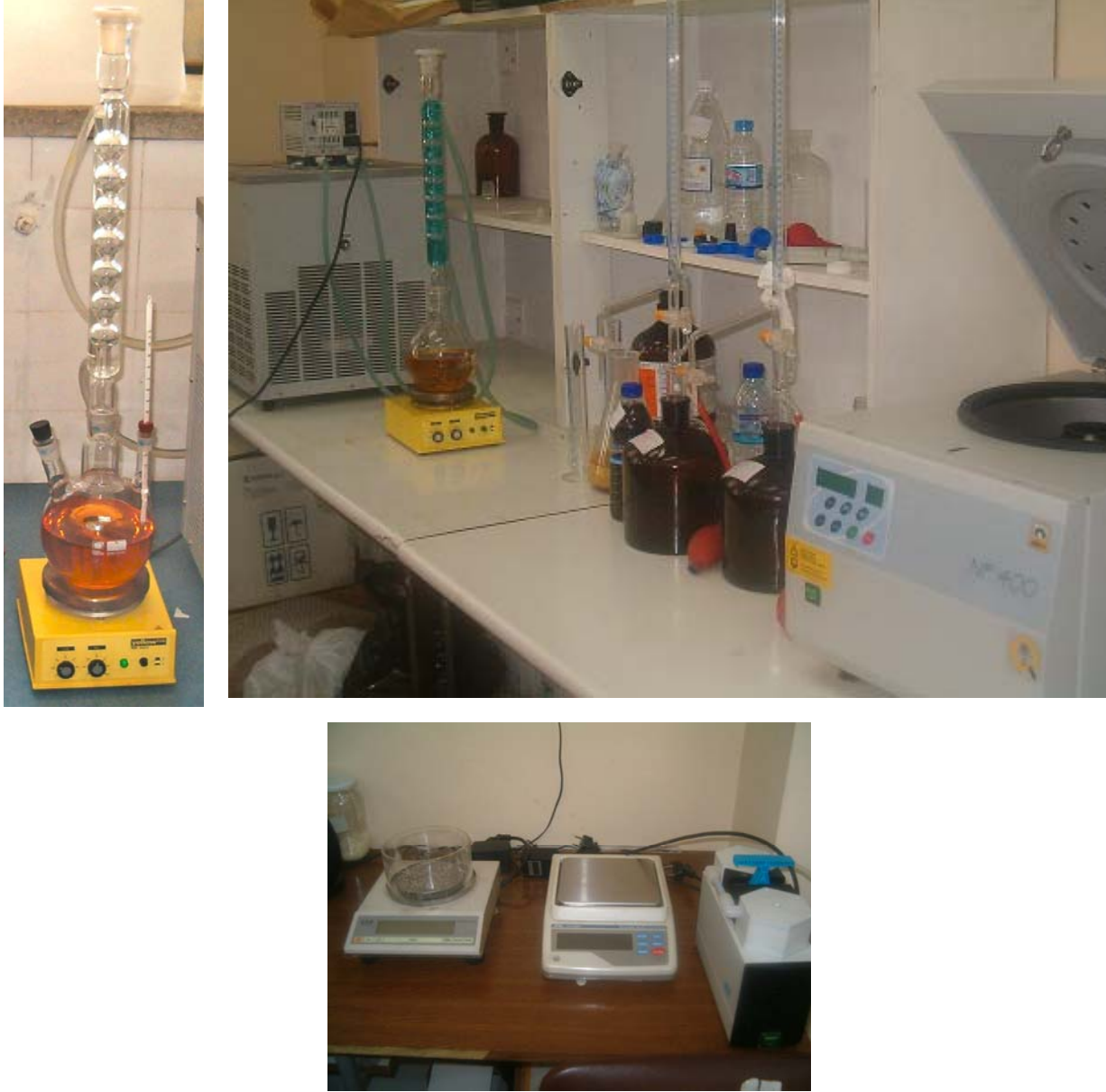
Şekil 4.1. Küçük ölçekte biyodizel üretimi için düzenek (Su soğutucusu, üç boğazlı balon, geri soğutucu, manyetik karıştırıcı ısıtıcı, serbest yağ asitliği ölçümü için hazırlanan çözeltiler, santrifüj, hassas teraziler, vakum pompası)
