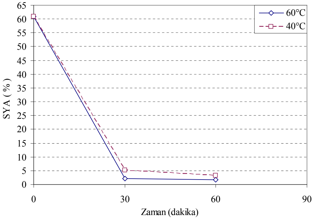
Şekil 4.27. Reaksiyon sıcaklığının serbest yağ asitliğinin düşürülmesine etkisi
