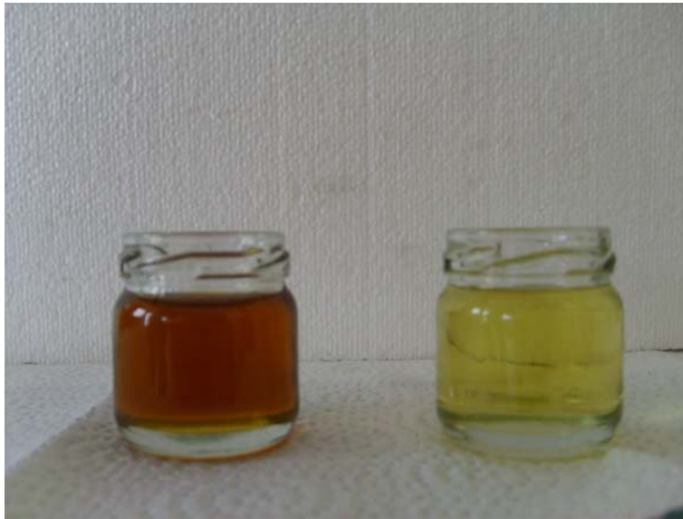
Şekil 4.15. Tütün tohumu yağı (TTY - solda) ve biyodizeli (TTYME - sağda)
