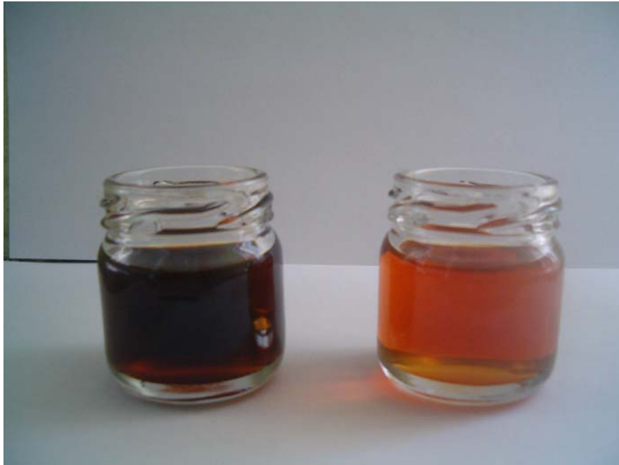
Şekil 4.25. Ayçiçek yağı sabun stoğunun iki basamaklı serbest yağ asitliğinin düşürülmesi
