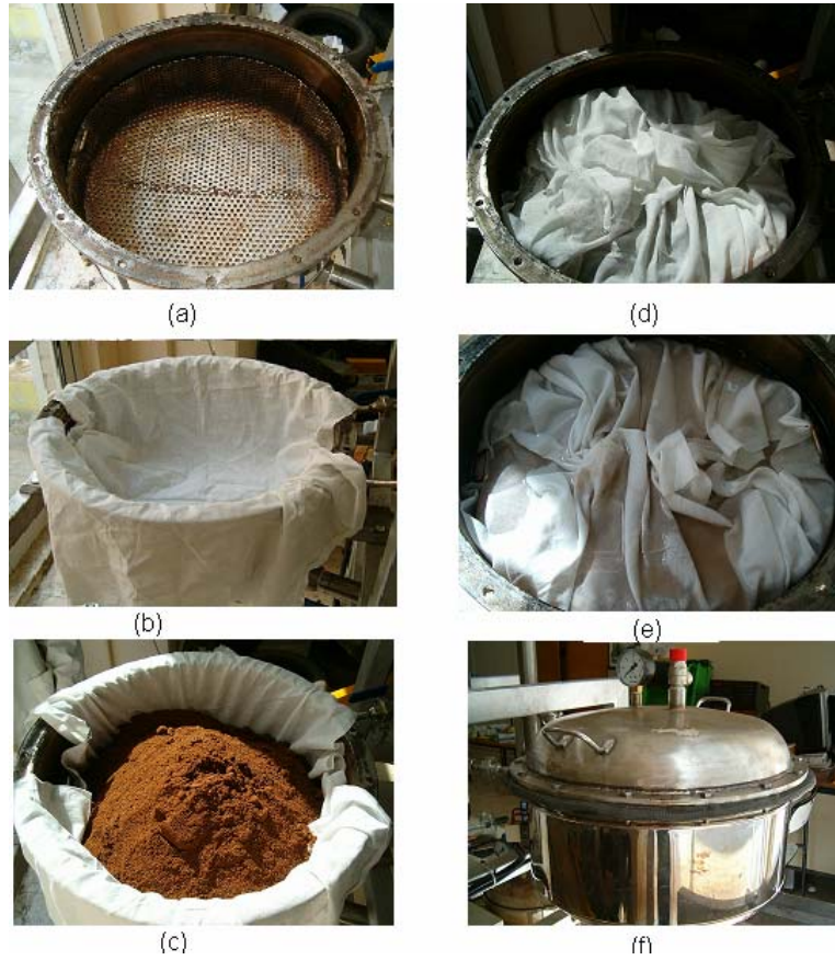
Şekil 4.8. Tütün tohumundan yağ çıkarma işleminin safhaları a) Tohum haznesinin boş şekli, b) Tohumların haznede kalmasını sağlayan tülün hazneye yerleştirilmesi, c) Tohumun hazneye konulması, d) Tohumların tül ile örtülmesi, e) Tohumlara dietil eterin eklenmesi, f) Hazne kapağının kapatılması.
