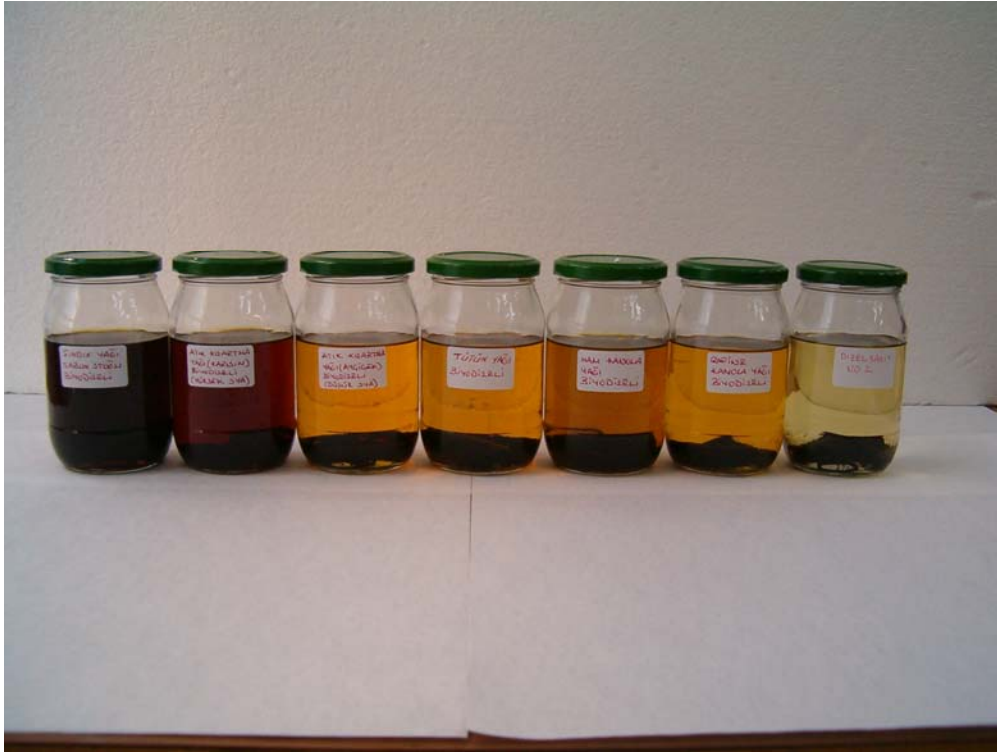
Şekil 5.37. Farklı elastomer parçalar dizel yakıt No.2 ve biyodizeller içinde
