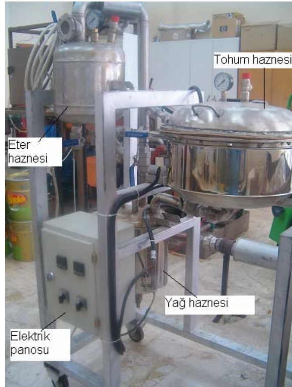
Şekil 4.6. Yağ çıkarma ünitesi
