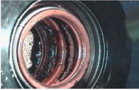
a) Ortak yakıt yolu sisteminin yüksek basınç pompası bileşeninde tortu birikimlerine sahip radyal mili geçesi bileşeni
