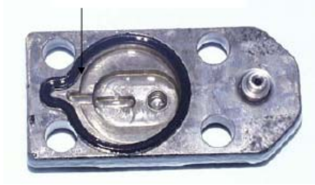
Şekil 3.3. Bir püskürtme pompası sızdırmazlık elemanının bozulmuş hali
