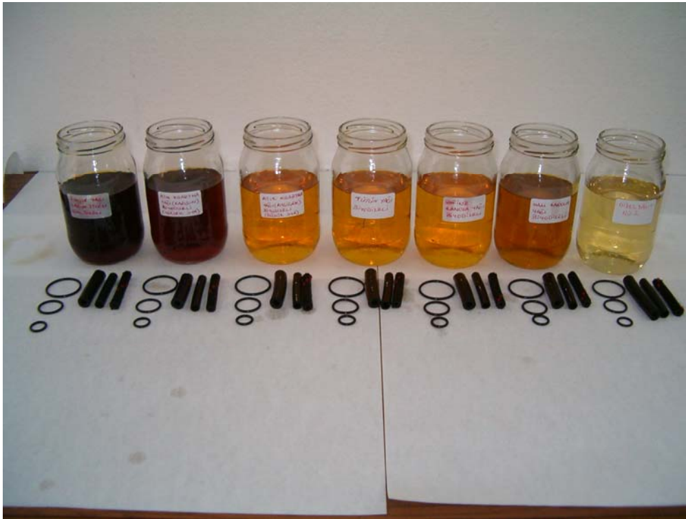
Şekil 5.38. Farklı elastomer parçaların kontrol çalışması
