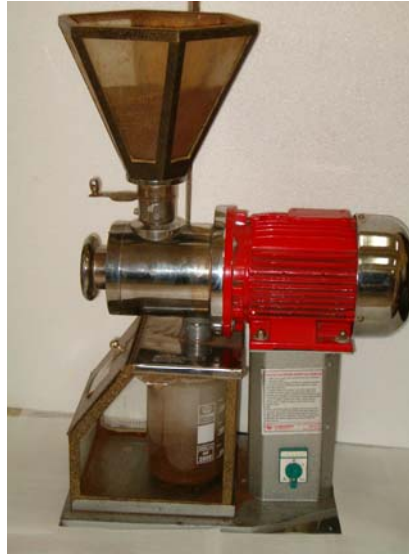
Şekil 4.7. Tohumu parçalama için kullanılan değirmen
