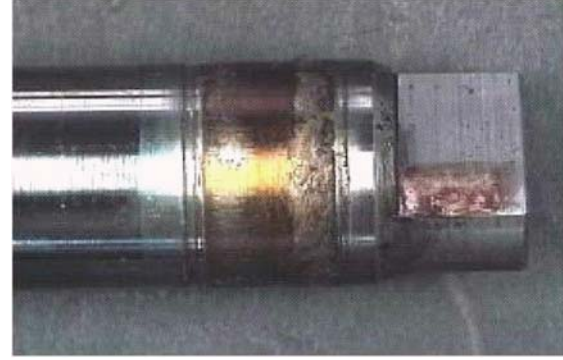
b) Ortak yakıt yolu sisteminin yüksek basınç pompası bileşeninde tortu birikimlerine sahip eksantrik mil bileşeni
