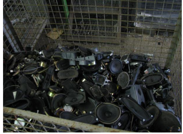
Şekil 18 E-atıkların demontajından elde edilen bileşenler ve sınıflandırma kutuları
