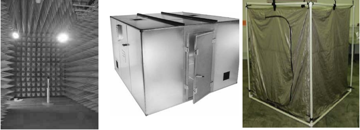
Şekil 7 Elektromanyetik kalkanlama amaçlı kullanıma yönelik oda ve çadır (WEB 9)
