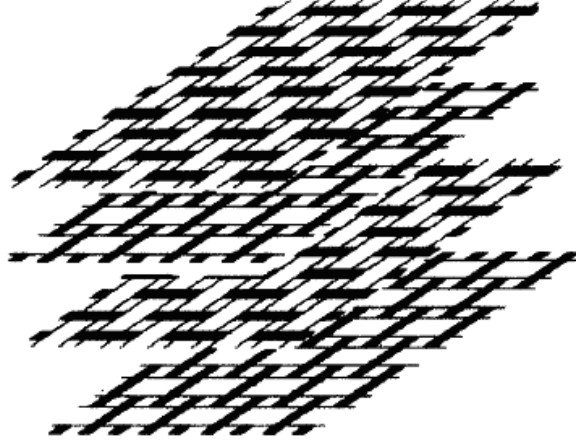
Şekil 23 Kompozit levha yapımında kumaş yerleşimi
