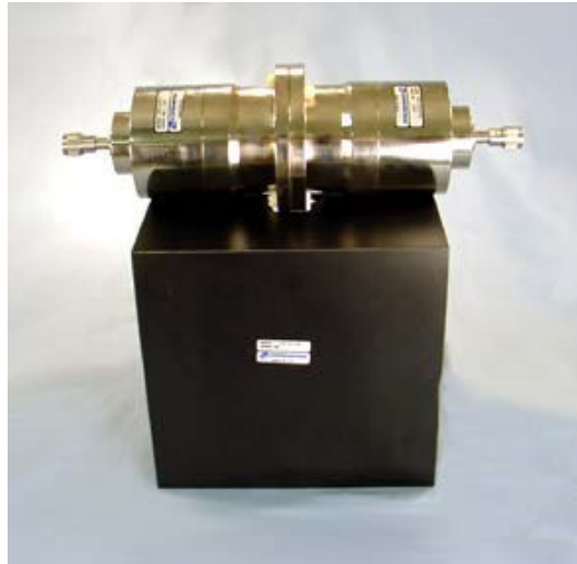
Şekil 5 ASTM D4935 test standardı için kullanılan ölçüm ünitesi
