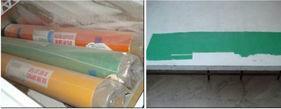
Şekil 11.6 FM73 film tabaka yapıştırıcı
