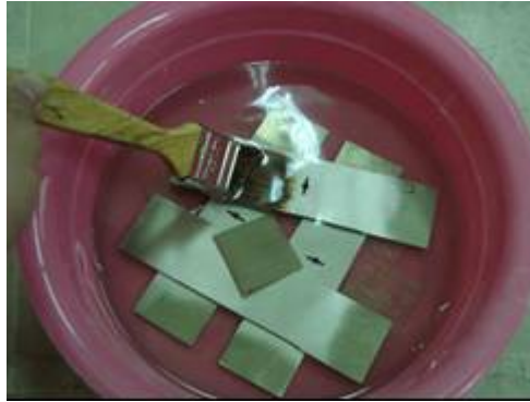
Şekil 11.8 Parlatılan yüzeyin Trikoetilen ile temizlenmesi
