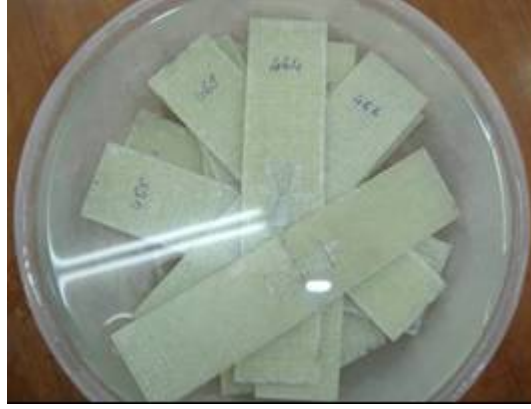
Şekil 7.17 Kelebek birleştirmelerinin su içinde bekletilmesi
