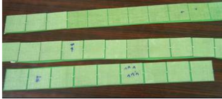
Şekil 11.4 40x40mm ebadında kompozit yamalar
