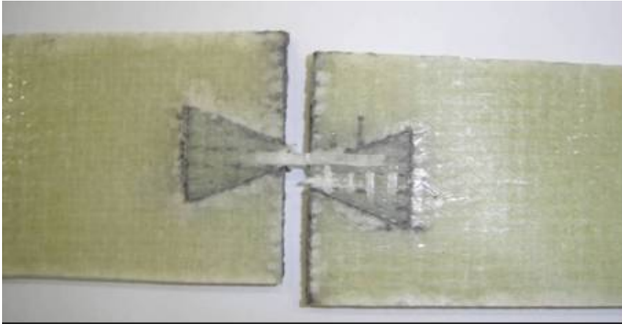
(b) Yapıştırıcı ile güçlendirilmiş sıkı geçme kelebek birleştirmesi.
