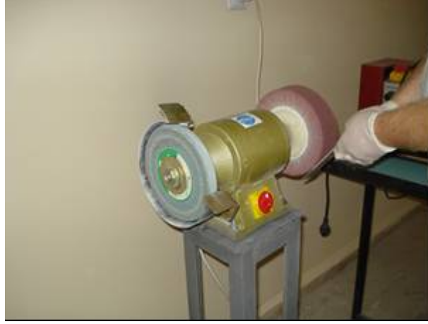
Şekil 11.7 Keçe ile yüzey temizleme işlemi
