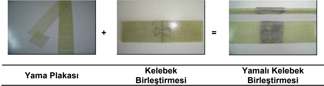
Şekil 7.11 Yamalı kelebek birleştirmesinin yapım şekli
