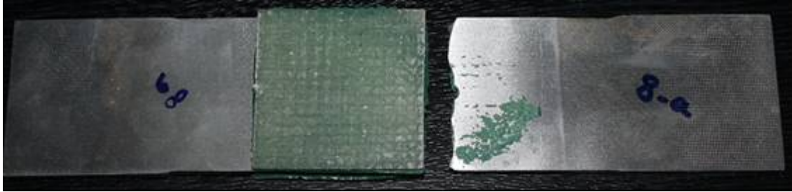
Şekil 12.22 Hasara uğramış yorulma numunesi
