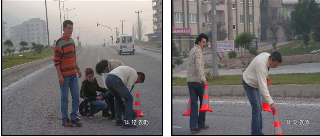
Şekil 4.10. Sensörün yerleştirilmesi ve güvenlik önlemleri
