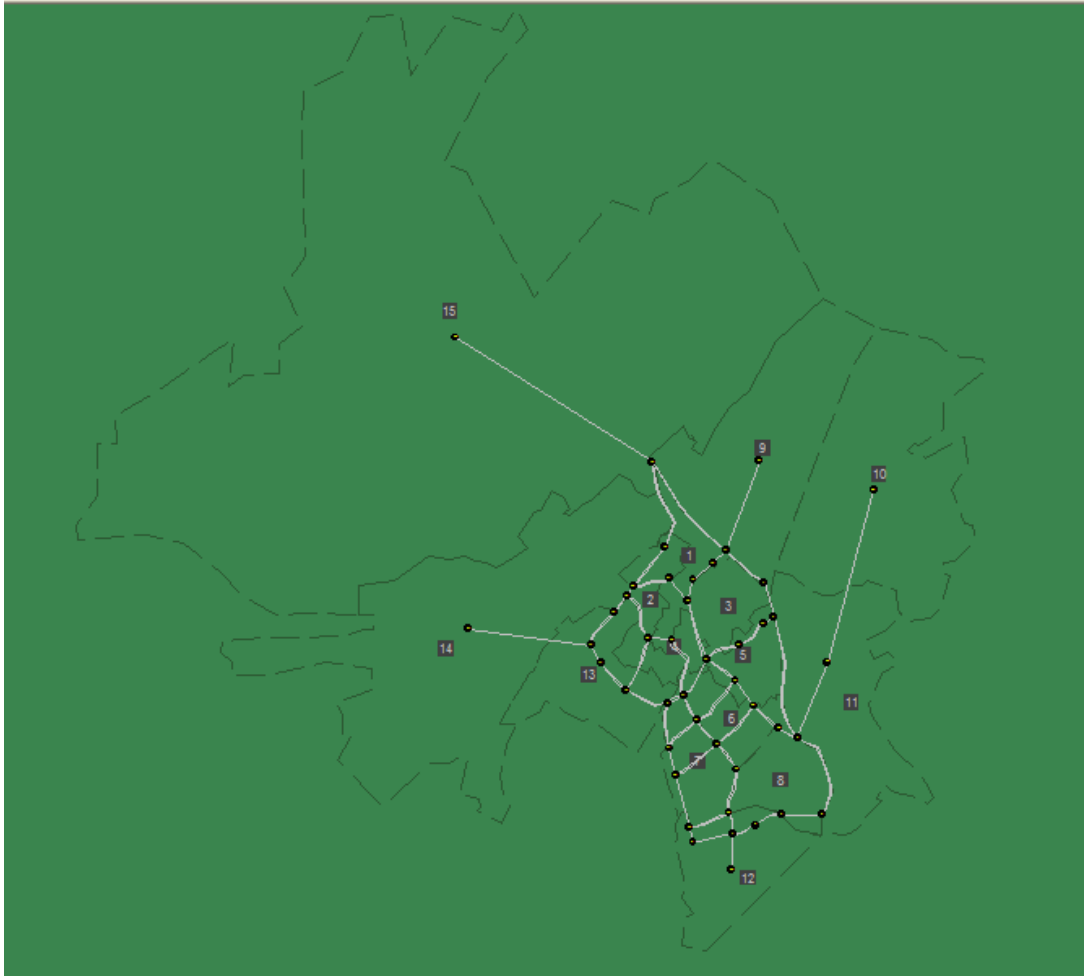
Şekil 9.5. Genişletilmiş Ulaşım Ağı (zonlar, linkler ve düğümler)
