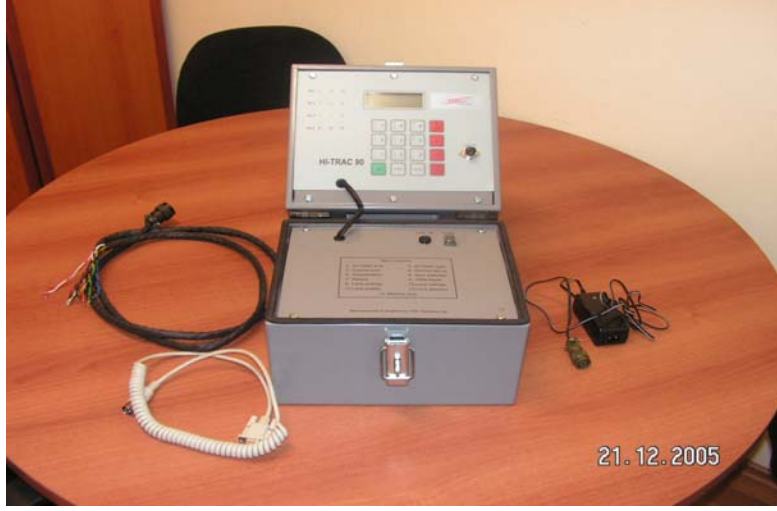
Şekil 4.8. Gezici türdeki HI-TRAC 90T tipi trafik sayım cihazı
