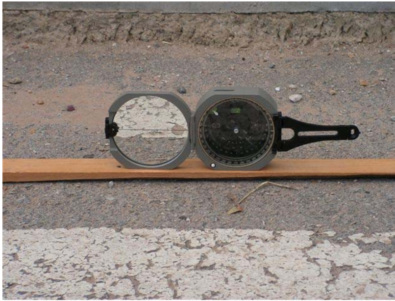
Şekil 7.2 Klinometre ile yol eğiminin ölçülmesi
