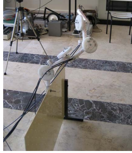
Şekil 13. 4 serbestlik dereceli ve üç boyutlu dizayn
