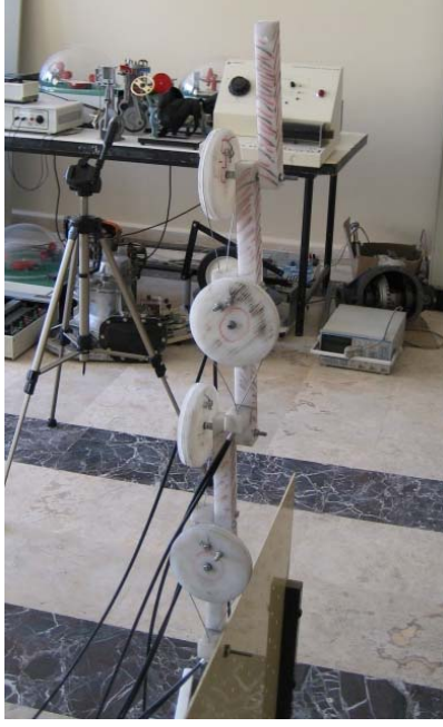
Şekil 13. 4 serbestlik dereceli ve üç boyutlu dizayn
