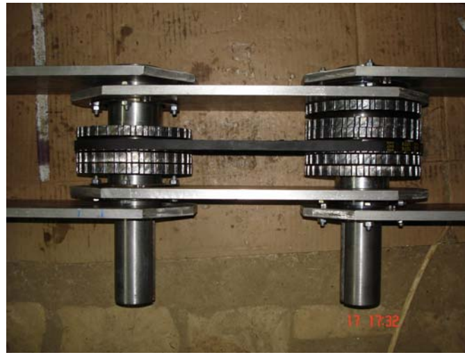
Şekil 5. Hareketin bir eksenenden diğer eksene kayışla geçmesi
