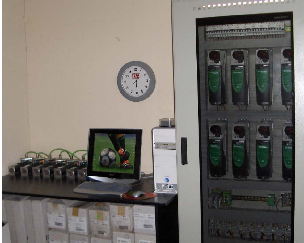
Şekil 15. 8 tane servo motor, bilgisayar ve servoları kontrol eden sürücülerin bulunduğu pano
