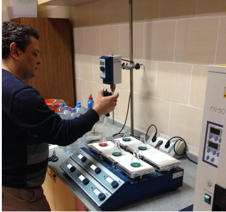
Şekil 4. Titrasyon yöntemiyle alkalinite analizi.
