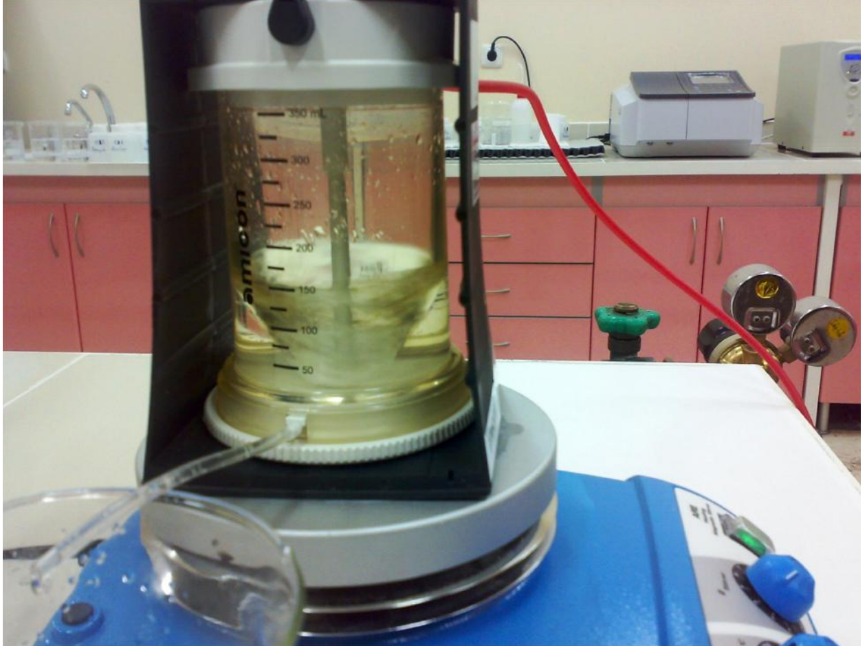
Şekil 5.2.2. Ham suların farklı gözenek çapına sahip UF filtrelerinden süzülmesi
