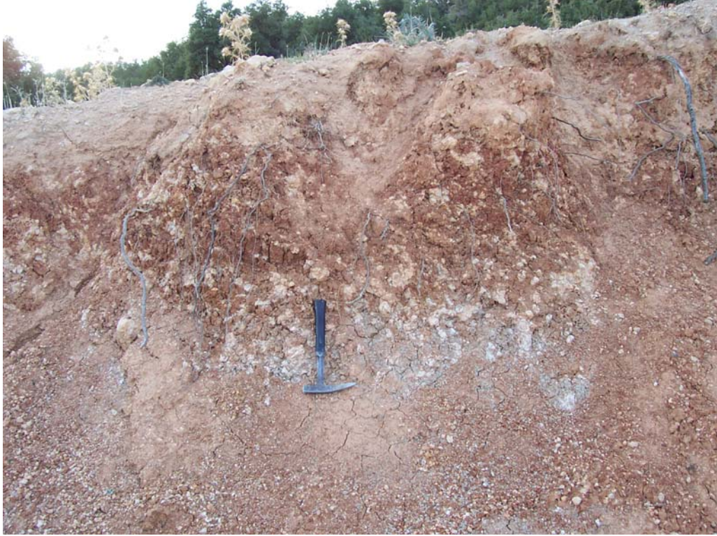
Şekil 3.45. Damdere Formasyonu'nun üst seviyelerini oluşturan ve iraksak alüvyon yelpazesi fasiyes topluluğunu (FT2: Dedeler-1 üyesi) temsil eden kalış yumruları içeren kırmızı renkli masif çamurtaşı çökelleri (Dedeler köyü, havzanın kuzeydoğusu)
