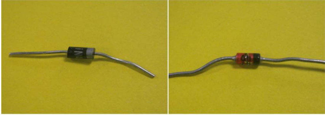
ekil 5.2: Soldan sa a sırasıyla 1N4007 kodlu diyot ile 1N4740A kodlu zener diyot.
