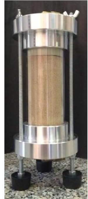
Şekil 6. Hazırlanan deney düzeneği ve zemin örneği ile deneye hazır hali
