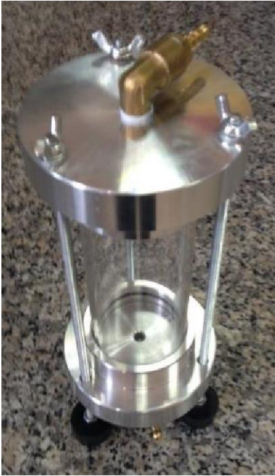
Şekil 6. Hazırlanan deney düzeneği ve zemin örneği ile deneye hazır hali
