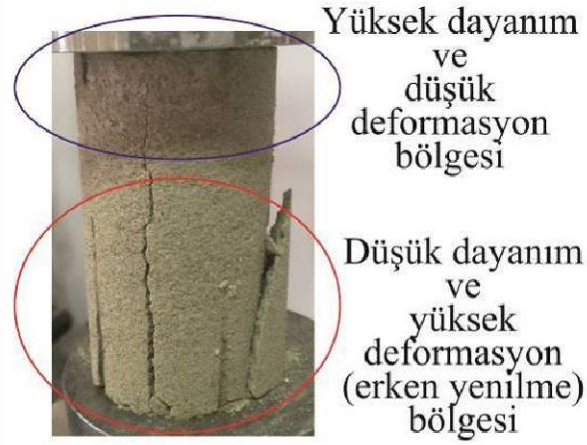
Şekil 36. Karbonat miktarına bağlı yenilme ve deformasyonlar
