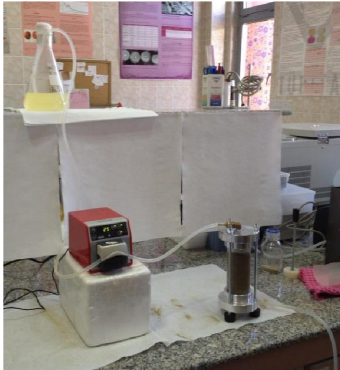
Şekil 11. 25d/d halinde bakterili sıvının zemin örneğinden geçişi
