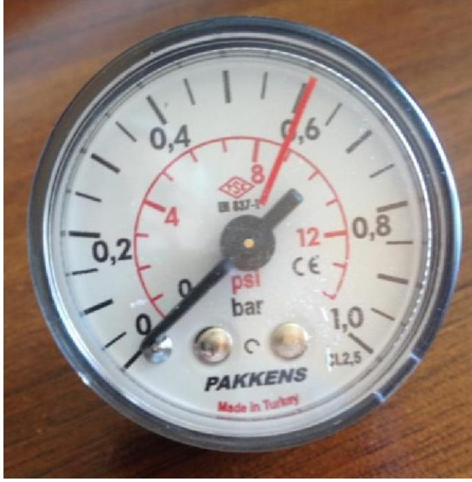
Şekil 12. Basınç ölçümünde kullanılan manometre
