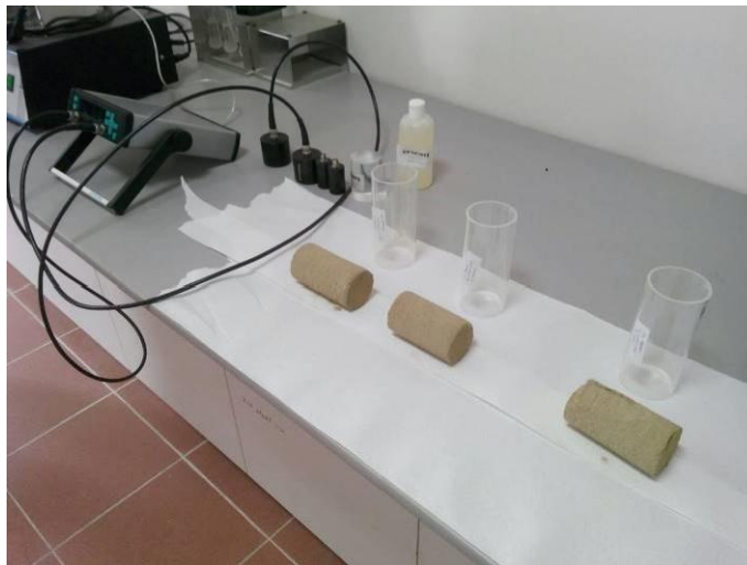
Şekil 19. Doğal ve güçlendirilmiş örneklerin hızlarının belirlenmesi için kullanılan düzenek
