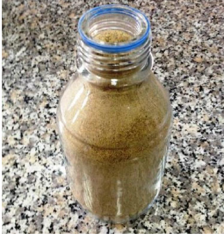
Şekil 4. Sterilize edilmiş #40 nolu elekten geçen ve #200 nolu ekte kalan tane boyu dağılımına sahip zemin örneği
