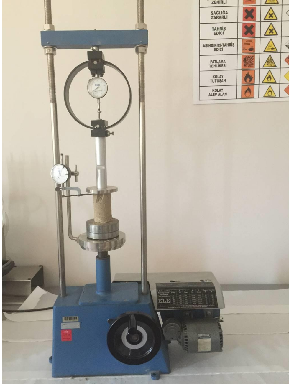
Şekil 15. Tek eksenli basma dayanımı deney düzeneği ve yenilmiş bir zemin örneği
