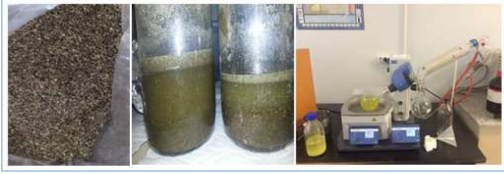
Şekil 3. 81 Urtica urens tohumunun çözücü ile ekstraksiyonu (meserasyon).
