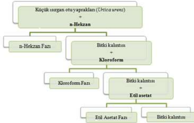
Şekil 2. 1. Urtica urens bitkisinden artan polaritelerdeki çözücüler ile yapılan ekstraksiyon işlemleri.
