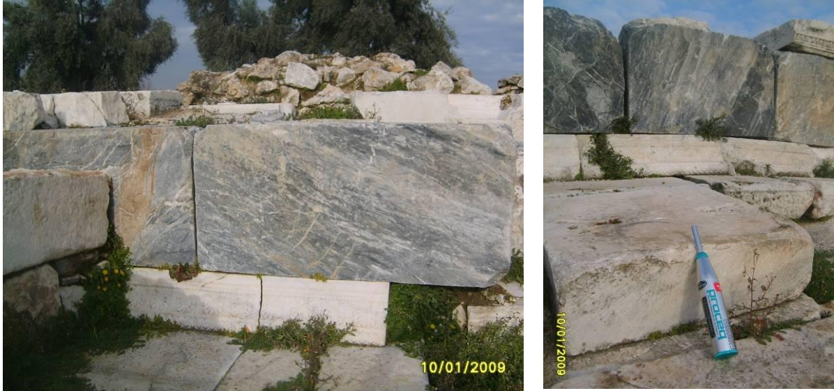
Resim 10-11: Schmidt Darbe Dayanım Testi Yapılan Altar Yapısı ile Gri ve Beyaz Renkli Mermerlerin Görünümü.
