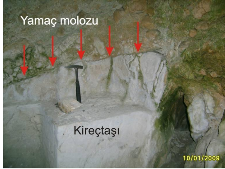
Şekil 3. 0591953 D/ 4137799 K, 432 m koordinatlı inceleme lokasyonu olan antik mezar içinde kireçtaşı birimi üzerinde yer alan yamaç molozu birimi (oklar iki birime ait dokanağı göstermektedir)
