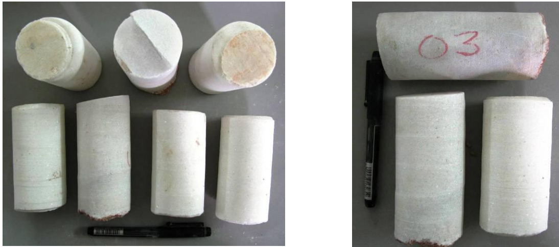
Resim 8-9. Kristalize Kireçtaşı (Muğla Beyaz) Blok Örneklerden Elde Edilmiş Karot Numuneler.
