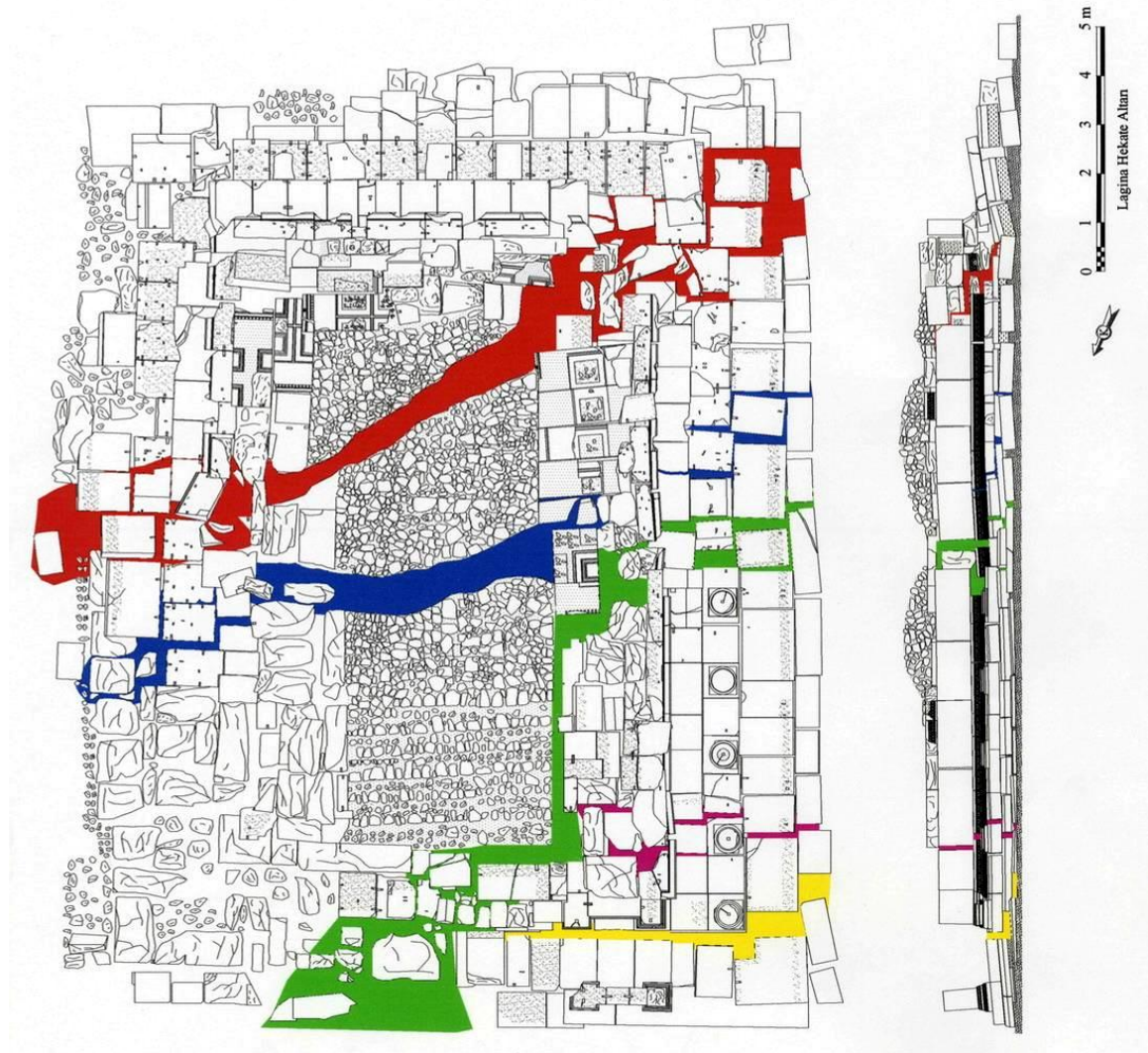
Çizim 2: Altar röleve plan ve kesiti üzerindeki deprem çatlakları
