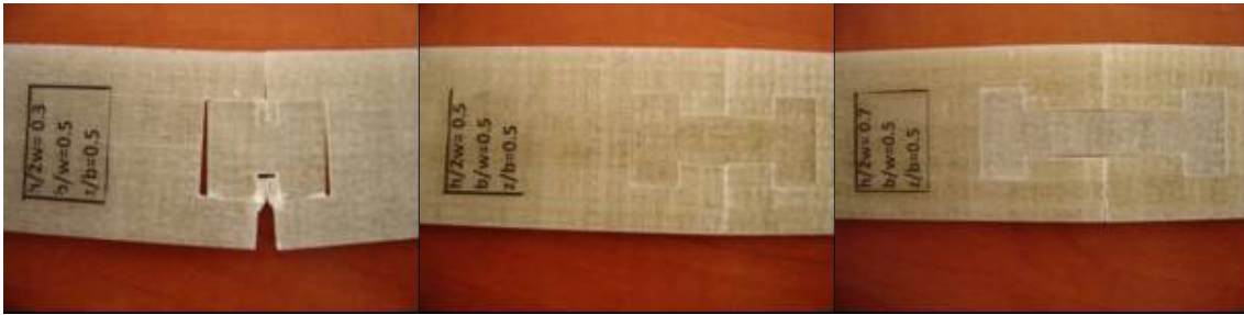
Şekil 6.37 : Maksimum bağlantı hasar yüklerinin elde edildiği geometrik parametrelerinin değişik h/2w oranlarındaki yük değişimleri
