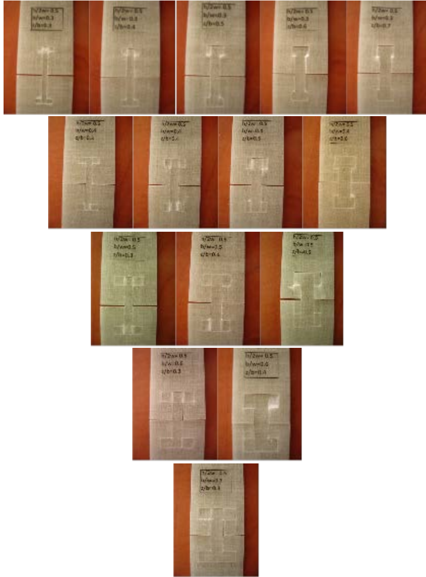
Şekil 6.56 : Bağlantı yüksekliğinin h/2w=0,5 oranı için bağlantı elemanlarının hasar şekilleri
