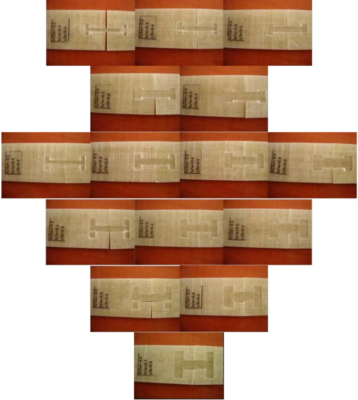
Şekil 6.39 : Bağlantı yüksekliğinin h/2w=0,5 oranı için bağlantı elemanlarının hasar şekilleri
