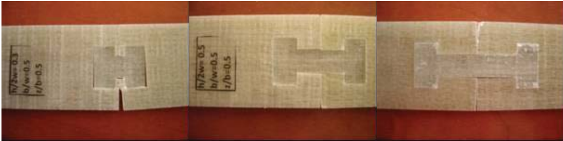
Şekil 6.4 : Maksimum bağlantı hasar yüklerinin elde edildiği geometrik parametrelerinin değişik h/2w oranlarındaki yük değişimleri ve hasar şekilleri
