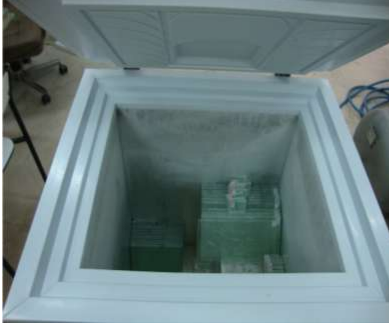
Şekil 3.24. Derin dondurucuda sıcaklığı düşürülen camların görünümü
