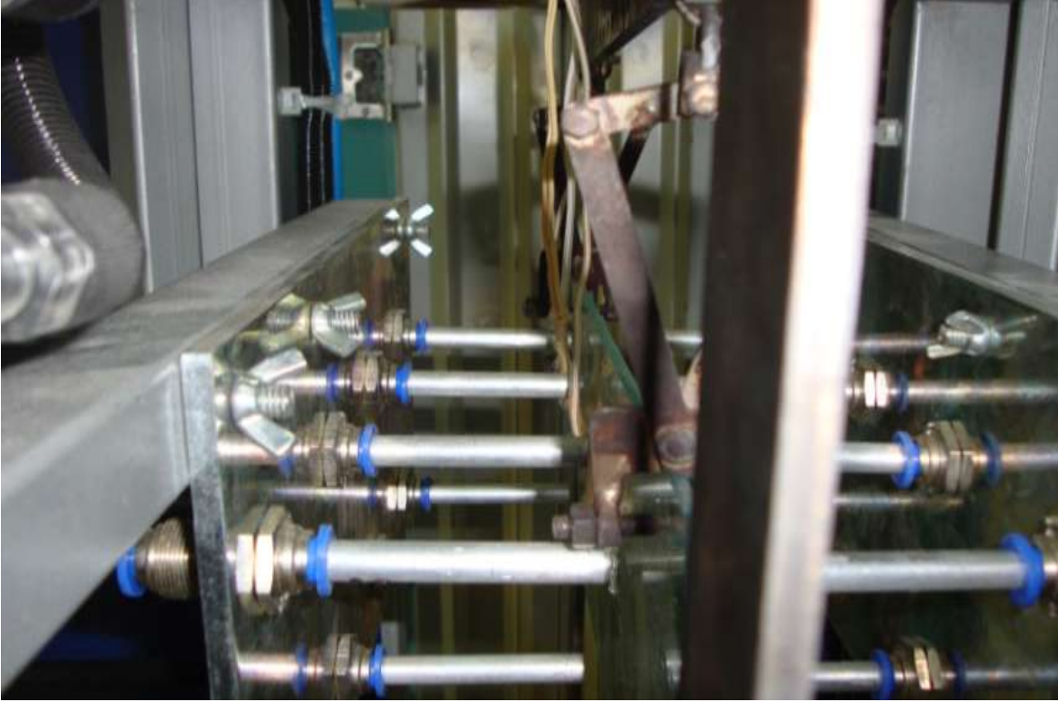
Şekil 3.20. kare dizilişli nozul plaka sisteminin soğutma ünitesindeki konumu
