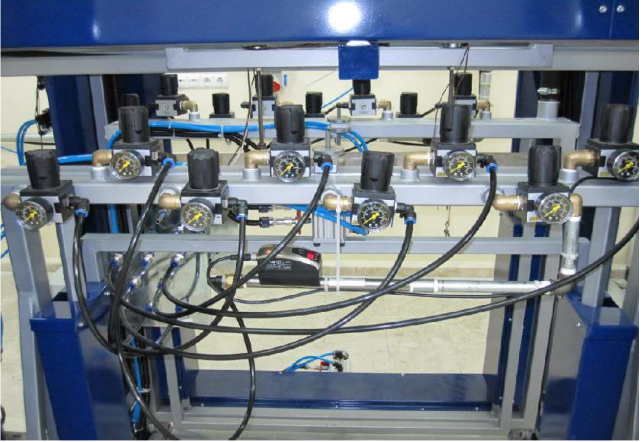
Şekil 3.7. Regülatörler, hava hortumları ve ½” debimetre
