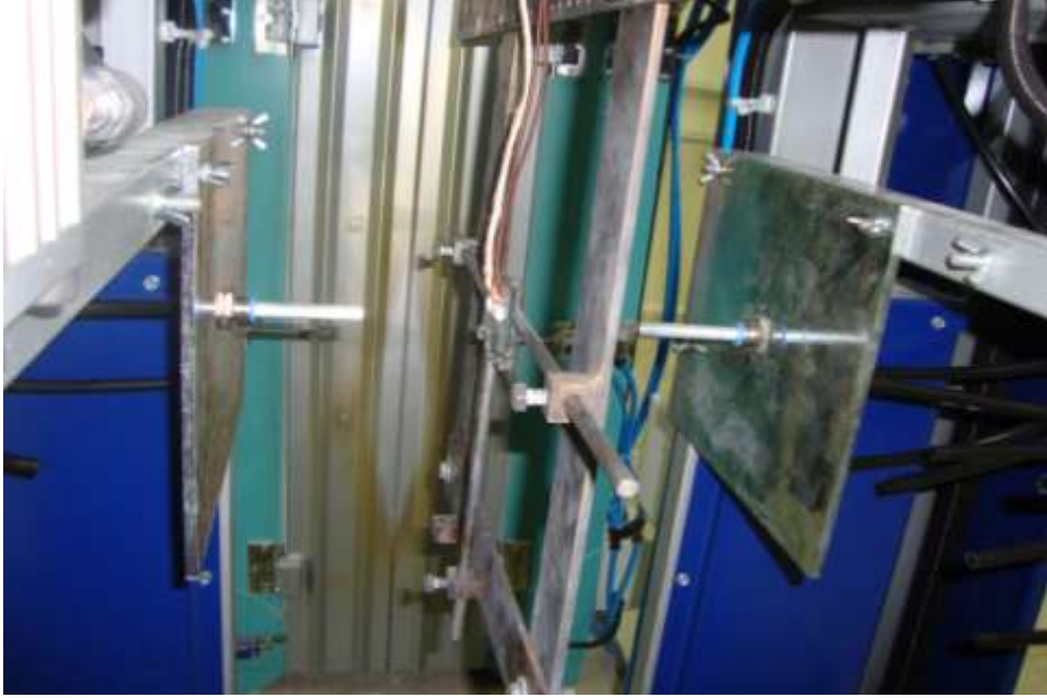
Şekil 3.17. Tekli nozul soğutma sistemi
