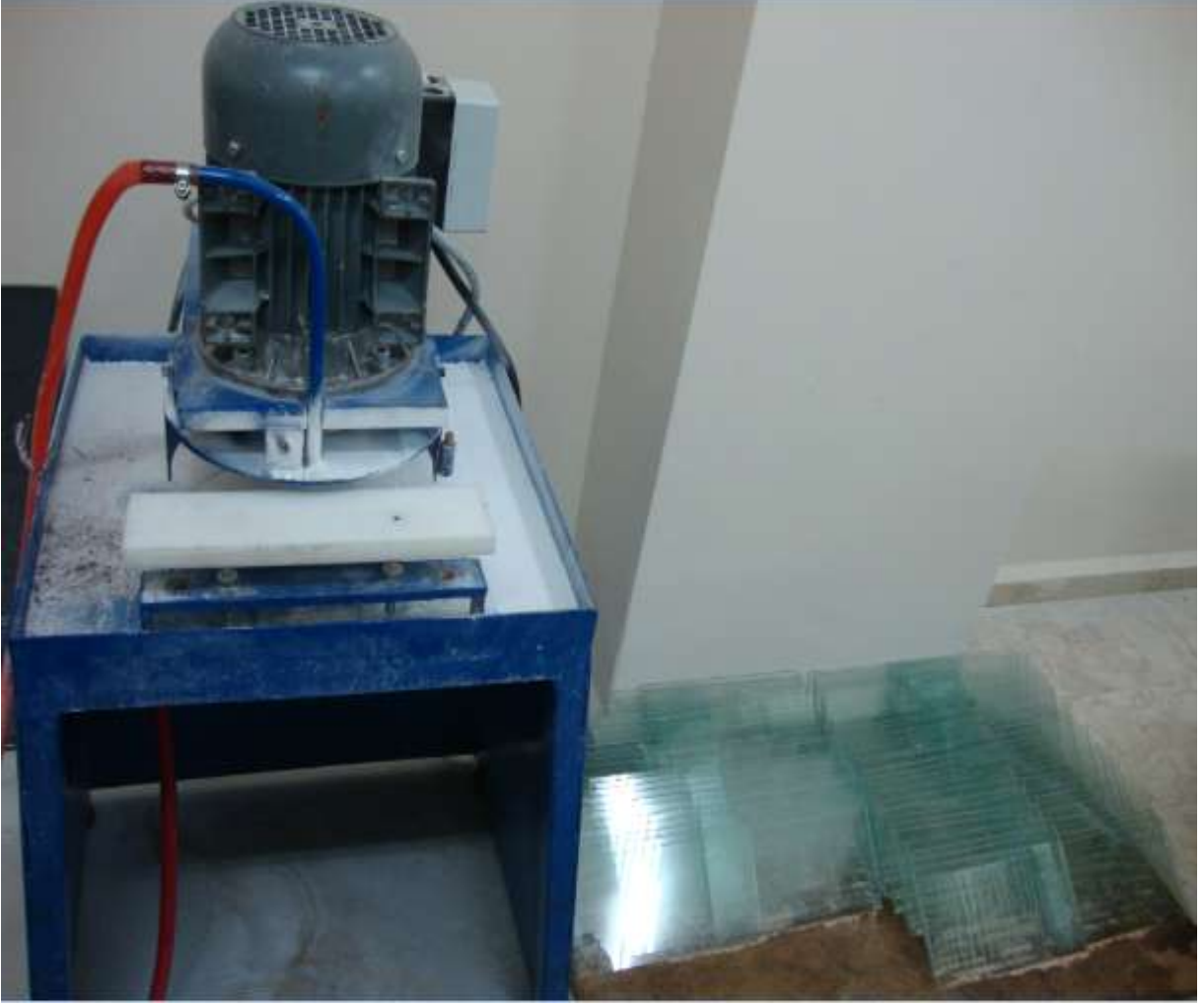
Ek 1. Rodajlama makinesi ve rodajlanmış camların görünümü
