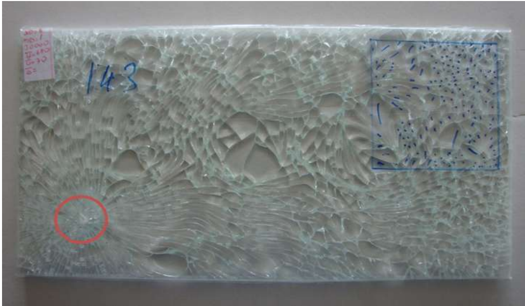
Şekil 4.36. Çekiç ile kırılan ve parçacık sayısı sayılan camın görünümü
