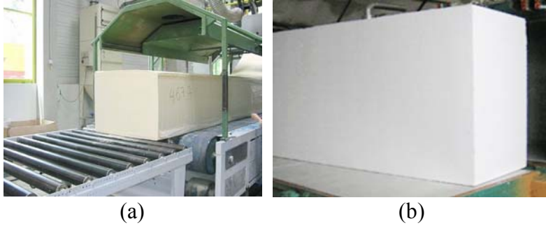
Şekil 2.16. (a) Esnek PU köpük üretim hattı ve (b) esnek köpük blokları (Url-6)
