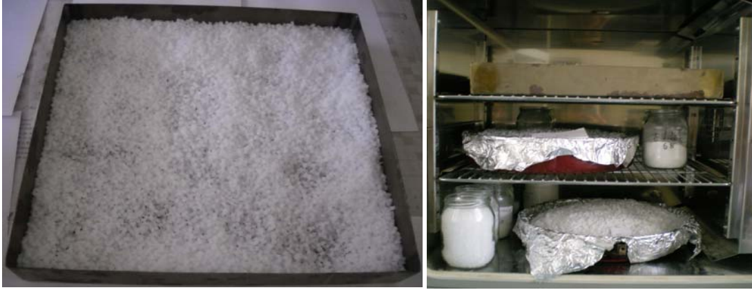
Şekil 3.21. (a) Termoplastik poliüretan (TPU) elastomer granül ve (b) termoplastik poliüretan elastomerlerin fırında kurutulması
