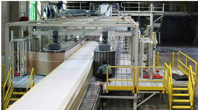
Şekil 2.9. PUR köpük levha malzemenin sürekli üretim hattı (Url-6)
