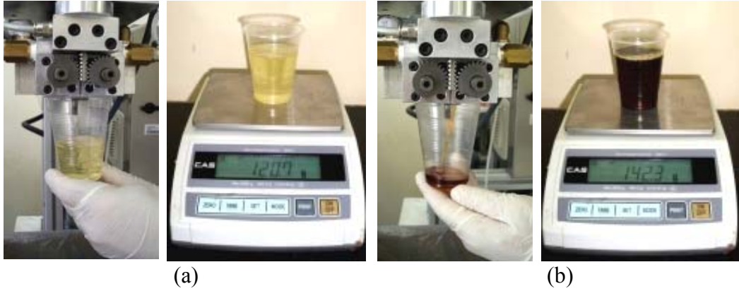
Şekil 3.16. Dozajlama işleminde döküm alıp tartılması (a) poliol ve (b) izosiyanat
