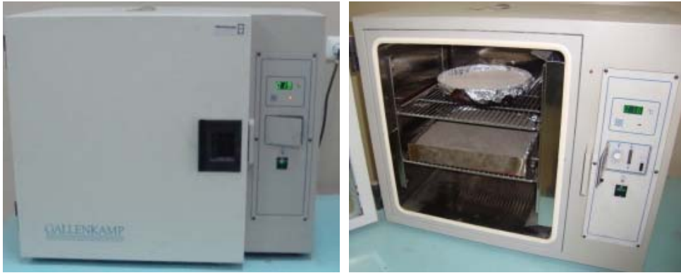
Şekil 3.3. Katkı ve dolgu maddelerinin fırında kurutulması
