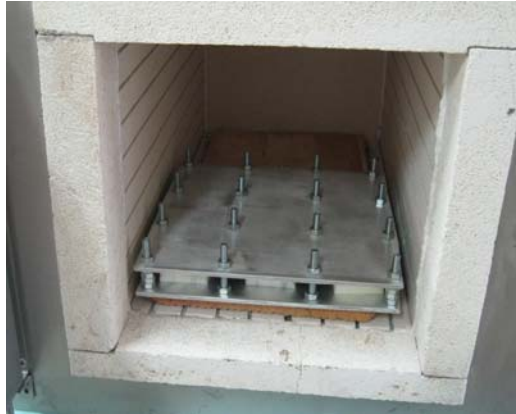
Şekil 3.52. Sabit deformasyon basma deney aparatının fırına yerleştirilmesi
