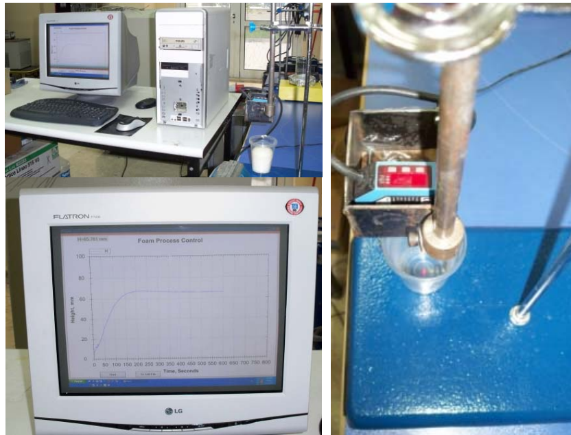
Şekil 3.55. Lazer ile yükselme miktarı ve yükselme hızı ölçüm sistemi
