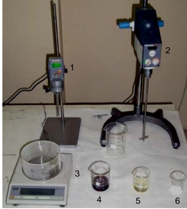
1. Homojenizatör, 2. Mekanik karıştırıcı, 3. Hassas terazi, 4. İzosiyanat, 5. Poliöl, 6. Katkı maddesi
