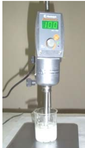
Şekil 3.7. Poliöl ile katkı maddesinin homojenize edilmesi
