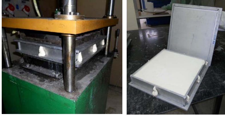
Şekil 2.8. Poliüretan köpüğün kalıp içerisinde ısıtmalı pres altında üretimi
