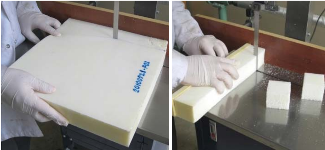
Şekil 3.32. Basma numunelerinin testerede kesilip hazırlanması
