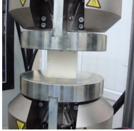
Şekil 3.34. Basma çenelerine numune yerleştirilmesi
