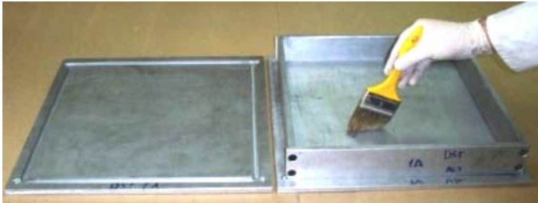
Şekil 3.9. Kalıp iç yüzeylerine kalıp ayırıcı sürülmesi
