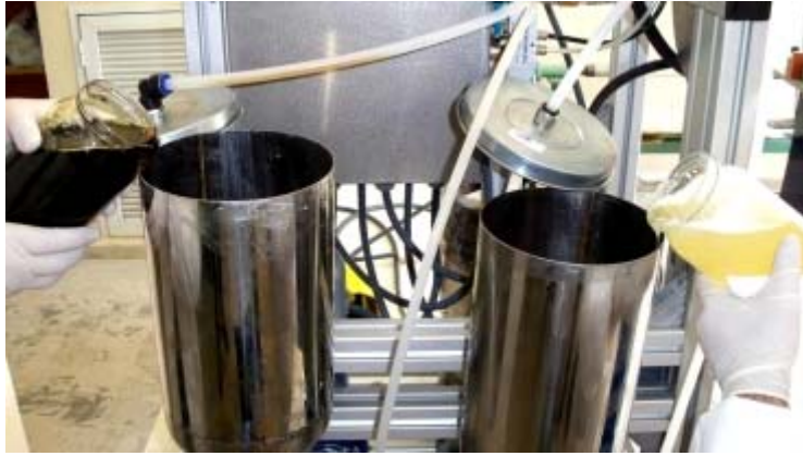
Şekil 3.13. Tanklara poliöl ve izosiyanat eklenmesi
