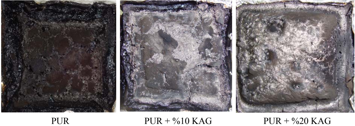
Şekil 4.36. KAG ilaveli PUR malzemelerin konik kalorimetre yanma testi sonrasındaki görüntüleri
