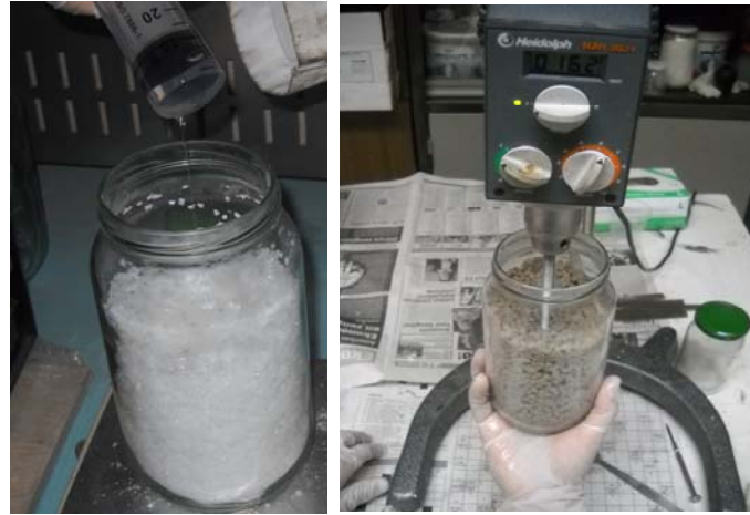
Şekil 3.22. TPU ve PP karışımına silikon yağı ilavesi ve doğu maddesinin karıştırılması
