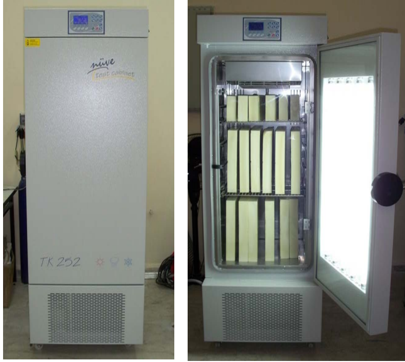
Şekil 3.24. Şartlandırıcı ünitesi ve üretilen malzemelerin şartlandırıcıya yerleştirilmesi
