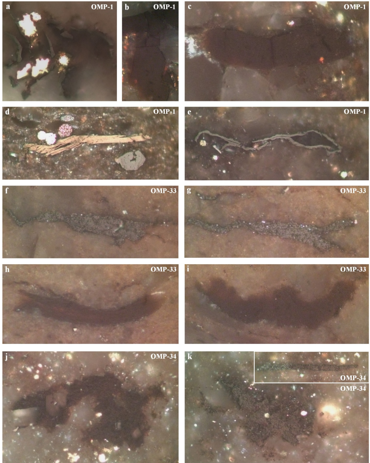
Şekil 28. Doğu Toros Otoktonu Yığıltepe Formasyonu (OMP-1), İstanbul-Zonguldak Birliği Yılanlı Formasyonu (OMP-33) ve Fındıklı Formasyonu (OMP-34) parlatılmış kesit örneklerinde belirlenen organik madde türleri. (a) Vitrenit benzeri bitüm ve taze (oksidlenmemiş) piritler, (b-c) İri masif bitümler, (d) Bükülmüş, grafitleşmiş detritik organik madde, inertinit ve framboyidal piritler, (e) Alginit ve framboyidal piritler, (f-g) Bozunmuş/oksidlenmiş (decomposed) bitüm, (h-j) Migrabitüm ve taze piritler, (k) Bozunmuş/oksidlenmiş (decomposed) migrabitüm ve taze piritler.
