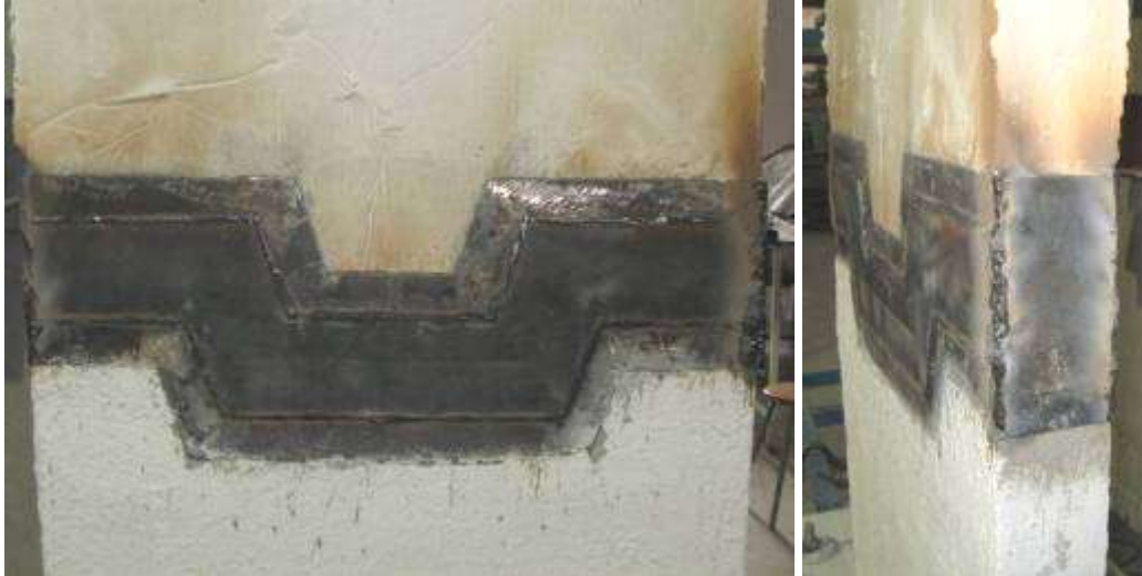
Şekil 3.63. TİP1 Modeli bağlantı ve alın levhalarının kaynaklı teşkili
