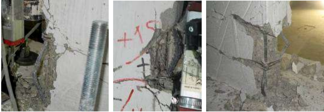
Şekil 4.5. Boyuna donatıda burkulma ve kopma davranışı
