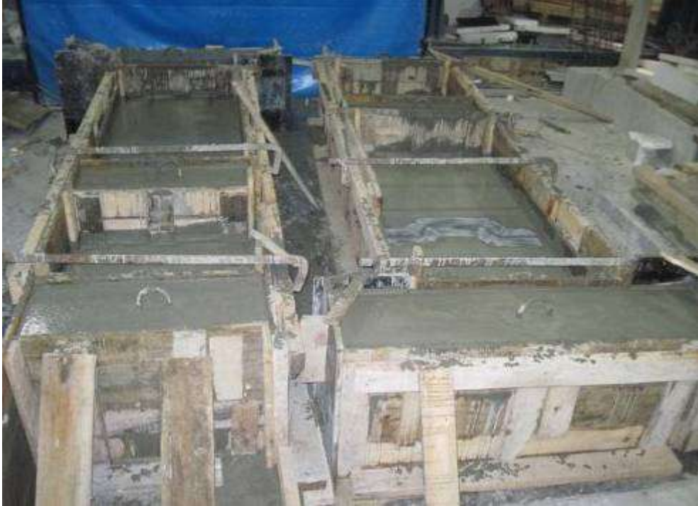
Şekil 3.49. Referans Model ve TİP1 Modeli beton döküm sonrası
