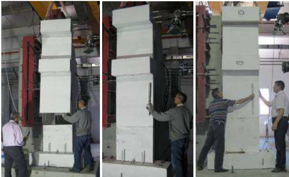
Şekil 3.60. TİP3-1 ve TİP3-2 Modeli üst panel ankrajlı olarak birleşirken
