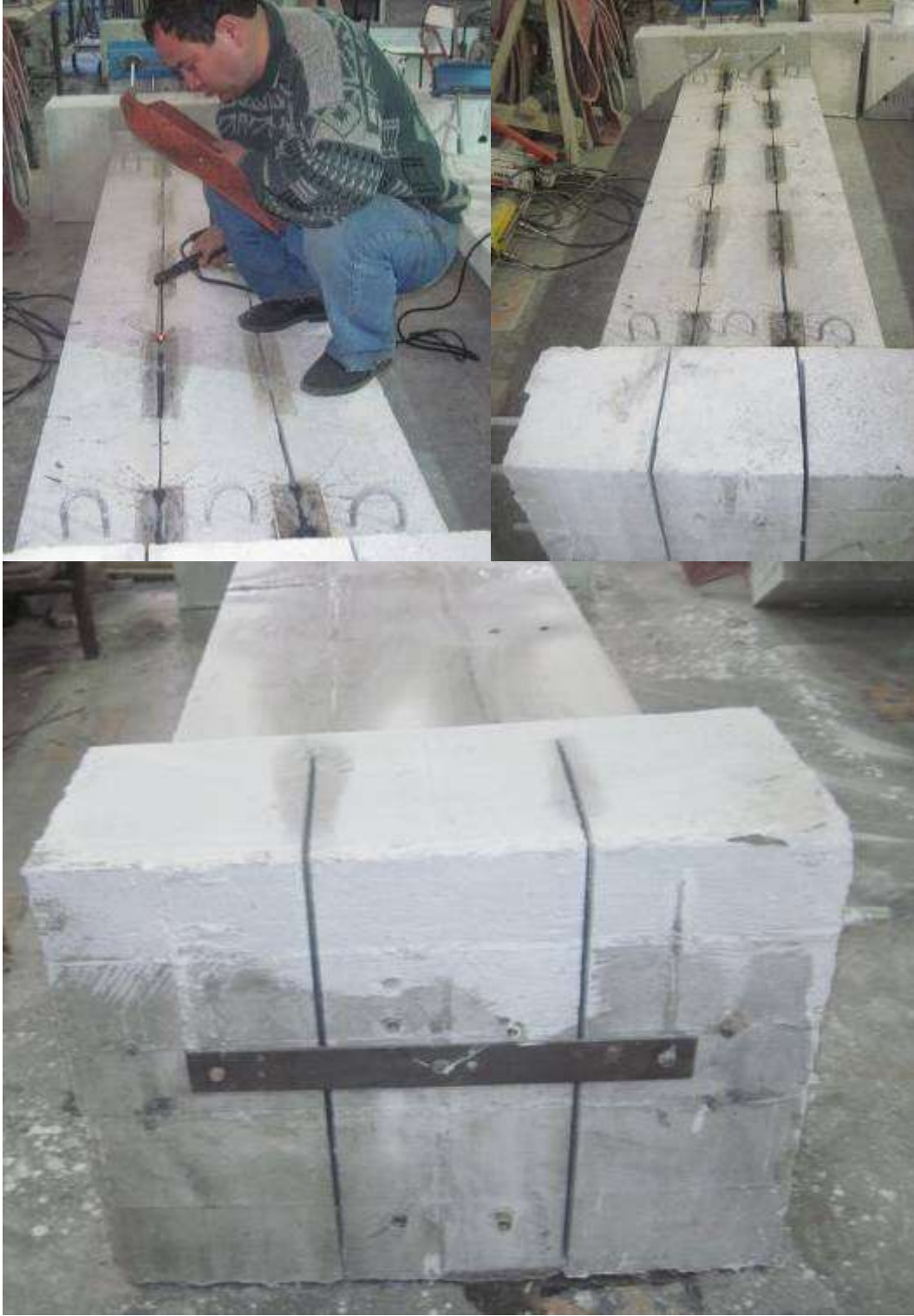
Şekil 3.55. TİP5 Modelinin kaynaklı düşey bağlantı detayı
