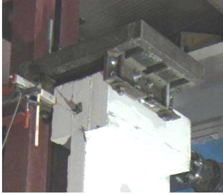
Şekil 3.69. Yanal hareketi önleyici kayıcı mesnetler
