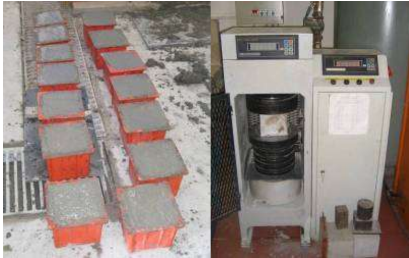
Şekil 3.31. Beton küp numuneleri ve tek eksenli basınç testi
