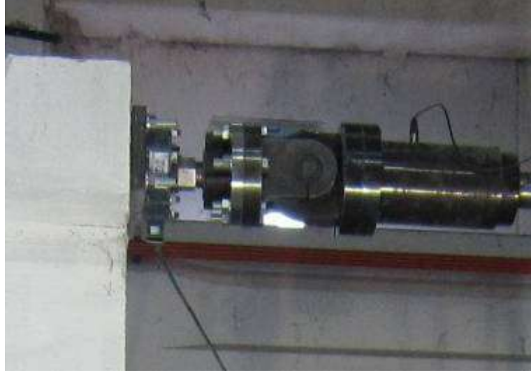
Şekil 3.68. Yükleme pistonu ucunda oluşturulan mafsalsal bağlantı
