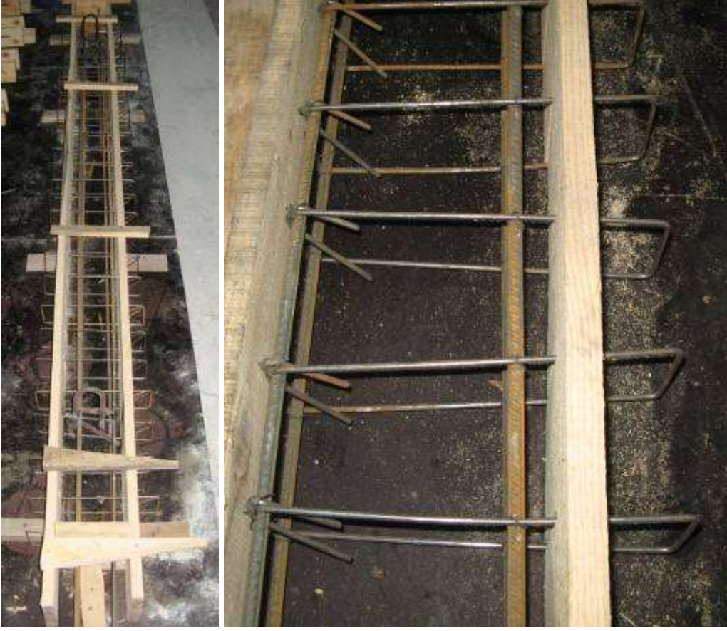
Şekil 3.56. TİP6 Modeli boyuna ve enine donatıların düzenlenmesi
