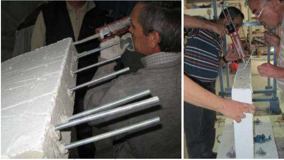
Şekil 3.59. TİP3-1 ve TİP3-2 Modeli epoksi ankrajı yapılırken
