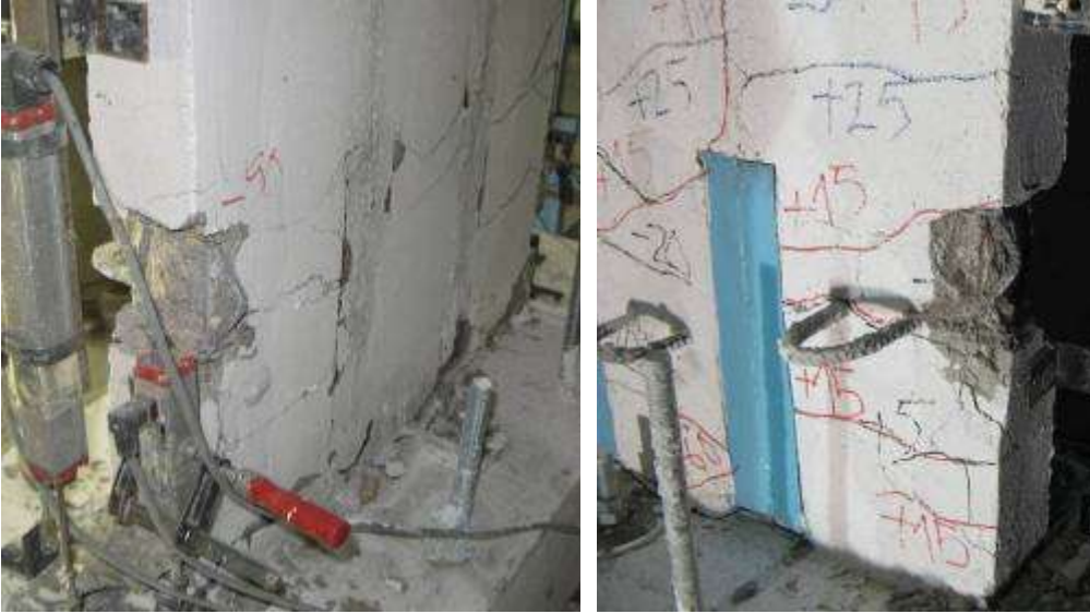
Şekil 4.36. -98 mm tepe deplasmanında basınç bölgesindeki donatıda burkulma davranışı.
