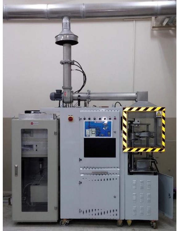
Şekil 1: Konik kalorimetre test cihazı.
