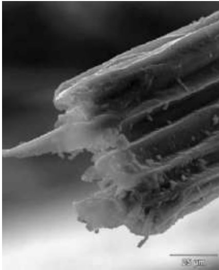
Şekil 4.7: Gerilim altında kopmuş bamyalı lifinin yanıl SEM görüntüsü (De Rosa vd., 2010).
