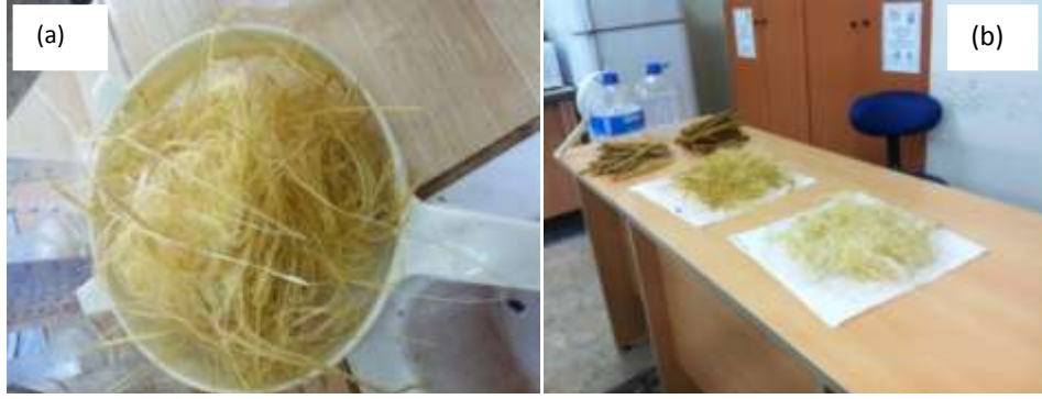
Şekil 5.2: a) Odunsu kısımlarından ayrılarak elde edilmiş bamya lifleri b) Bamya liflerinin kurutulması
