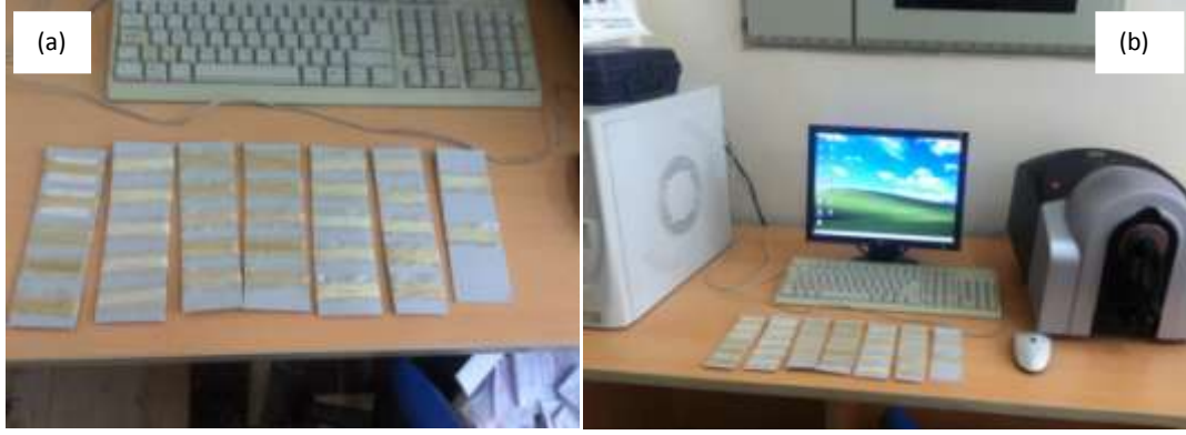
Şekil 5.9: a) Renk ölçümü için hazırlanan bamyalı lifleri b) Datacolor renk ölçüm cihazı
