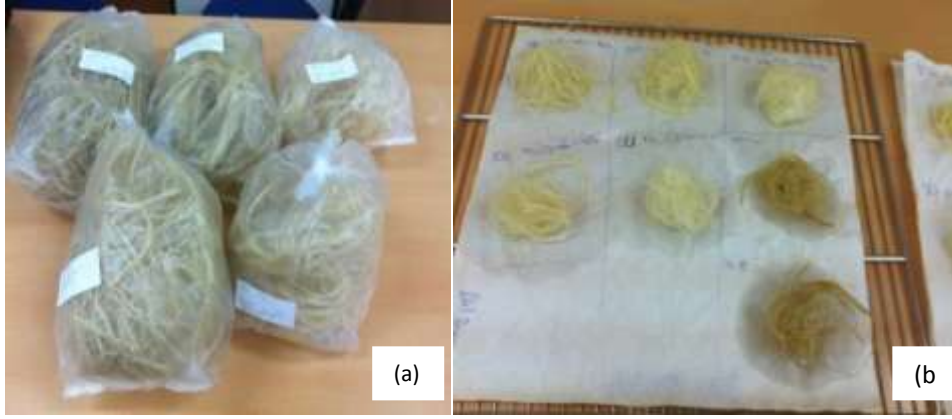
Şekil 5.4: a) Elde edilen 5 çeşit ham bamyalı lifleri b) Liflere kimyasal işlem uygulama aşaması
