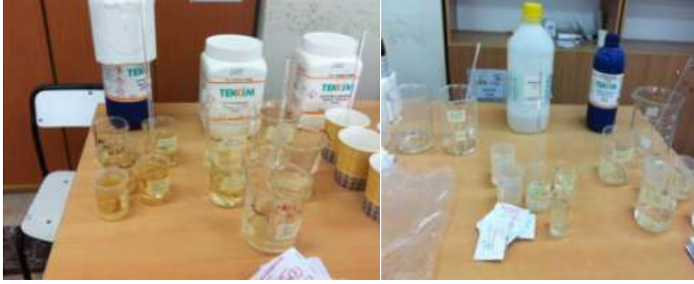
Şekil 5.10: Bamyalı liflerinin kimyasallara karşı dayanımlarının ölçümü
