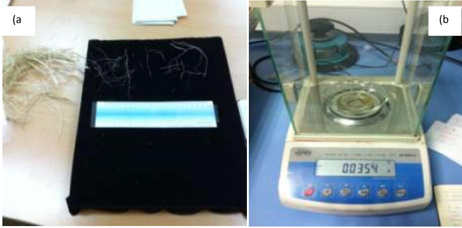
řekil 5.5: Lineer yoęunluk ölçüm aşaması a) Uzunluk ölçümü b) Aęırlık ölçümü
