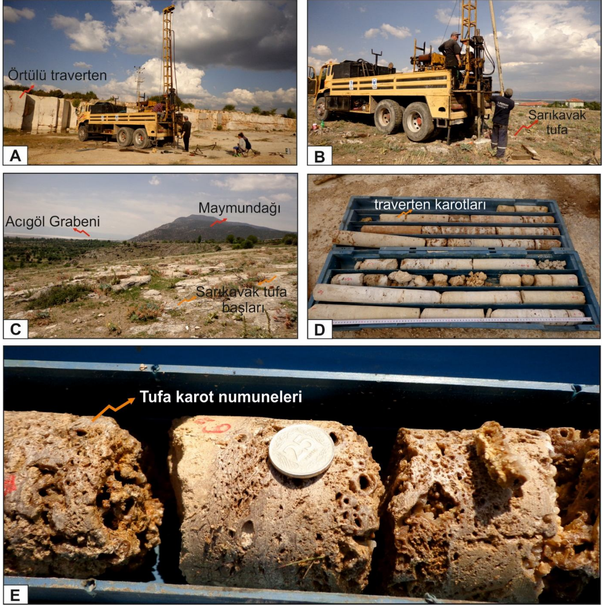
Şekil 24. (A ve B) Örtülü travertenleri ve Sarıkavak tufa alanlarında yapılan sondaj çalışmaları. (C) Sarıkavak tufa başlarının arazideki görünümü. (D) Sondajlardan elde edilen karot numuneleri. (E) Tufa karot numunelerinin yakından görünümü.
