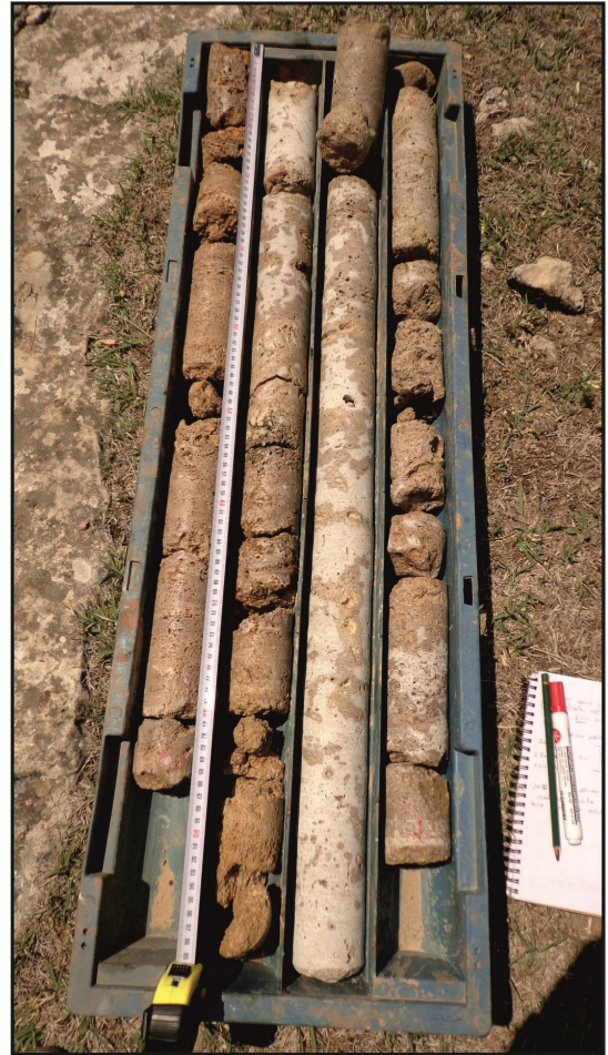
Şekil 21. Sarıkavak tufa çökellerinden alınan beşinci sondaj karotunun ölçülü stratigrafik kesiti (SL-5) ve örnek numaraları.
