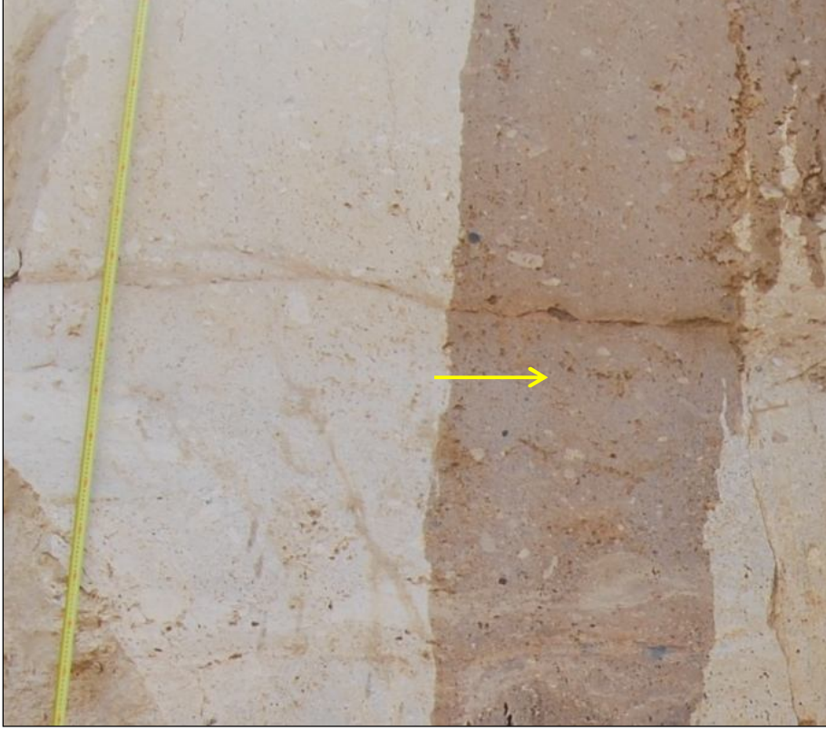
Şekil 31. Örtülü terkedilmiş traverten ocağından alınan ÖT-4 örnek seviyesi (üstte, sarı ok ile gösterilmiştir).
