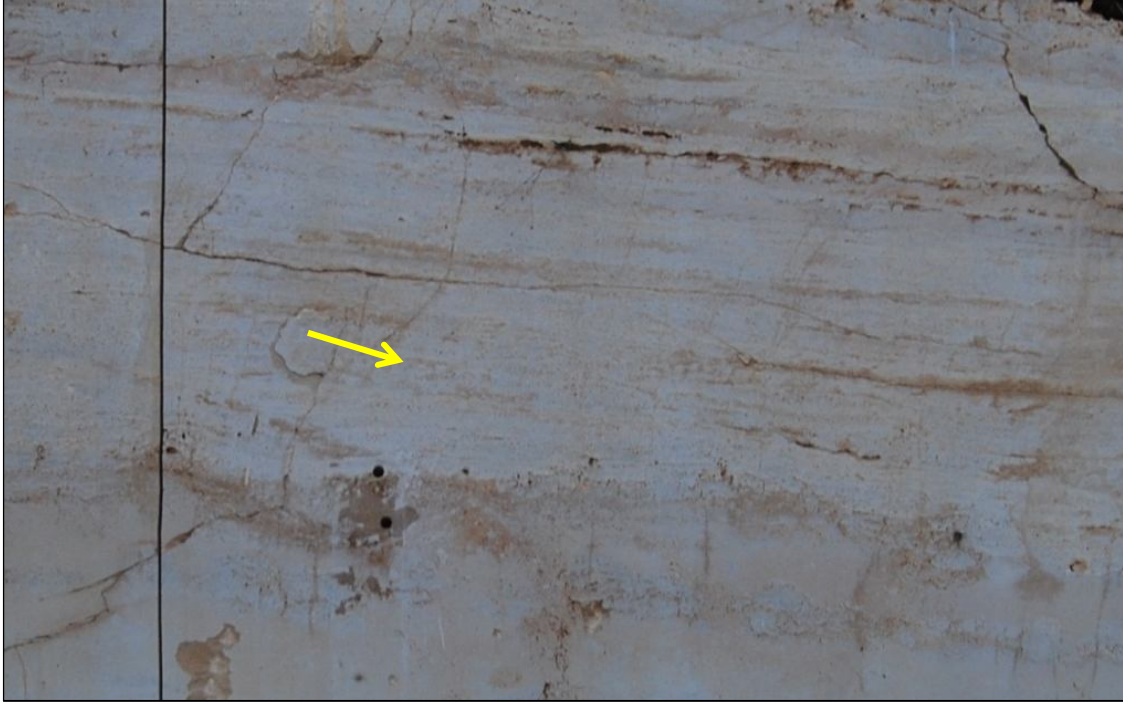
Şekil 44. Örtülü terkedilmiş traverten ocağından alınan ÖT-11 tapa örnek seviyesi (üstte, sarı ok ile gösterilmiştir).
