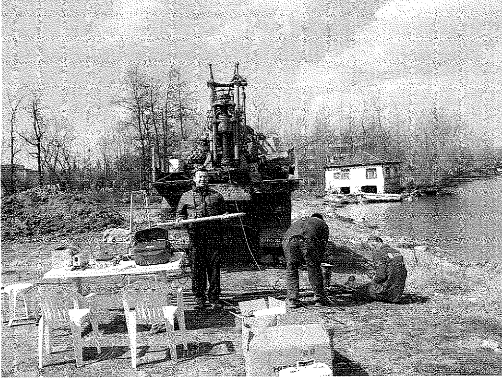
Şekil 25. Deney sahasında SPT kamyonu ve proje yürütücüsünün elinde VPT aleti
