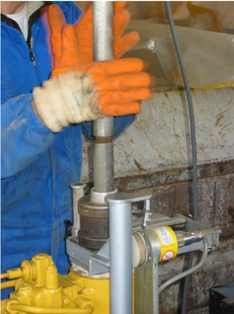
(c) Yerleştirilen VPT aletinin arkasına itirme çubukları takılırken
