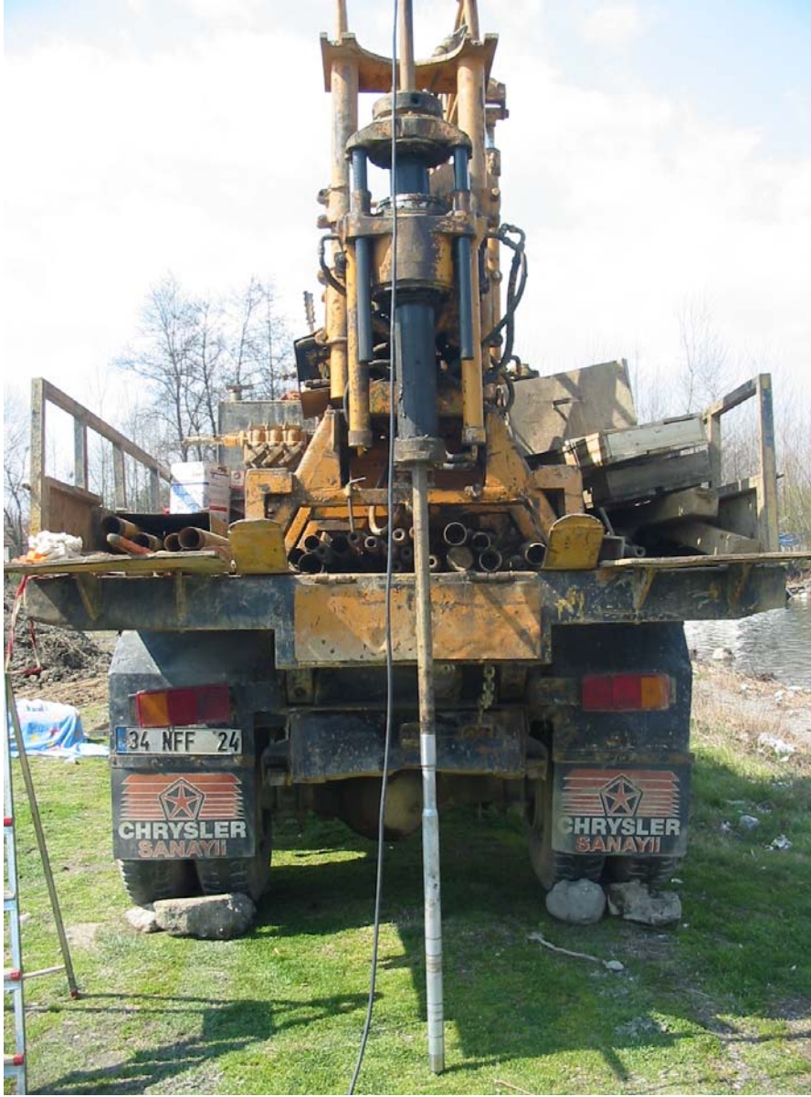
Şekil 23. VPT aleti SPT hidrolik ünitesi ile zemine ittirilirken
