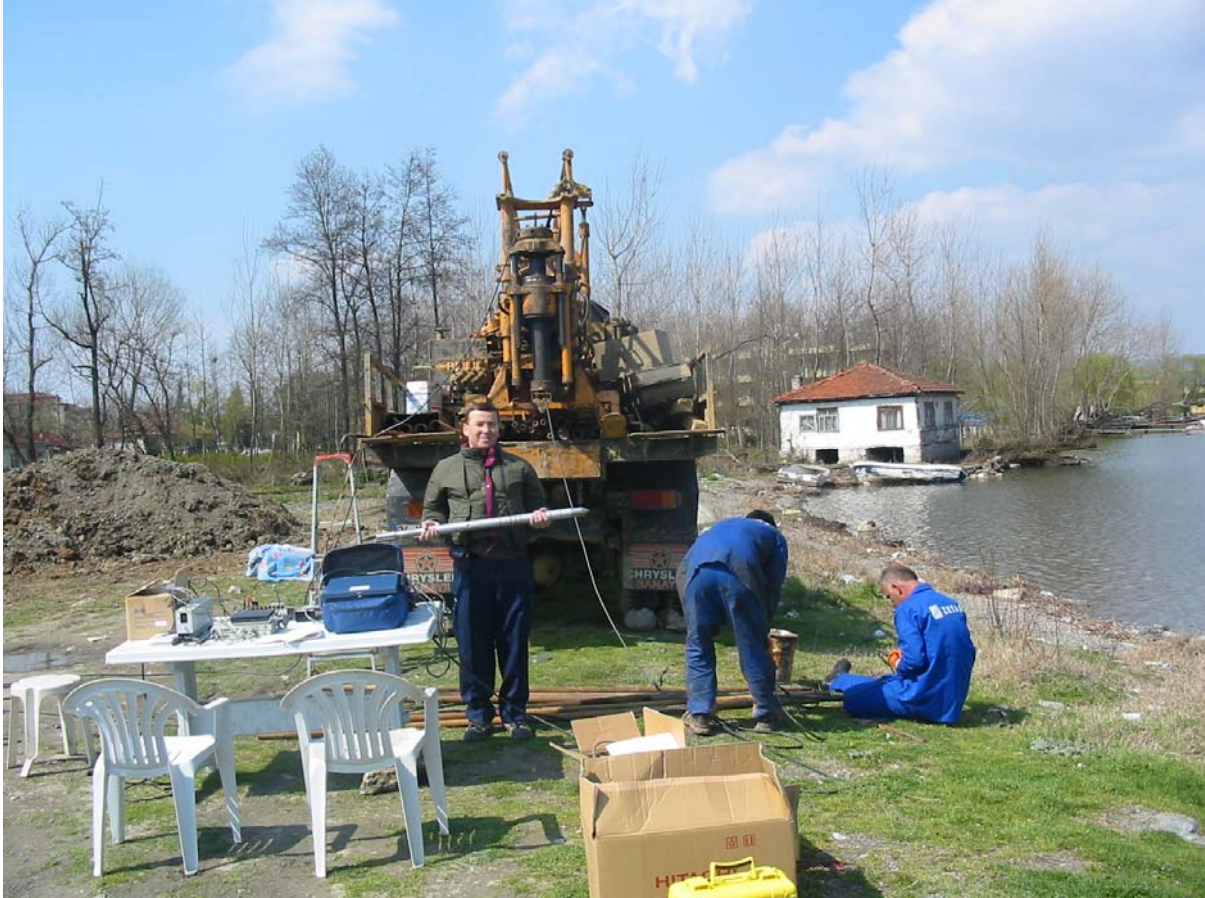
Şekil 22. Deney sahasında SPT kamyonu ve proje yürütücüsünün elinde VPT aleti
