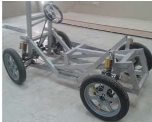
Şekil 7.14 İmalatı gerçekleştirilen araç prototipi.
