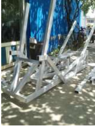
Şekil 7.7 Gerçekleştirilen şasi imalatı
