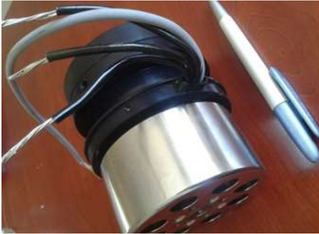
Şekil 5.1 Dıştan rotorlu BLDC senkron motor.
