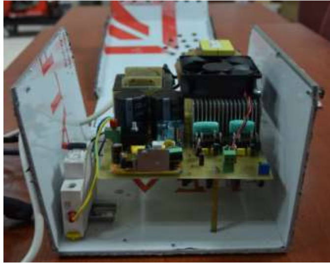
Şekil 4.16 Uygulama devresi şarj cihazının kutu içerisindeki nihai hali
