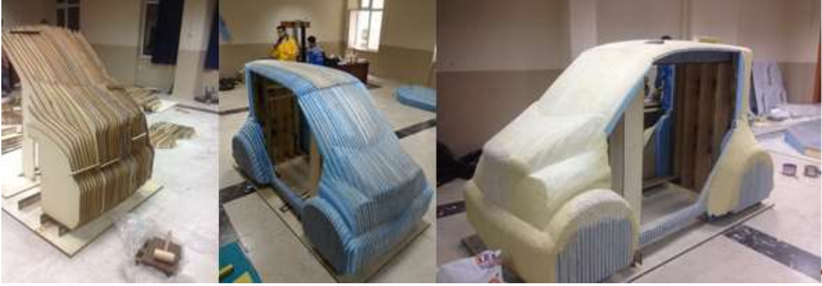
Şekil 7.16 Cam elyaf kabuk kalıbı imalat aşamaları
