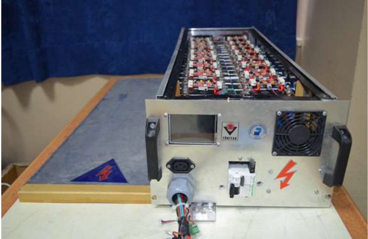
Şekil 2.13 Tasarım ve imalatı tamamlanmış batarya sistemi
