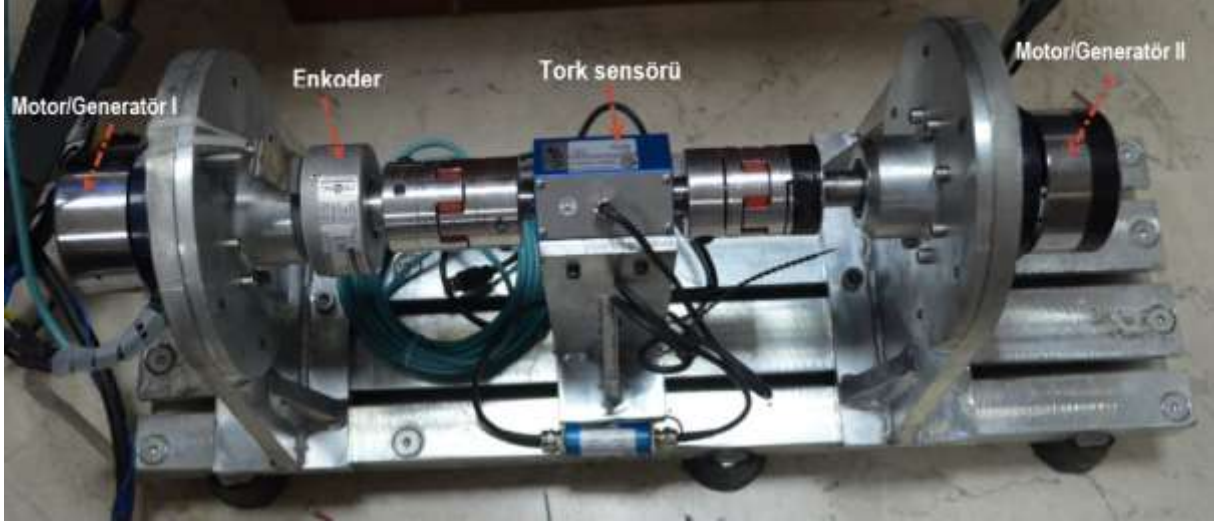
Şekil 5.60 Motor yükleme deney seti
