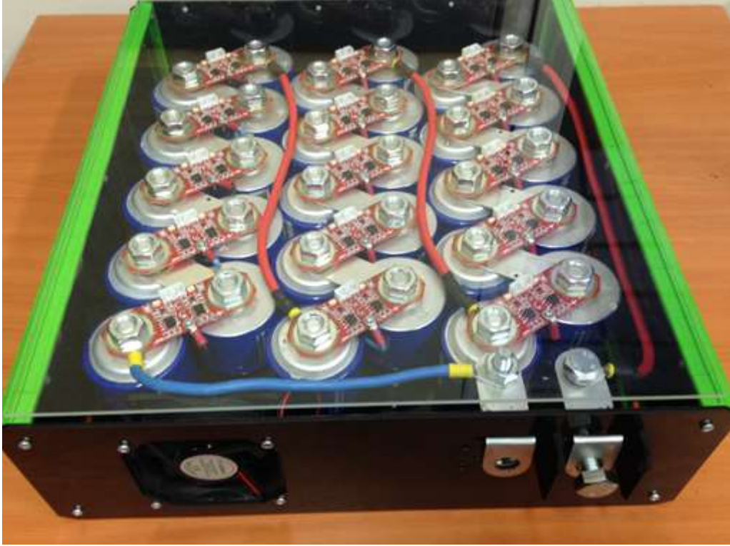
Şekil 2.19 Ultrakapasitör hücrelerini montajlı hali ve koruma kutusu
