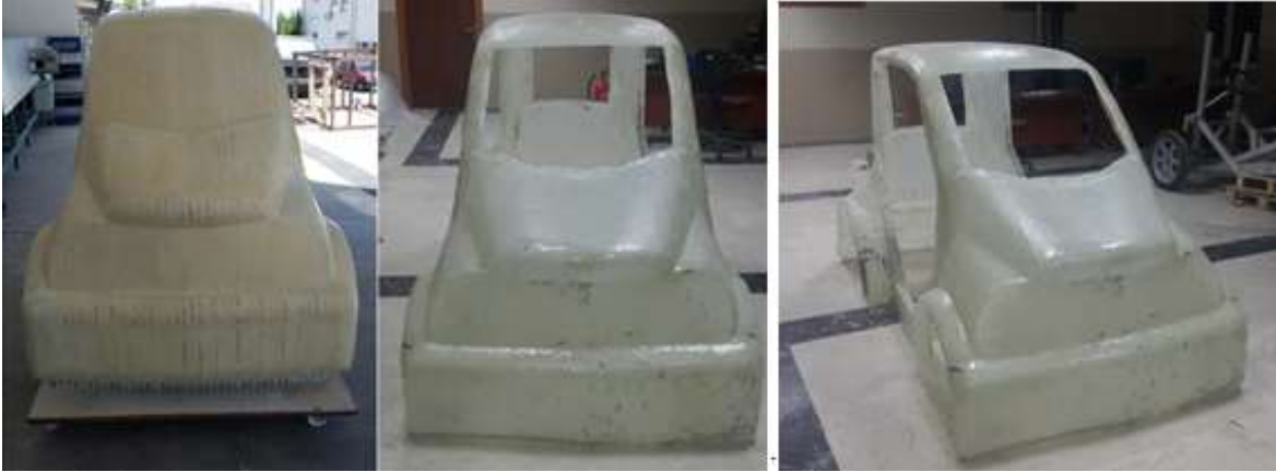
Şekil 7.17 İmal edilen kalıp ve cam elyaf kabuk.
