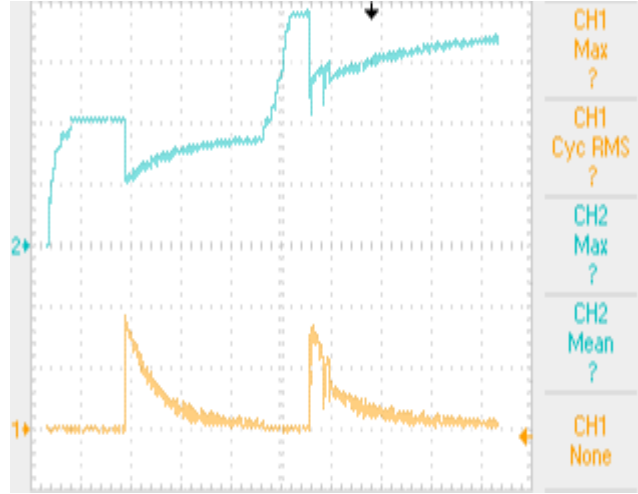
Şekil 5.59 Ultrakapasitörün sıfır gerilim seviyesinden başlayarak değişken motor devrine göre şarj edilmesi
