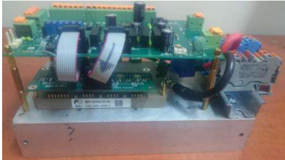
Şekil 5.9 Elektrikli araç ALATAY-EV için tasarlanan sürücünün farklı perspektiflerden resimleri
