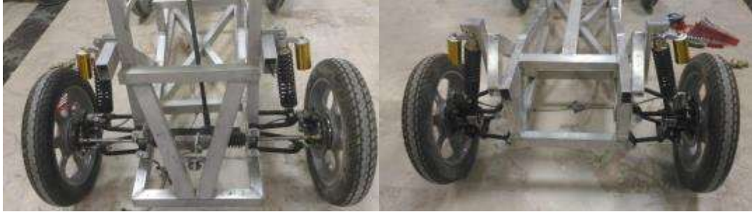
Şekil 7.12 Ön ile arka askı donanım ve direksiyon sistemi
