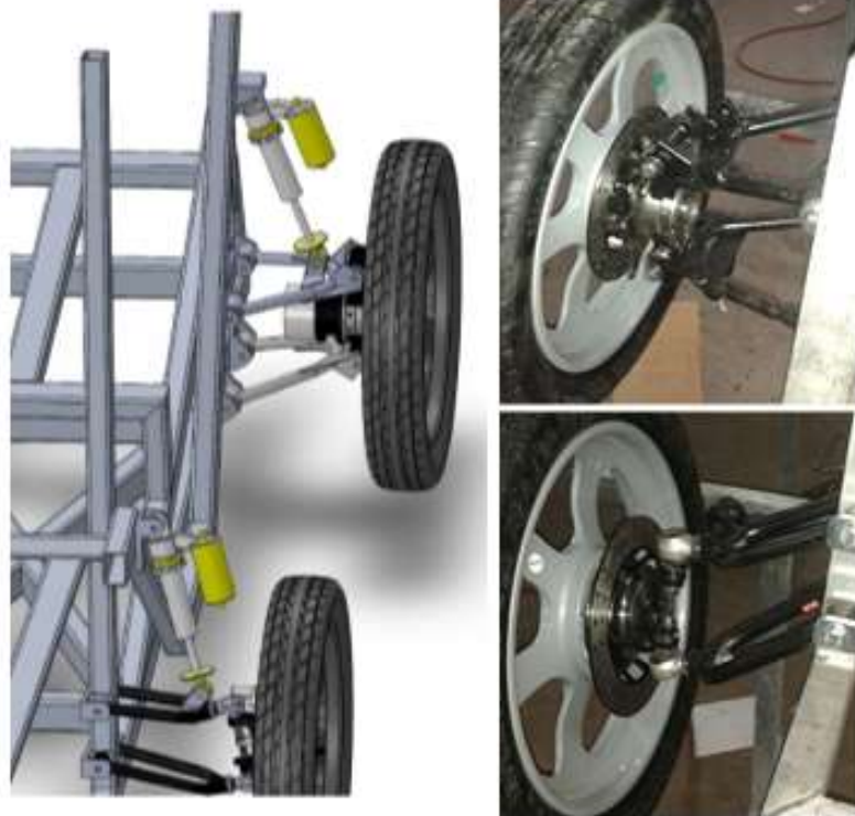
Şekil 7.9 Tasarım ve imalat sonrası askı sistemi
