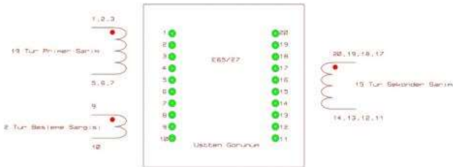
Şekil 4.3 Tasarlanan trafo sarım şeması
