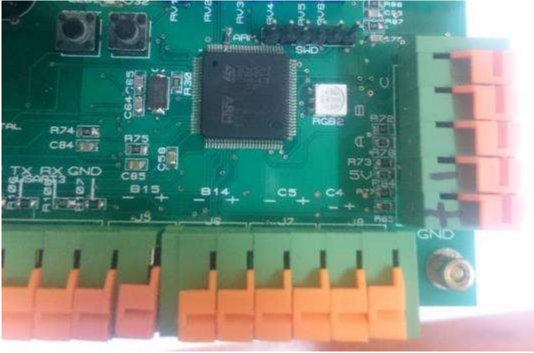
Şekil 5.8 İşlemcinin (STM32F407VGT6) devre üzerinde yerleşimi
