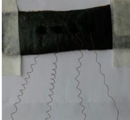
Şekil 3.15. Tekstil esaslı uzama sensörü
