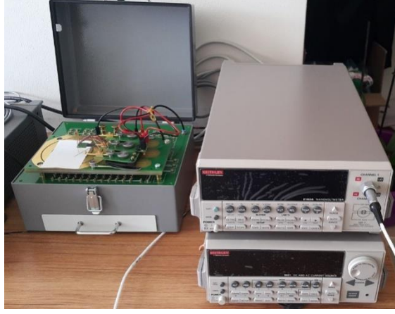
Şekil 3.14. DC Delta Mode ölçüm sistemi ve 4-Probe sistemi adaptör kutusu
