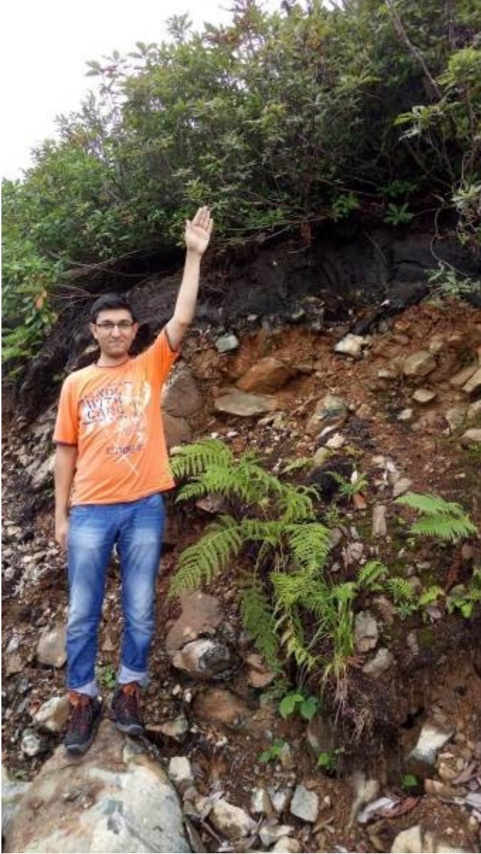
Şekil 80: Yol amaçlı bölünmüş turbalıkta kalınlığını 50 cm ila 1 m arasında değişen turba.
