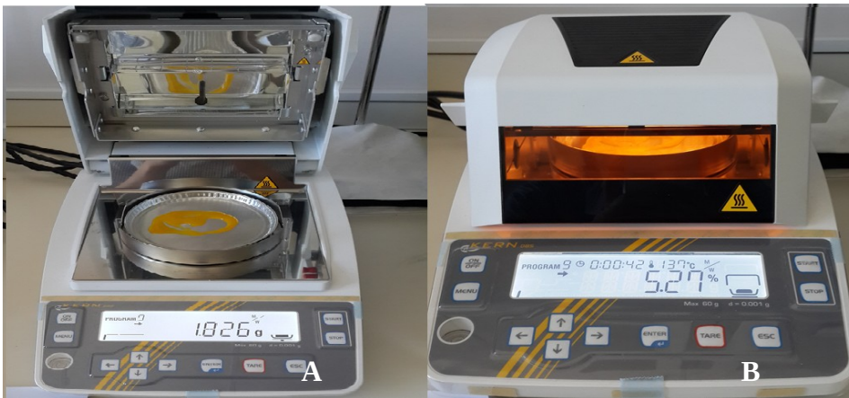
Şekil 4.3. Yaş yumurta örneklerde nem analizi, A: Nem analizörüne örneğin yerleştirilmesi, B: Nem tayini sırasında analizörün görüntüsü
