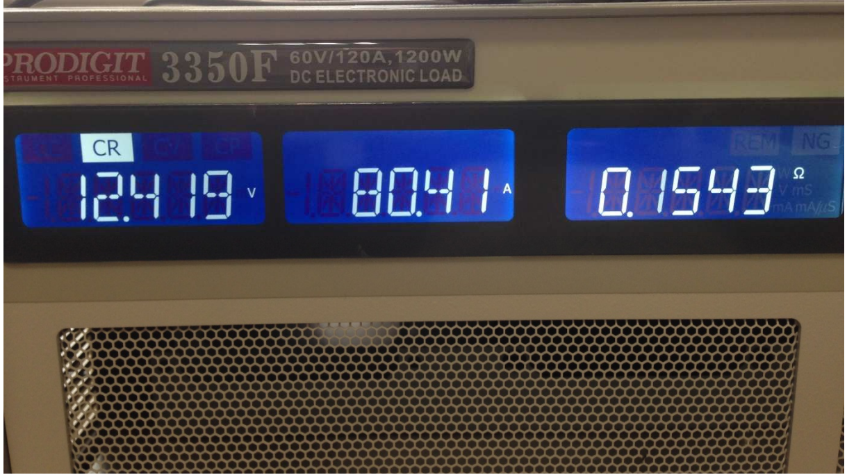
Şekil 41 Prototipin elektronik yük ekranında görünen çıkış gerilim ve akım değerleri.
