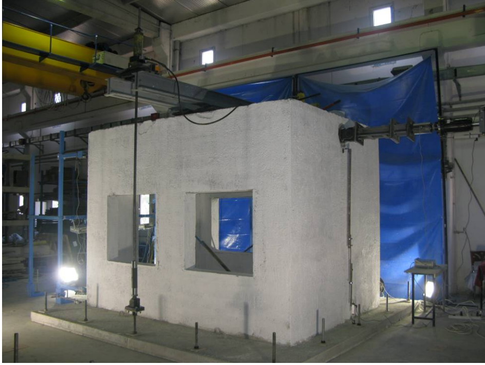
Şekil 6.105. Deney öncesi aksel yüklenmiş yapı
