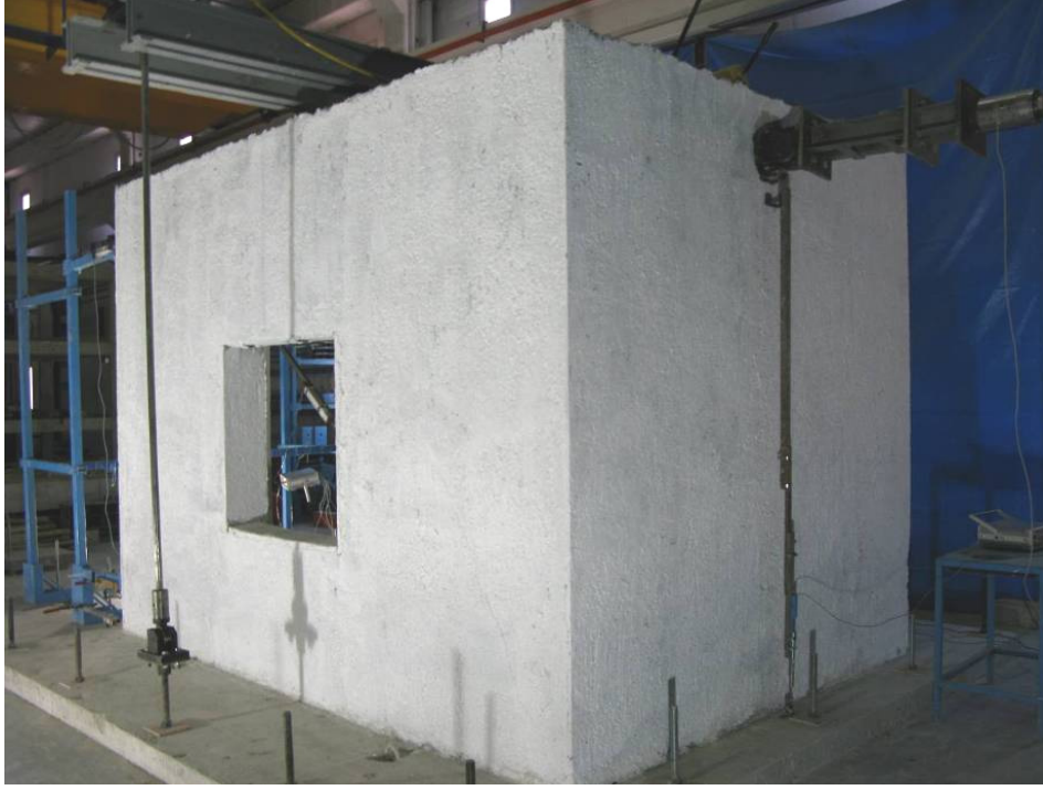
Şekil 6.95. Deney öncesi aksenal yüklenmiş yapı
