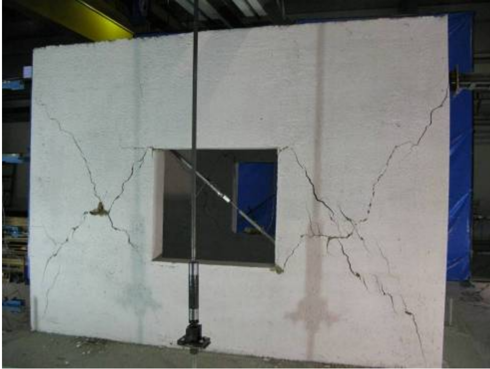
Şekil 6.80. İlerleyen çevrimlerde oluşan çatlaklar
