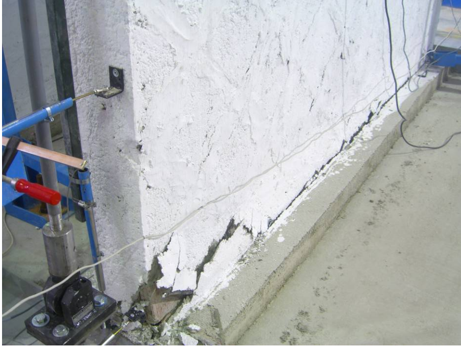
Şekil 6.36. Duvarda basınç eğilmesi
