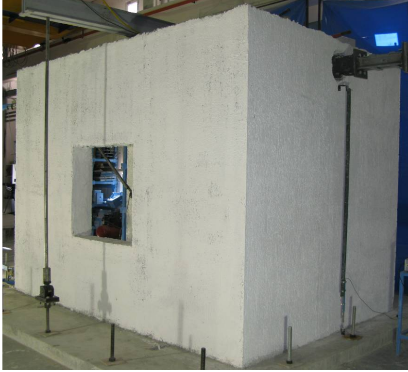
Şekil 6.85. Deney öncesi aksenal yüklenmiş yapı
