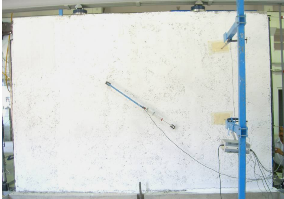
Şekil 6.16. Ardışık çevrimde eğilme çatlak
