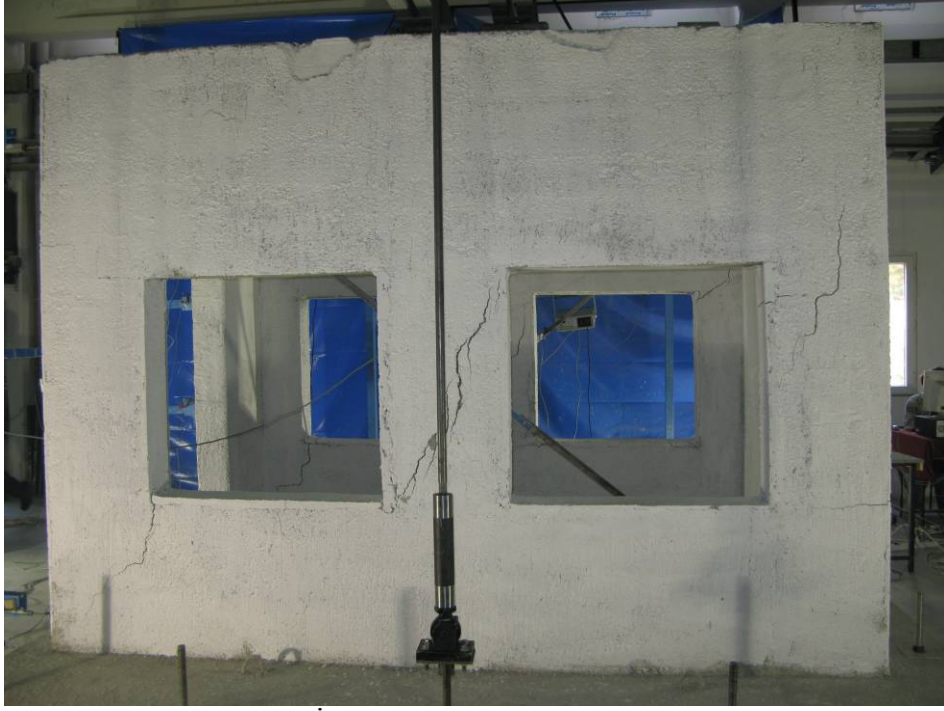
Şekil 6.107. İlerleyen çevrimlerde oluşan çatlaklar
