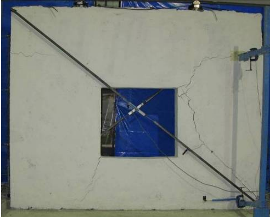
Şekil 6.54. GDPC1T Numunesinde hasarın gelişimi
