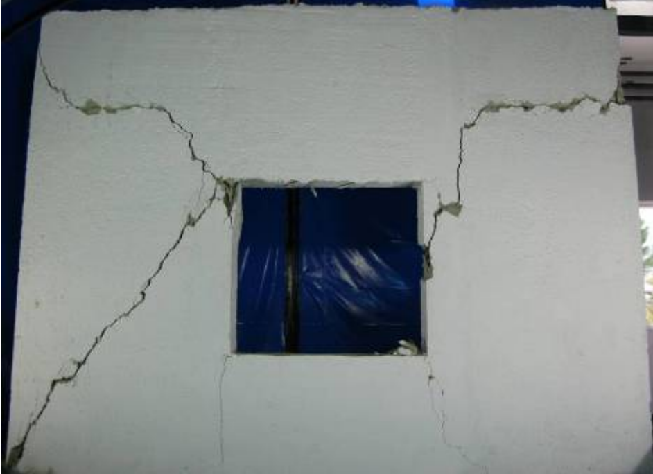
Şekil 6.70. Duvarın deney sonu görünümü
