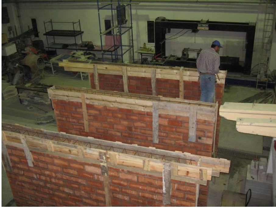
Şekil 3.24. Duvar üstü hatlı kalıbı
