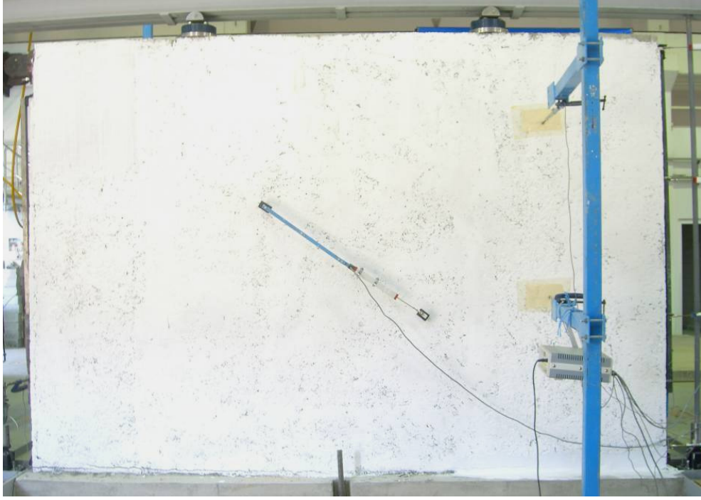
Şekil 6.15. Eğilme altında ilk çatlak oluşumu
