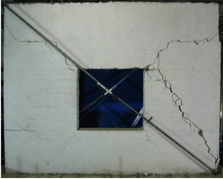
Şekil 6.65. Deneyin ilerleyen aşamalarında artan hasarlar
