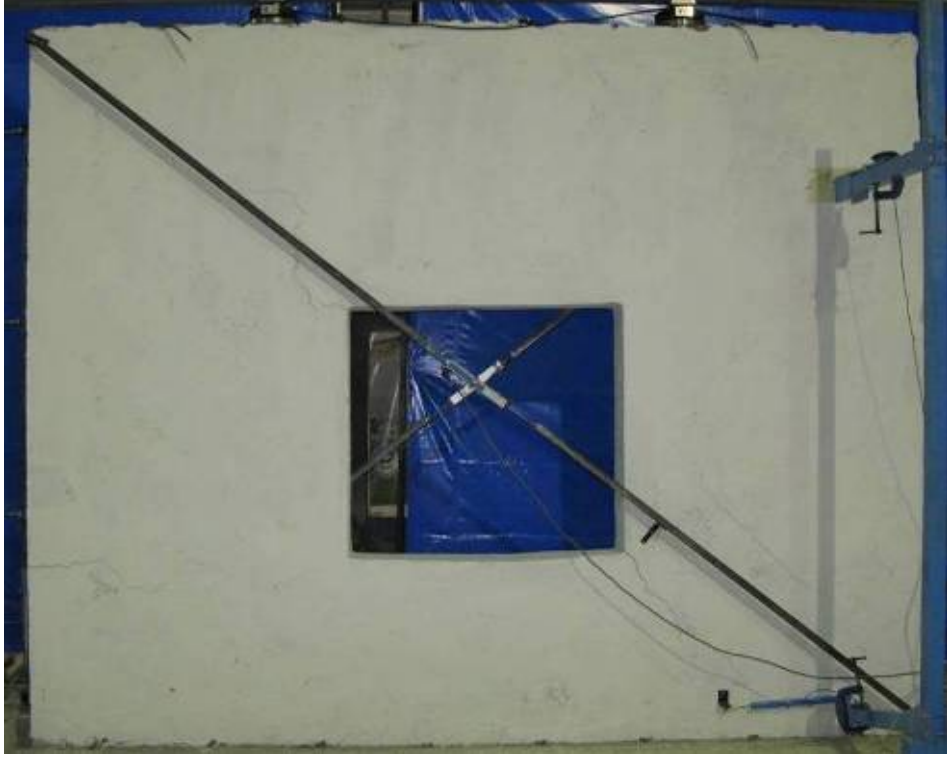
Şekil 6.53. GDPC1T Numunesinde ilk çatlakların oluşumu
