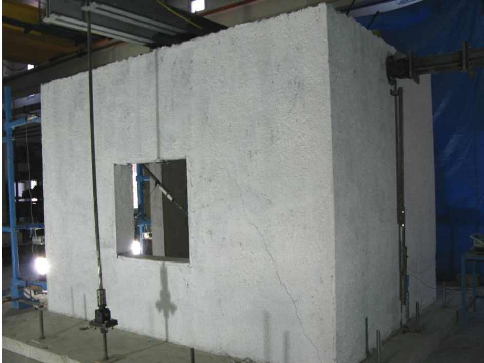
Şekil 6.96. İlk çatlak oluşumları
