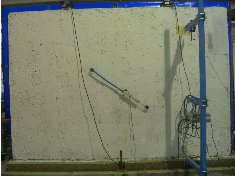
Şekil 6.31. Kayma yüzeyini oluşturacak eğilme çatlağı
