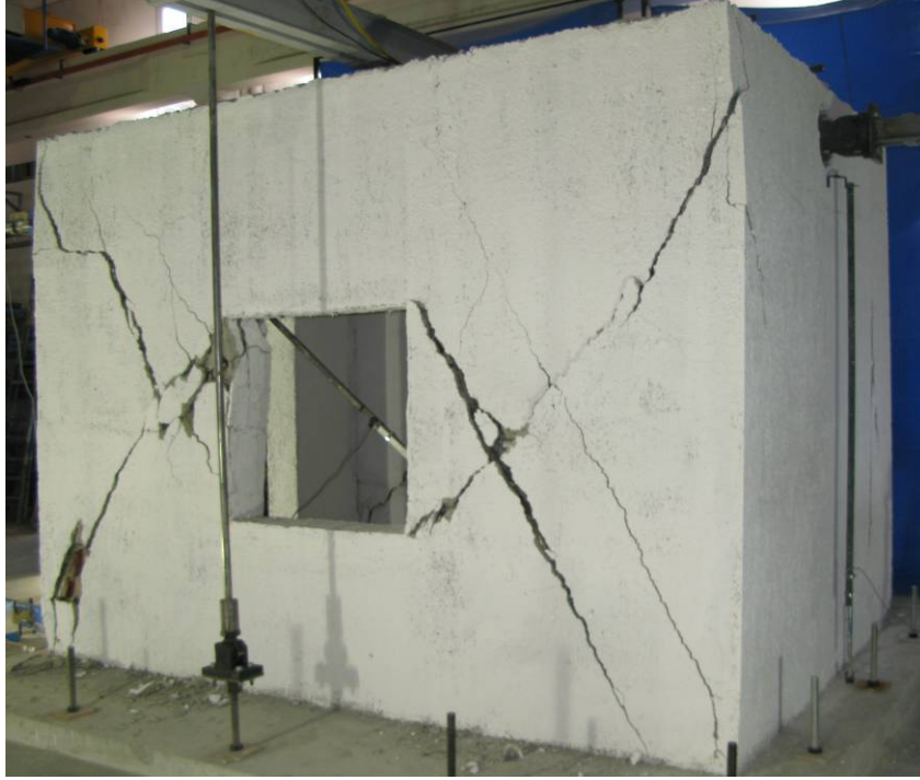
Şekil 6.88 Deney sonunda ortaya çıkan hasarlar
