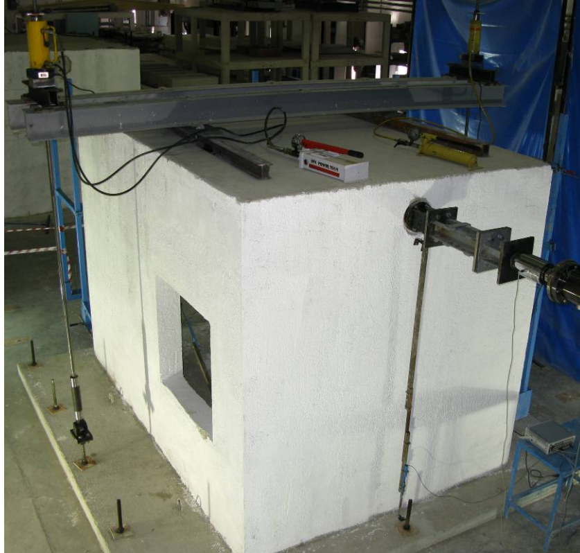
Şekil 6.100. Deney öncesi eksenel yüklenmiş yapı
