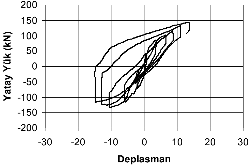
Şekil 6.37. Yatay yük-deplasman davranışı
