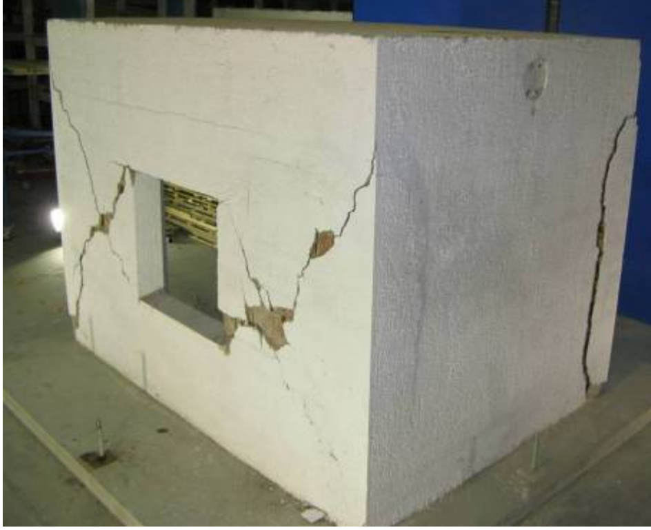
Şekil 6.81 Deney sonunda ortaya çıkan hasarlar
