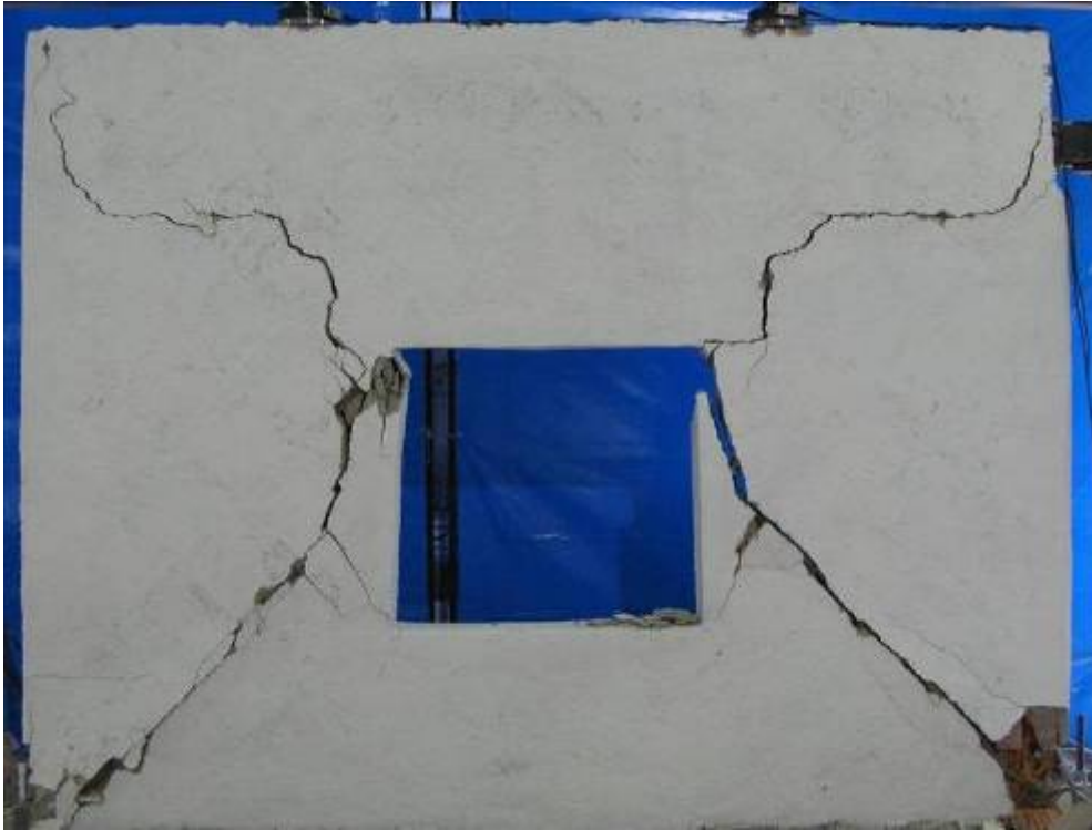
Şekil 6.58. Deney sonu görünüm
