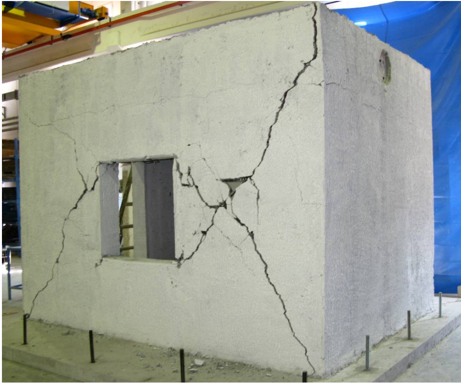
Şekil 6.98 Deney sonunda ortaya çıkan hasarlar
