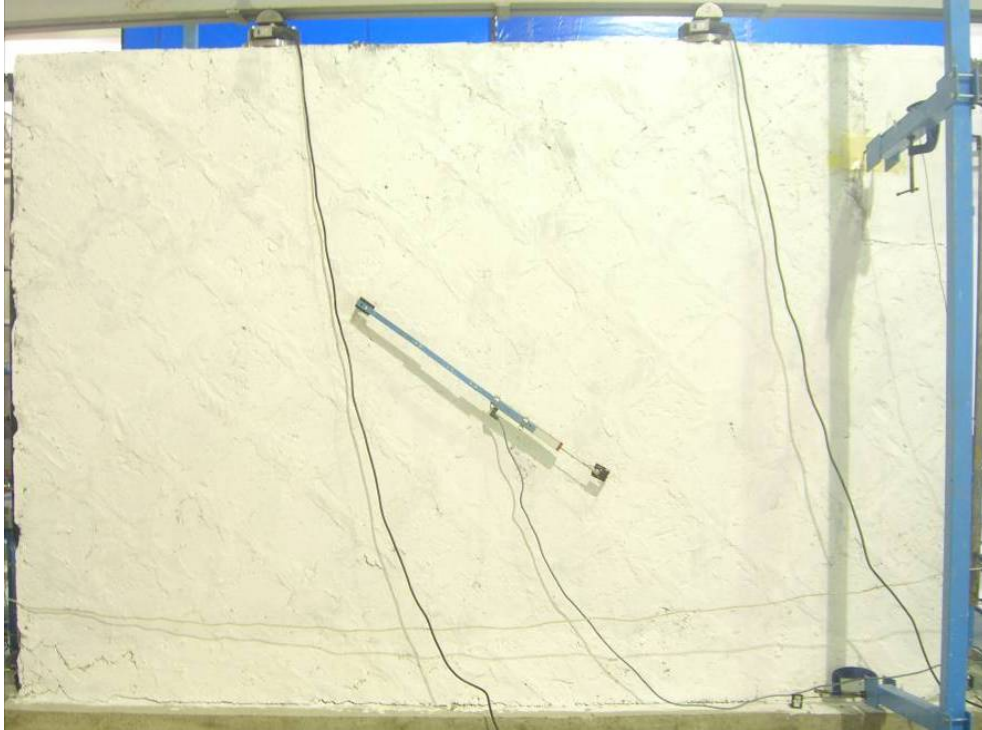
Şekil 6.35. Numune tabanında çatlak oluşumu
