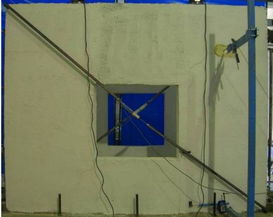
Şekil 6.44. Numunede oluşan ilk asal çekme çatlakları
