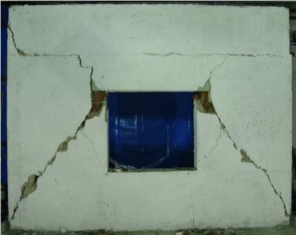
Şekil 6.50. Duvarın deney sonu görünümü
