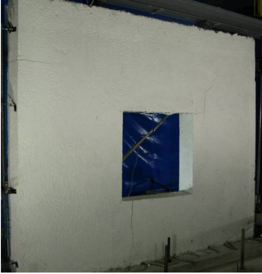
Şekil 6.69. Ardışık çevrimlerde oluşan çatlaklar
