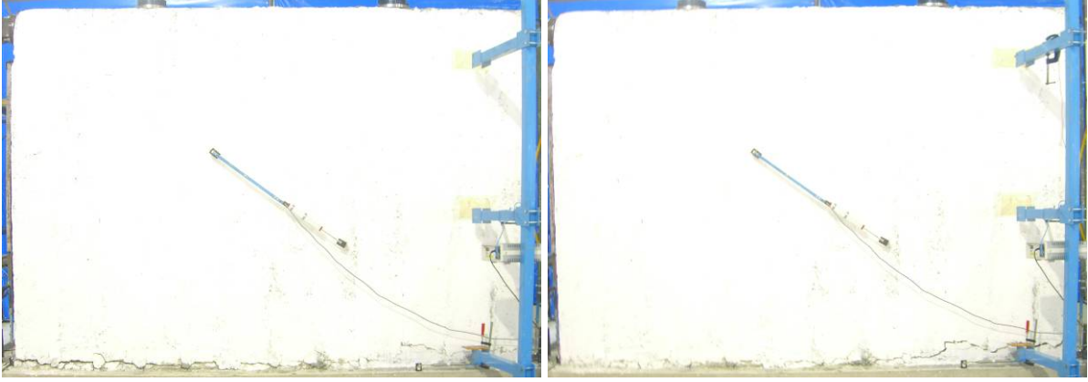
Şekil 6.25. Ardışık çevrimlerde oluşan çatlaklar
