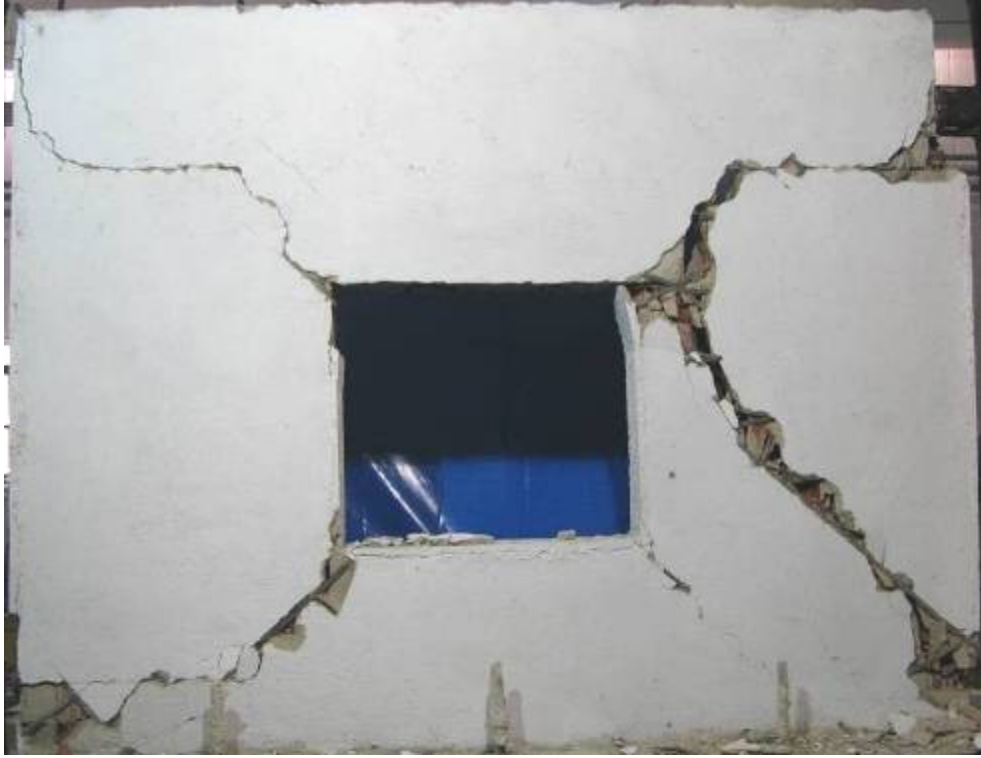
Şekil 6.61. Duvarın deney sonundaki görünümü
