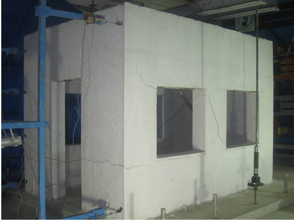
Şekil 6.111. İlk çatlak oluşumları
