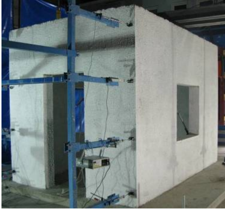
Şekil 6.78. Deney öncesi aksenal yüklenmiş yapı (YB1A)
