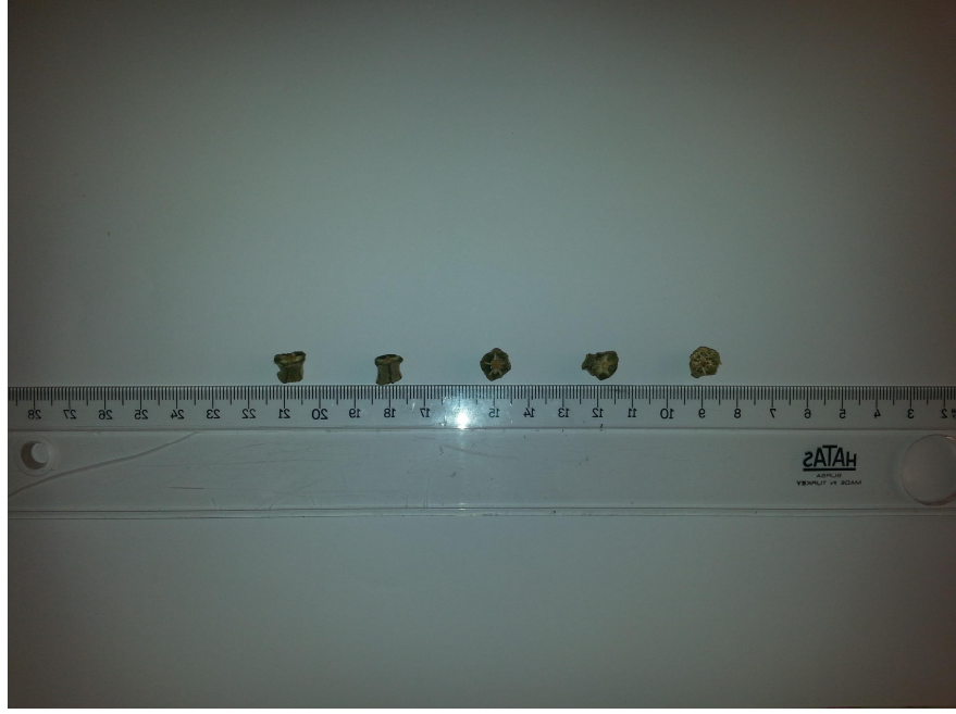
ekil C7. % 100 genlikte ultrasese 20 dakika süreyle tabi tutulmuş 70°C'de kurutulmuş bamyas örnekleri
