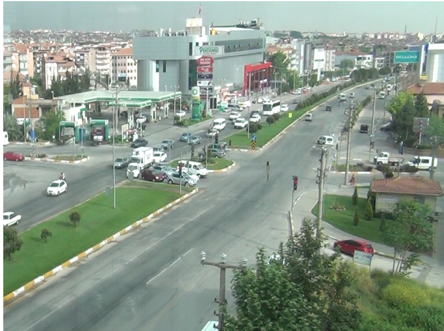
Şekil 4.1: Depolama Alanı Yetersizliği Görülen Sinyalize Dönel Kavşak
