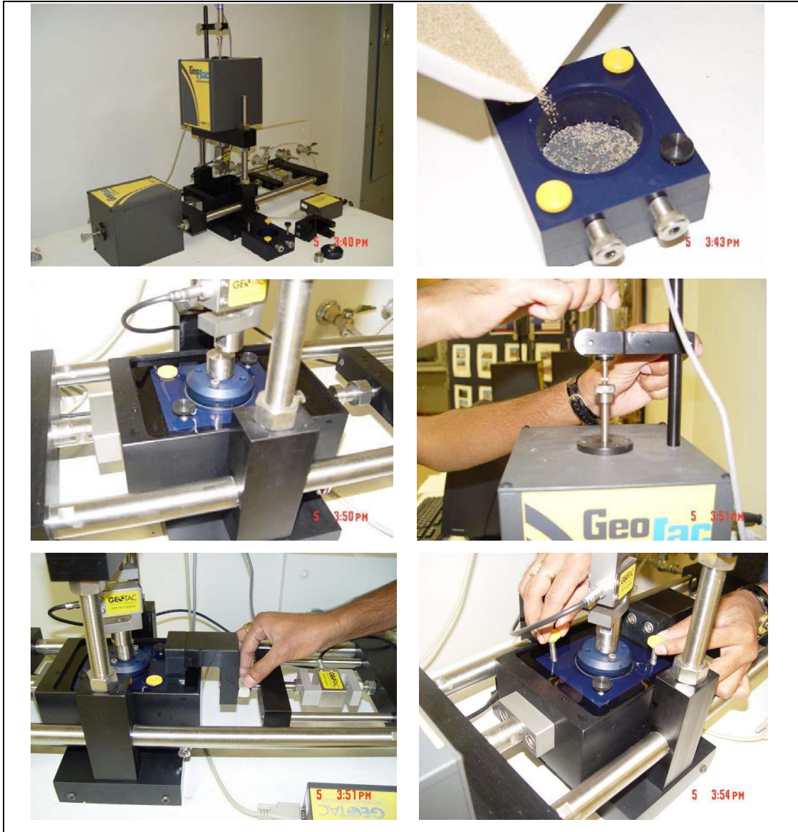
Şekil 3.2: Halka kesme kutusu deneyinin yapılış aşamaları (Teksas Üniversitesi Jeoteknik Mühendisliği Laboratuvarı)
