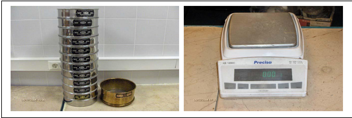
Şekil 3.5: Elek analizi seti ve terazi
