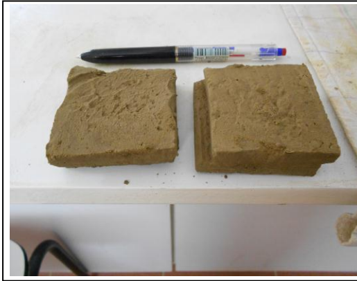
Şekil 4.5: Drenajlı koşulda kesilmiş kumlu kil örnekleri
