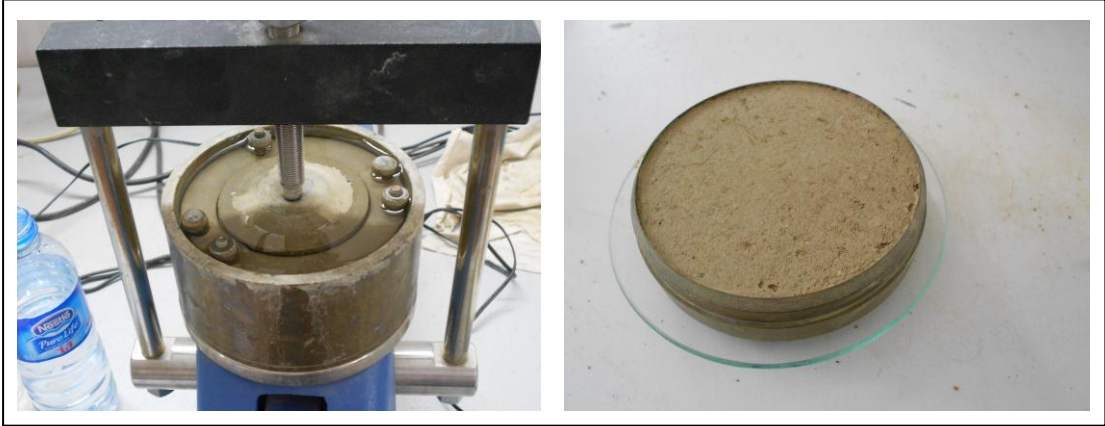
Şekil 3.8: Konsolidasyon deneyi devam ederken deney düzeneği
