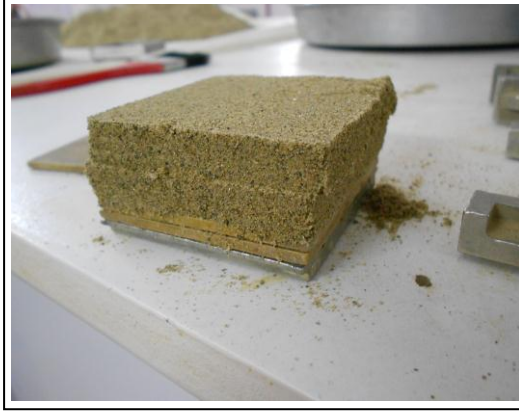
Şekil 4.7: 40 No'lu elek üstüne ait drenajlı durumda kesilmiş numune
