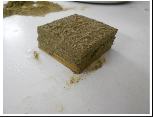
Şekil 4.8: 40 No'lu elek üstüne ait drenajsız koşulda kesilmiş numune
