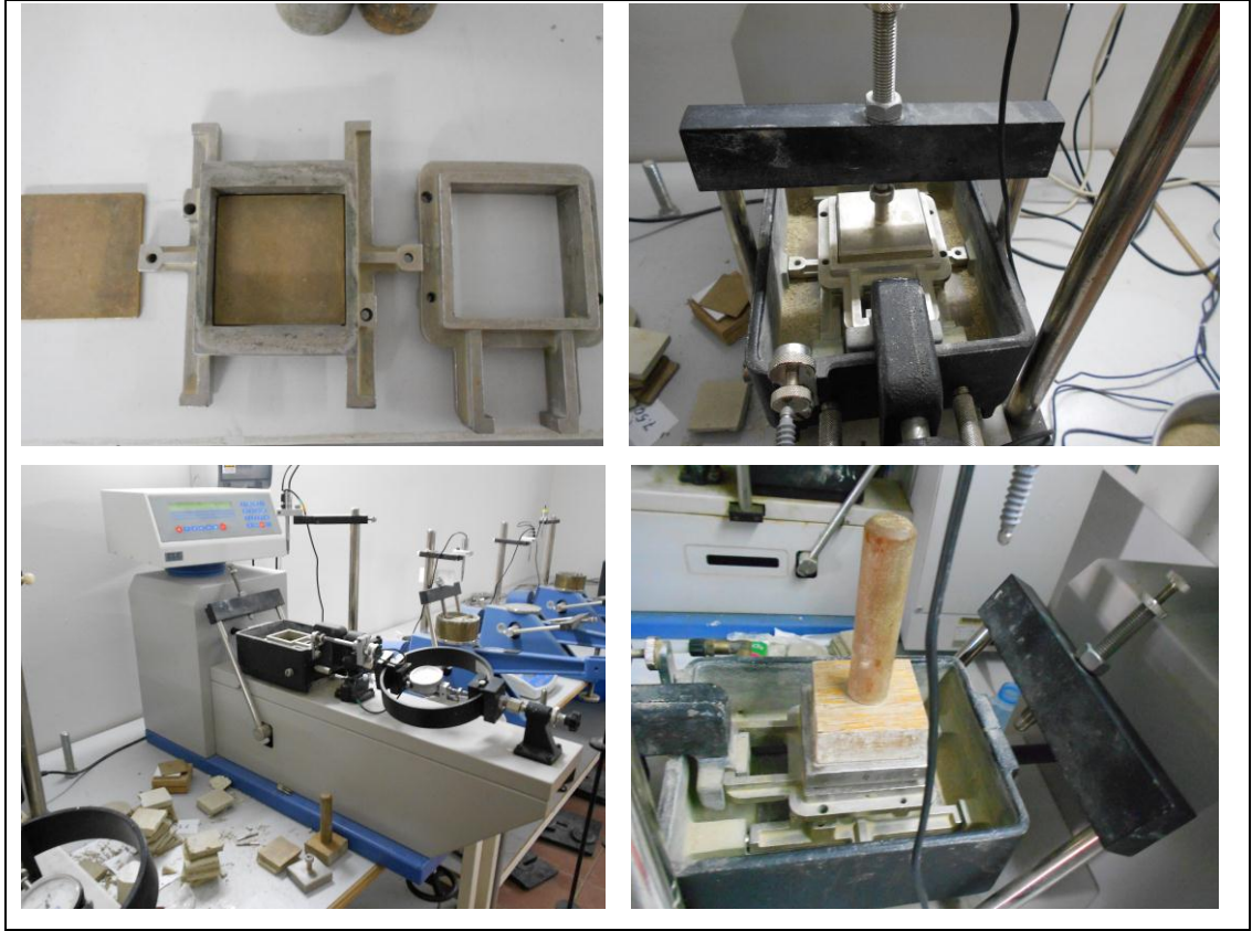
Şekil 3.3: Kare şekilli kesme kutusu ve deney aşamaları fotoğrafları
