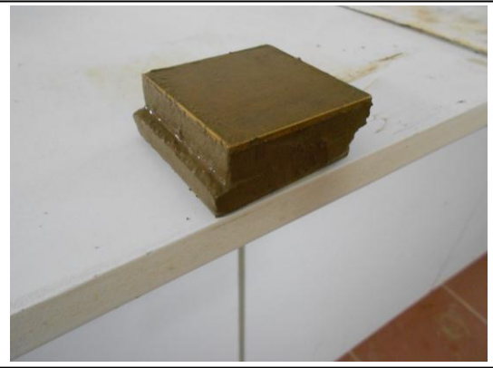
Şekil 4.6: Drenajsız koşulda kesilmiş kumlu kil örneği
