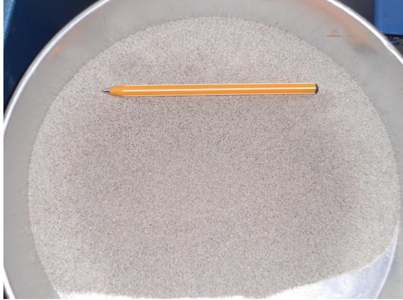
Şekil 4.9: Hem ıslak hem kuru elek yapılmış 200 No'lu elek üstündeki kalan kum örneği
