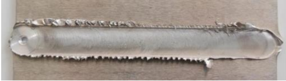
Şekil 8.2: 600 rpm 300 mm.min -1 kaynak parametresi üst yüzey görünümü.
