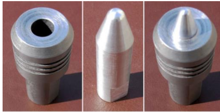
Şekil 4.10: D-SKK işleminde kullanılan bir takımın fotoğrafı a) Çelik omuz, b) Alüminyum alaşımı birleştirme ucu, c) Birleştirilmiş takım (Huang ve diğ. 2011).
