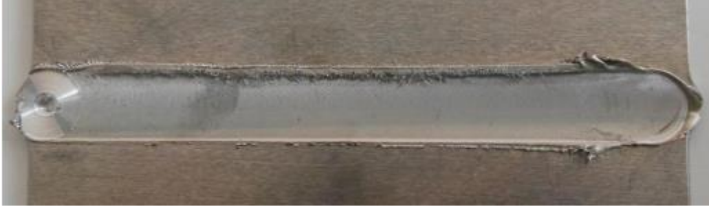
Şekil 8.5: 1250 rpm 600 mm.min -1 kaynak parametresi üst yüzey görünümü.
