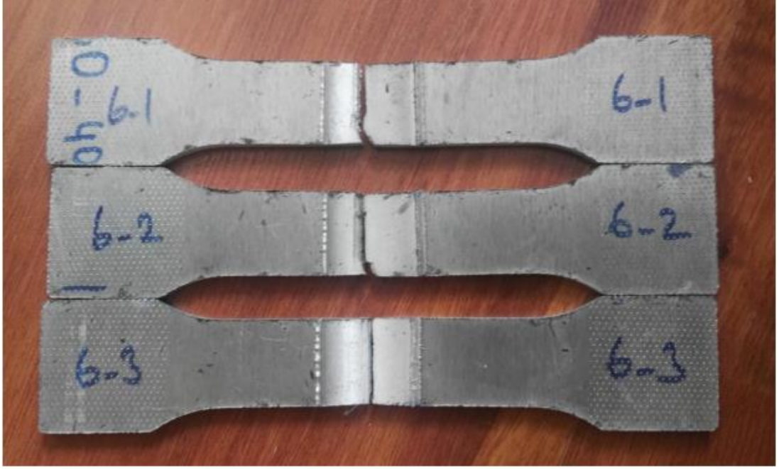
Şekil 8.12: 1250 rpm 400 mm.min -1 parametresinde birleştirilmiş numunelerin çekme deneyi sonrası fotoğrafı.
