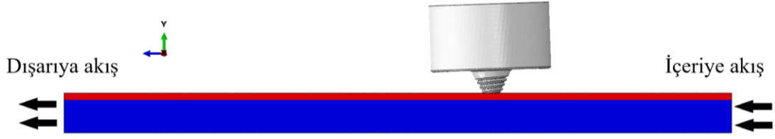
Şekil 7.13: Sayısal modeldeki malzeme akışı.
