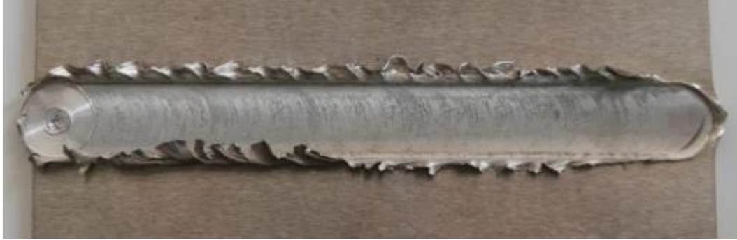
Şekil 8.9: 1600 rpm 400 mm.min -1 kaynak parametresi üst yüzey görünümü.
