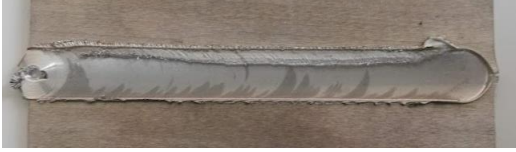
Şekil 8.4: 1000 rpm 500 mm.min -1 kaynak parametresi üst yüzey görünümü.
