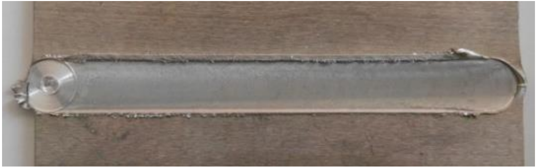
Şekil 8.7: 1250 rpm 400 mm.min -1 kaynak parametresi üst yüzey görünümü.
