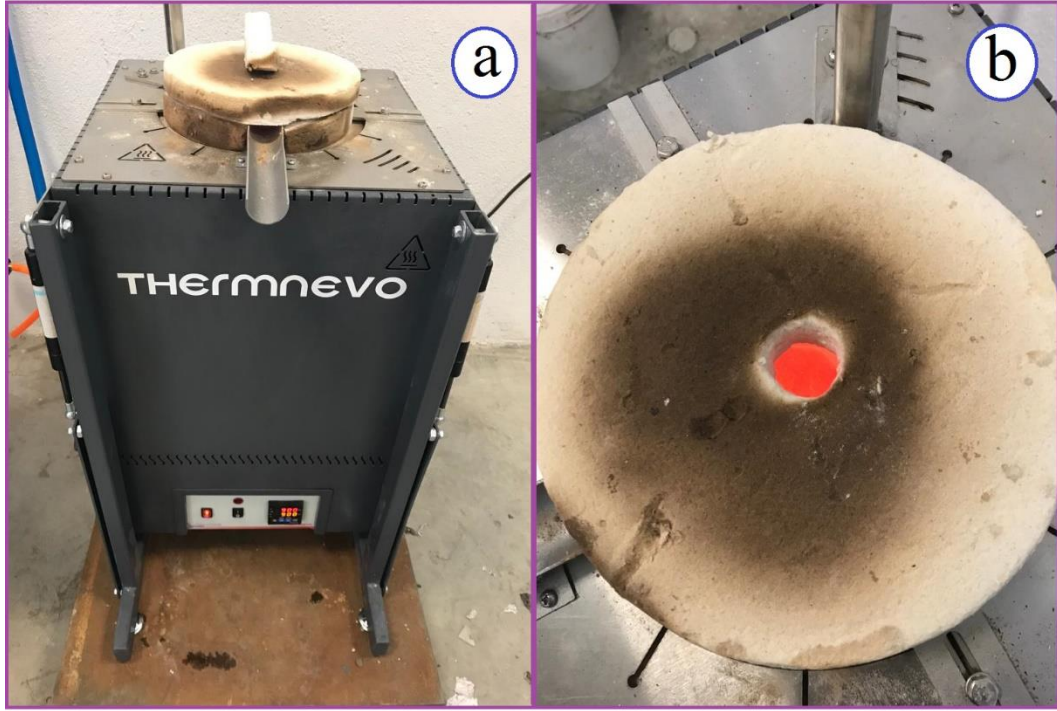
Şekil 4.6. (a) Sıvı matris metalini ergetmek için kullanılan 1200°C'ye çıkabilen mini ergitme fırını, (b) İnfiltrasyon işlemi için ergitilmiş sıvı matris metali
