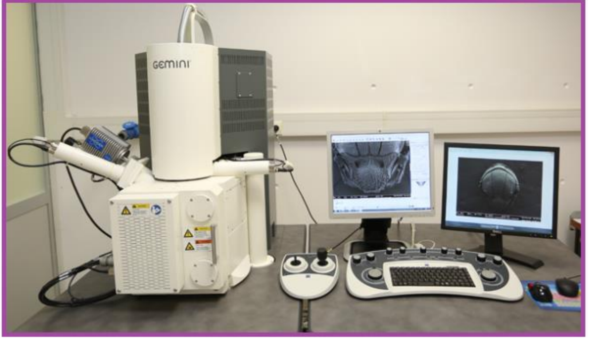
Şekil 4.15. FESEM, EDS cihazı
