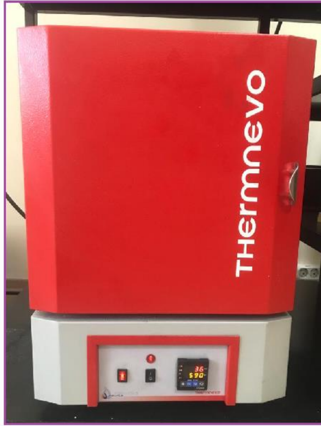
Şekil 4.10.Çözündürme ısı işlem fırını
