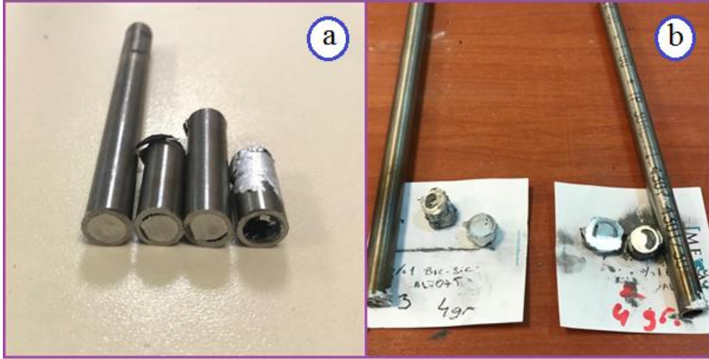
Şekil 4.3. Vakum infiltrasyon işlemi sonrası üretilen numuneler (a) Islatmanın tam sağlanmadığı numuneler, (b) İnfiltrasyon işleminin tamamen başarısız olduğu numuneler
