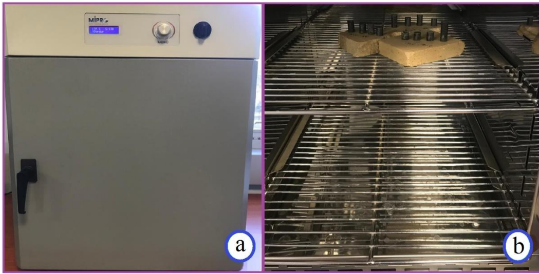
Şekil 4.11. (a)Yaşlandırma işlemi için kullanılan etüv fırını, (b) Üretilen hibrit kompozitlerin fırın içerisine yerleşimi
