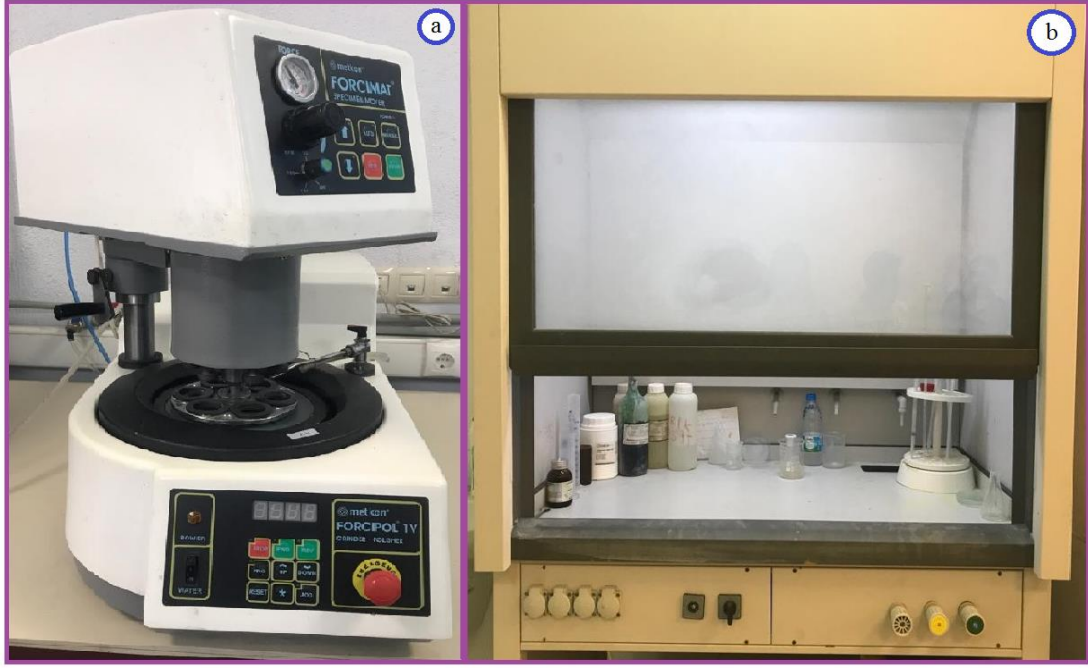
Şekil 4.13. (a) Otomatik zımparalama ve parlatma cihazı, (b) Dağlayıcının hazırlandığı çeker ocak
