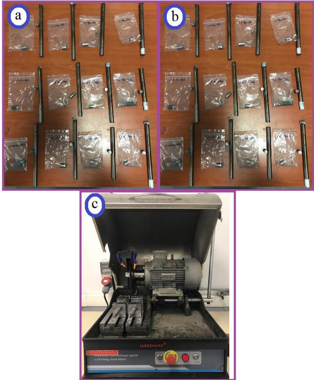
Şekil 4.8.(a) Al2024 matrisli hibrit kompozitler, (b) Al7075 hibrit kompozitlerin kesme sonrası görüntüleri, (c) Hassas kesme cihazı
