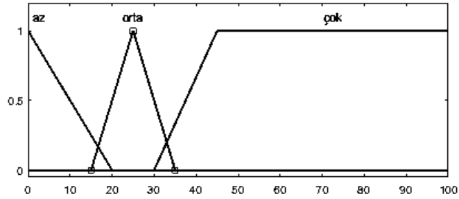
Şekil 6.7: İki parmaklı top kavraması için robotik el başparmak giriş üyelik fonksiyonları.
