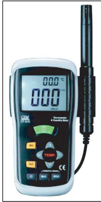
Şekil 6.36 : CEM DT 615 marka nem ve sıcaklık ölçer
