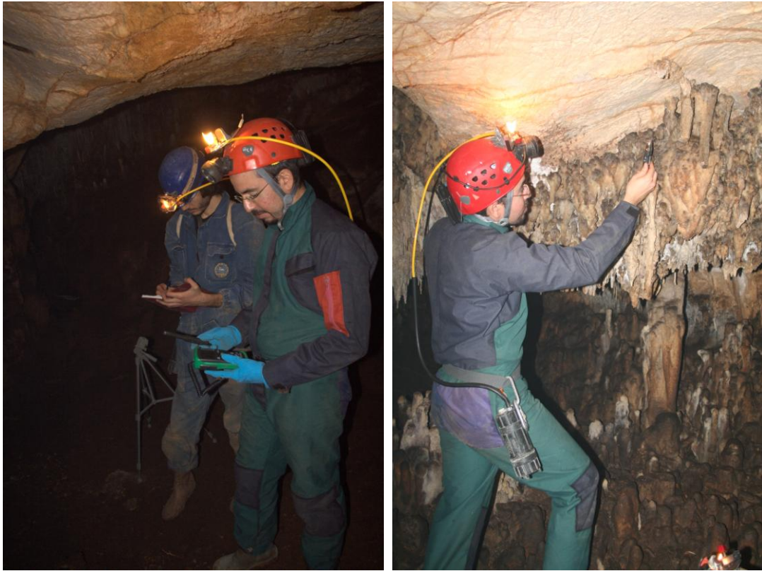
Şekil 6.3 : Sırtlanini Mağarası'na nem kayıt ölçüm cihazlarının yerleştirilmesi ve yerinde nem ve sıcaklık ölçümü
