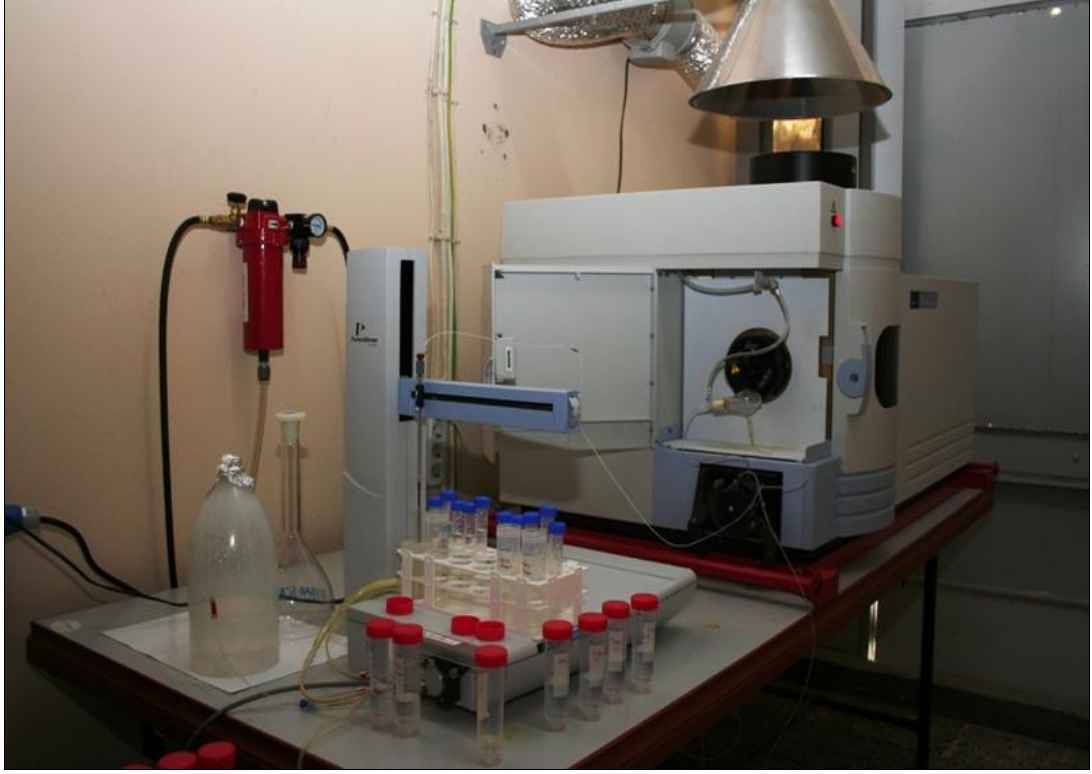
Şekil 6.33 : Pamukkale niversitesi, evre ve Su Kimyası Laboratuvarında bulunan ICP-OES cihazı.
