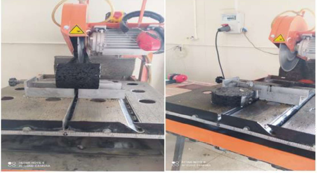
Şekil 4.15: Asfalt kesme makinesi ile kesilen numuneler
