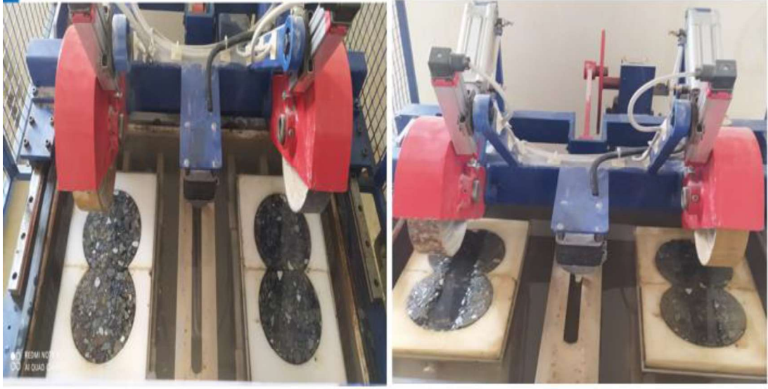
Şekil 4.18: H.T.İ.D. öncesi ve sonrası numunelerin durumu
