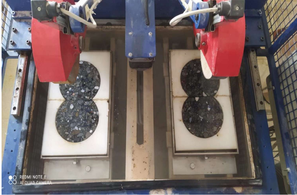
Şekil 4.17: Kalıplara konulan numunelerin Hamburg cihazına yerleştirilmesi
