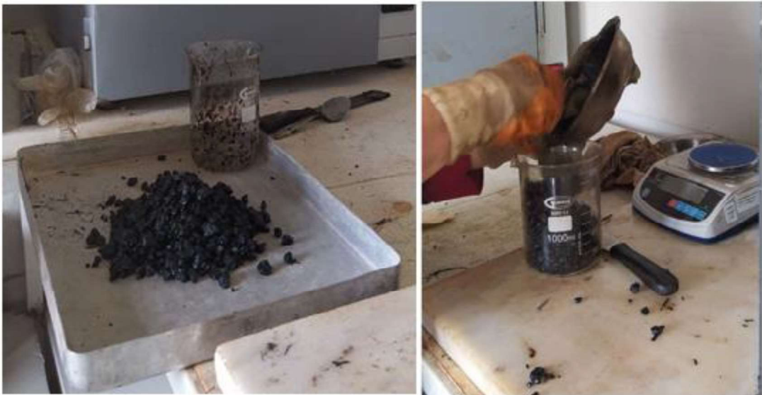
Şekil 4.3: Bitüm süzülme deneyi
