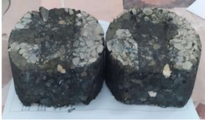
Şekil 4.20: Test numunelerinde oluşan tekerlek izi derinliği
